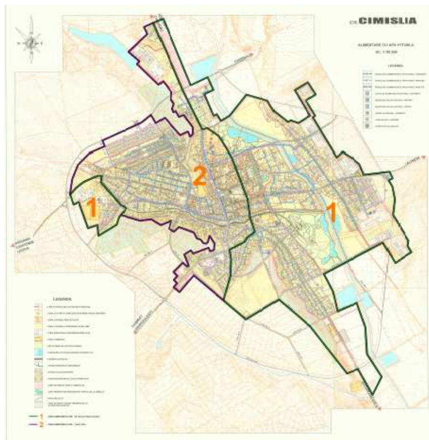
Figura 4. Harta orașului cu repartizarea gestiunii sistemului de alimentare cu apă și de canalizare
