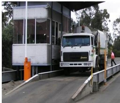
войти на полигон, должны пройти через зону контроля для взвешивания грузов на весах с подъемным мостом и сделать визуальный контроль груза. После процесса взвешивания, оператор даст от весов с подъемным мостом водителю копию билета со следующей минимальной информацией:
