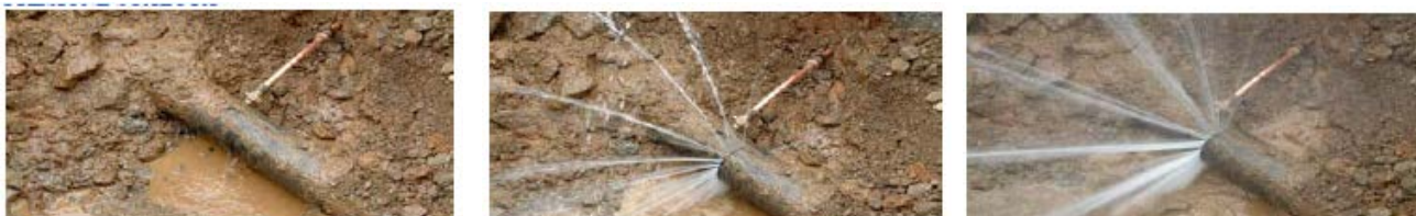
Imaginea 14. Pierderi de apă în condiții de: a) presiune joasă; b) de presiune medie; c) de presiune mare
