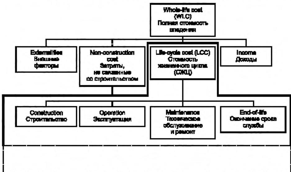
Настоящий стандарт объединяет позиции «Эксплуатация», «Техническое обслуживание и ремонт» ( $C_m$ ) и «Влияние на окружающую среду» ( $C_{env}$ ) в единую группу затрат «Сумма эксплуатационных затрат» (ЭКСПЛ).
