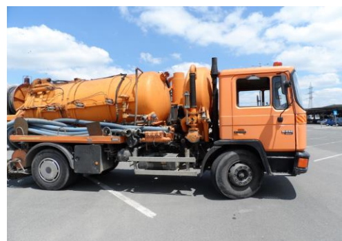
Fig. 26 Autospecială de curățare/vidanjare canalizări
