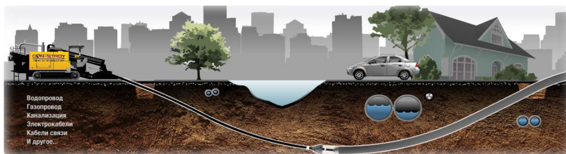
Fig. 135 Foraj orizontal direcționat
