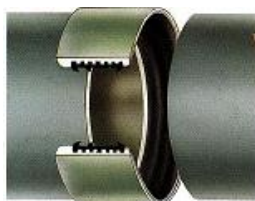
Fig. 58 Îmbinare cu piesa FWC - simetrică
