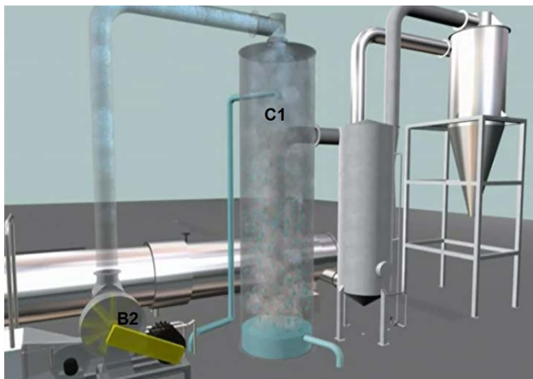
Figure 11. C1 – Condenser; B2 - Fan
