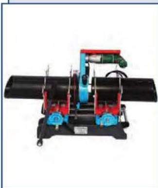
Предназначен для стыковой сварки напорных трубопроводов  $\varnothing$  40–160 мм (до PN 16), в т. ч. газопроводов, из полипропилена, полиэтилена и других термопластиков.
