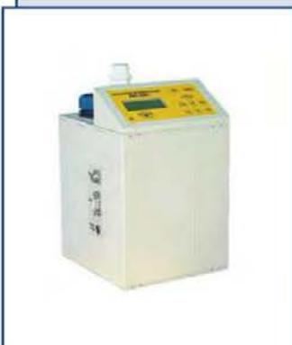
Анализатор “ВАКХ-2000С” предназначен для измерения массовой концентрации остаточного активного хлора в питьевой воде (например, на станциях водоподготовки), а также в воде плавательных бассейнов, аквапарков и т. п.
