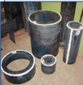
Металлические заглушки изоляции предназначены для установки на трубы и фасонные изделия в ППУ изоляции в полиэтиленовой и оцинкованной оболочке. Устанавливаются в местах прохода трубопроводов в ППУ через камеры, подвалы зданий, при объединении трубопроводов разной конструкции, а также в местах установки запорной арматуры и фасонных изделий (тройников, тройниковых ответвлений и пр.). Диаметр – от 125 до 1000 мм при L = 200 мм; от 125 до 1200 мм при L = 650 мм.
