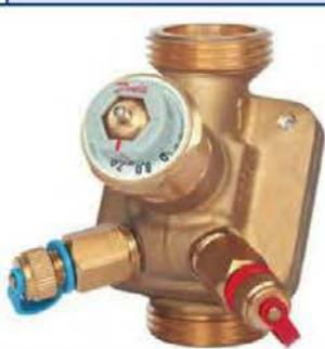
АВ-QM – автоматический балансировочный клапан, стабилизатор расхода; с электроприводом может применяться в качестве регулирующего клапана. Предназначен для ограничения и стабилизации расхода в системах с постоянными гидравлическими характеристиками в однотрубных системах отопления, а также для автоматической балансировки и регулирования в системах тепло- и холодоснабжения.
