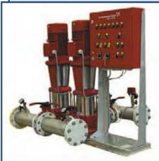
Области применения: спринклерные и дренчерные системы водяного и пенного пожаротушения, системы с гидрантами и пожарными кранами. Подача – до 260 м<sup>3</sup>/ч. Напор – до 145 м. Температура перекачиваемой жидкости – от 0 до +60 °С. Максимальное рабочее давление – 16 бар. Соответствует российским нормам и Техническому регламенту по системам пожарной безопасности.
