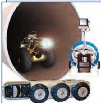
Комплект оборудования для телеинспекции трубопроводов производства CUES Inc (США) предназначен для телевизионной инспекции, восстановления и контроля профиля водопроводных труб, канализаций, ливневых водоотводов и промышленных линий с программным обеспечением для управления, контроля и обработки результирующей информации.
