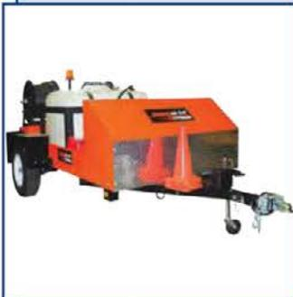
Водоструйные гидродинамические аппараты General Pipe Cleaners (США) для очистки труб. Области применения:
