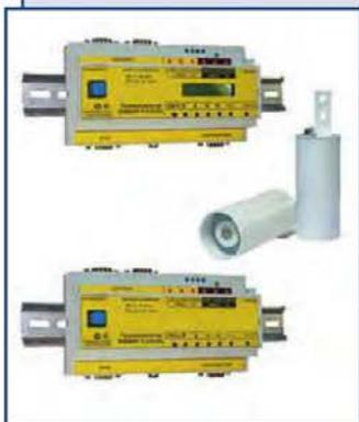
Стационарный прибор типа "Хоббит-Т-СО-СН4" обеспечивает контроль окиси углерода в соответствии с Инструкцией по контролю за содержанием окиси углерода в помещениях котельных РД 12-341-00. При использовании газового топлива обеспечивает контроль утечки метана и других взрывоопасных газов. Применяется в котельных любого типа.
