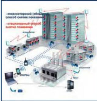
Инновационный продукт в сфере ЖКХ, основанный на современной технологии Wireless M-Bus (WMBUS): считывание показаний со счетчиков воды по радиоканалу, обеспечивающее качественный рост эффективности в обслуживании процессов теплоснабжающих и управляющих компаний.
