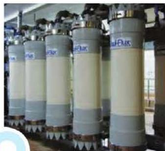
Мембранные модули ультраfiltrации Liqui-Flux®
