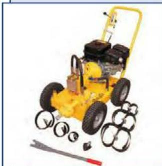
Секционная машина "модель 325" производства компании Electric Eel (США) предназначена для пробивки сложных засоров в трубах. Разработана для компаний, специализирующихся на устранении засоров в канализации, – водоканалов, аварийных служб и т. д.
