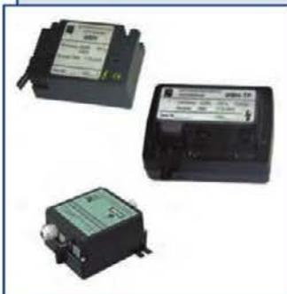
Источник высокого напряжения ИВН предназначен для искрового розжига газовых запальных горелок котельных агрегатов и служит для воспламенения топлива между электродом и корпусом установки. Рекомендуется для применения на запально-защитных устройствах  $L < 1000$  мм. Модификация на питание – 24 В. Схема преобразования частоты с 50/60 Гц до 20 кГц.
