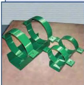
Опоры скользящие предназначены для защиты оболочки трубопровода от истирания в результате продольного перемещения трубы. Применяются в проходных каналах и при наземной прокладке трубопроводов различного назначения: тепловых сетей, газопроводов и нефтепроводов.
