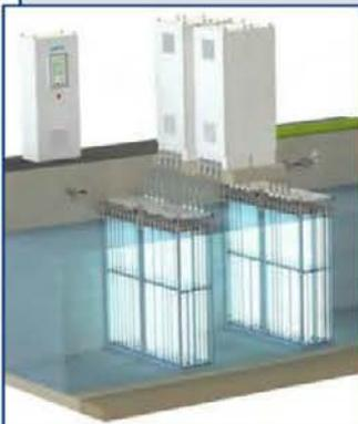
Канальная система для обеззараживания сточных вод на основе мощных амальгамных ламп (300–900 Вт), применяется на очистных сооружениях средней и большой производительности. Разработаны две серии оборудования для воды различного качества: G (пропускание воды  $\geq 50\%$ ) и F ( $< 50\%$ ).
