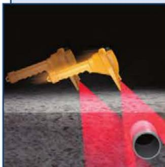
Прибор для поиска неметаллических подземных коммуникаций от компании SubSurface Instruments (США), способен обнаружить подземные объекты из любого материала и любой формы.
