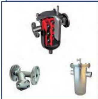
Шламоотводитель для очистки от механических примесей систем тепло- и водоснабжения. Материал корпуса – сталь 20, нержавеющая сталь. Фильтрующий элемент – сетки различной степени фильтрации с магнитными кольцами.
