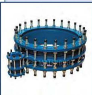
Литые монтажные вставки MATERBUD (Польша) предназначены для монтажных/демонтажных работ. Рабочее давление – PN 10 и PN 16. Диаметр – от 50 до 1200. Материал – высокопрочный чугун DN 50–1200 мм. Эпоксидное покрытие внутри и снаружи.
