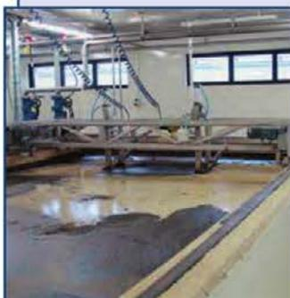
Флотационные установки созданы на основе принципа флотации с использованием растворенного воздуха. Воздух растворяется под давлением в специальном резервуаре и после подачи в зону флотации в растворенном виде генерирует большое количество микроскопических пузырьков, обладающих большой поверхностной
