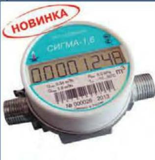
Бытовой малогабаритный струйно-акустический счетчик газа "СИГМА-1,6" с автоматической температурной компенсацией предназначен для измерения потребляемого объема газа в газопроводе низкого давления с приведением газа к нормальным условиям по температуре (+20 °С) в бытовом секторе жилищно-коммунального хозяйства.
