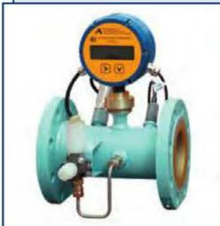
Счетчики газа турбинные СГТ16Э предназначены для измерения объема неагрессивного неоднородного по химическому составу природного газа, воздуха, азота и других неагрессивных газов с плотностью не менее 0,67 кг/м<sup>3</sup> с функцией пересчета измеренного объема к нормальным условиям по давлению и температуре. С учетом коэффициентов сжимаемости и химического состава газа имеется вариант исполнения без функций приведения к нормальным условиям.
