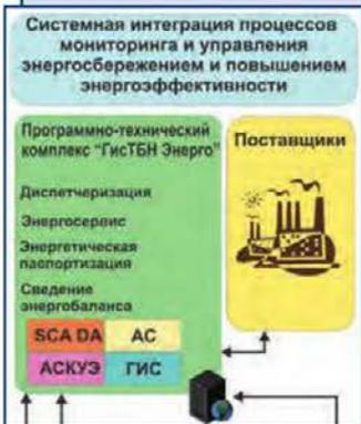
Проектирование и внедрение автоматизированных информационно-измерительных систем коммерческого учета энергоресурсов производителей, поставщиков и потребителей (АИИСКУЭ и АСКУЭ). Системы предназначены для автоматизации сбыта и контроля за режимами потребления энергоресурсов, в т. ч. за потреблением предприятий бюджетной сферы.
