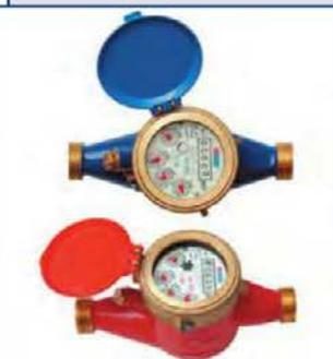
ВКХ предназначены для измерения объема холодной сетевой воды, протекающей по трубопроводу при температуре от 5 до 40 °С и рабочем давлении в водопроводной сети не более 1,0 МПа (10 кгс/см<sup>2</sup>).
