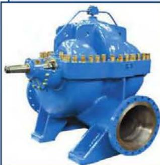
Предназначены для перекачивания воды и сходных с ней по вязкости и химической активности жидкостей (температура – до 120 °С; содержание механических примесей  $\leq 0,05\%$  по массе, размером  $\leq 0,2$  мм).
