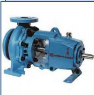
Центробежные одноступенчатые насосы с рабочим колесом Vortex серии ТСТ применяются для перекачки жидкостей, содержащих твердые включения или волокна, а также другие загрязненные и вязкие жидкости. Применяется рабочее колесо открытого типа. Жидкость перекачивается благодаря крутящему моменту самой крыльчатки, которая не вступает в прямой контакт с перекачиваемой жидкостью.
