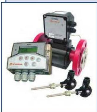
Теплосчетчик ТСК7 предназначен для учета, регистрации и дистанционного мониторинга теплотребления и параметров теплоносителя в двух закрытых и открытых системах водяного теплоснабжения, каждая из которых может содержать трубопроводы: подающий, обратный и ГВС, подпитки либо питьевой воды.
