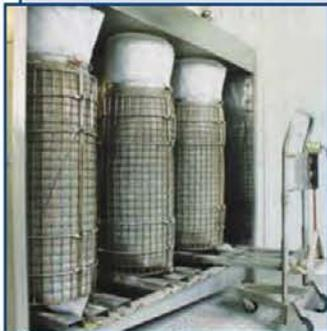
Иловые фильтры предназначены для обезвоживания и упаковки осадка, образующегося на очистных сооружениях, до 80% уровня влажности.
