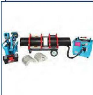
Предназначен для стыковой сварки напорных трубопроводов  $\varnothing$  75–250 мм (до PN 32), в т. ч. газопроводов, из полипропилена, полиэтилена и других термопластиков.
