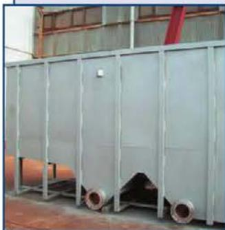
Предназначен для очистки стоков, содержащих нефтепродукты, масла, жиры, смолы, латекс и др. Представляет собой моноблочную установку из нержавеющей стали. В состав установки входят флотационная камера с погружным аэратором, осадочный бункер, тонкослойный блок и камера осветленной воды.
