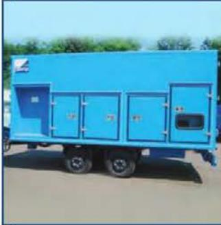
Прицепы предназначены для установки и транспортировки генераторных установок, теплогенераторов, дорожной и строительной техники.
