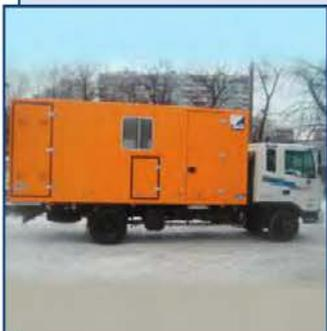
Автомобили аварийно-технической службы "МАВР" предназначены для выполнения работ и ликвидации аварий на объектах водоснабжения и канализации ЖКХ.
