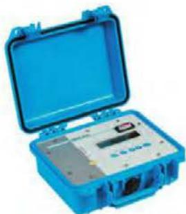
Легкий переносной ультразвуковой расходомер для точных измерений протока в трубопроводах. Измерения производятся на внешней стенке трубы без прямого контакта с водяным столбом. Исключаются вмешательства в водопроводную систему и перерывы в водоснабжении. Можно определять параметры насосов, проверять проток, либо проводить измерения нулевого расхода на участках труб.
