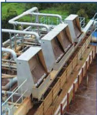
Оборудование компании REKO предназначено для удаления твердых частиц из сточной и технологической воды. Производительность – от 0 до 1500 м<sup>3</sup>/ч.
