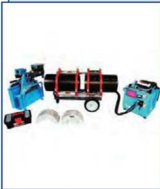
Предназначен для стыковой сварки напорных трубопроводов  $\varnothing$  90–315 мм (до PN 32), в т. ч. газопроводов, из полипропилена, полиэтилена и других термопластиков.
