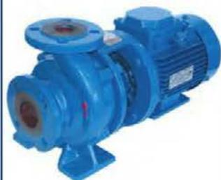
Предназначены для перекачивания чистой воды (кроме морской) (температура – от 0 до 85 °С (до 105 °С), рН – от 6 до 9) и других жидкостей, сходных с водой по плотности, вязкости и химической активности (содержание твердых включений ≤ 0,1% по массе, размером ≤ 0,2 мм).
