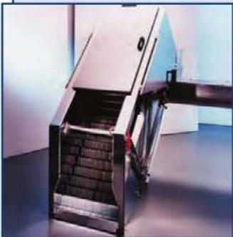
Решетки MEVA Rotoscreen, Monoscreen предназначены для полностью автоматизированного удаления твердых частиц из коммунальных и промышленных сточных вод.
