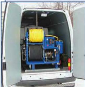
Компактные каналопромывочные машины VHT (Ван Хаут Текнолоджиз):
