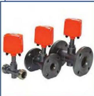
ВПС предназначен для преобразования расхода (объема) холодной или горячей воды, а также других жидкостей с удельной электропроводностью не менее  $2 \times 10^{-3}$  См/м в выходной импульсный электрический сигнал.
