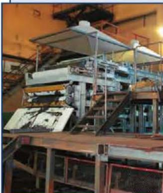
Производство ленточных фильтр-прессов типа ЛФ-П и в комплекте со сгустителем типа ЛФ-С производительностью от 1 до 100 м<sup>3</sup>/ч.
