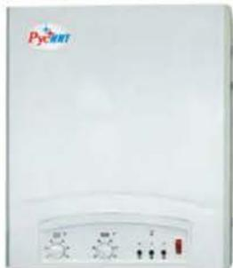
Электрокотлы "РусНИТ"-212НМ / 224НМ представляют моноблок со встроенным теплообменником из нержавеющей стали, циркуляционным насосом и блоком управления. Две группы ТЭНов позволяют осуществлять равномерную 3-ступенчатую регулировку по мощности без перекоса фаз.
