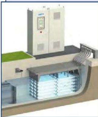
Оборудование предназначено для обеззараживания сточных вод в безнапорных системах водоотведения малой и средней производительности. Разработаны две серии оборудования для воды различного качества: серия G (пропускание воды  $\geq 50\%$ ) и серия F ( $< 50\%$ ).
