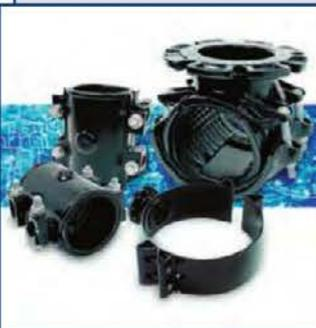
Фланцевый врезной хомут RingSeal предназначен для врезки в трубы из ПЭ, чугуна, стали. Конструкция позволяет произвести врезку в трубопровод без снятия давления в сети, с использованием специального оборудования, что позволяет существенно снизить время на монтаж. Корпус хомута полностью охватывает окружность трубы и не деформирует ее. DN от 100 до 1200.
