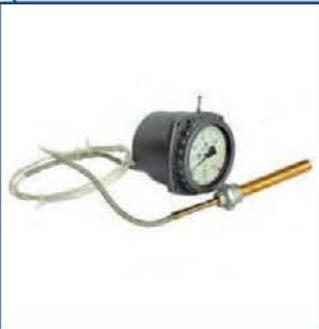
Термометр манометрический газовый электроконтактный предназначен для измерения температуры воды, масла и других жидкостей и управления внешними электрическими цепями нагревательных элементов или установок.
