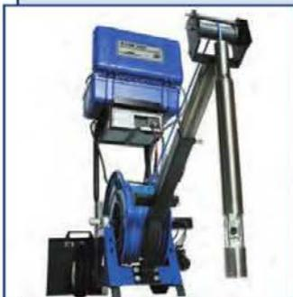
Телеинспекционное оборудование контроля скважин производства Laval Underground Surveys (США).
