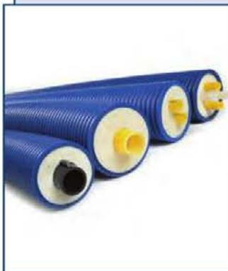
Трубы МИКРОФЛЕКС (Бельгия) предназначены для использования в наружных сетях отопления, водоснабжения и напорной канализации объектов ЖКХ, коммерческого строительства, частной застройки.
