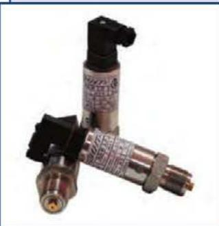
Датчики давления ИД предназначены для непрерывного преобразования значений разрежения, абсолютного, избыточного и гидростатического давления, разности давлений газов и жидкостей в унифицированный электрический выходной сигнал постоянного тока.
