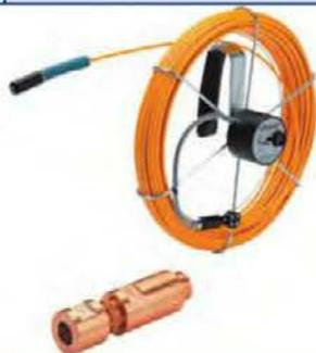
Стекловолоконный локационный кабель GOK A-10 с акустическим передатчиком предназначен для поиска утечек на полиэтиленовых трубопроводах (подведенных к строениям), в т. ч. на участках, осложненных наличием неизвестных трубопроводов или плохими акустическими условиями.
