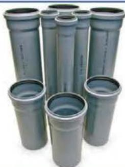
Широкий ассортимент труб из полипропилена для внутренней канализации номинальным диаметром 32, 50, 75, 90, 110, 125 и 160 мм. Применяются для отвода стоков во внутридомовой системе канализации. Укомплектованы двулепестковыми уплотнительными кольцами от немецкого производителя M.O.L.
