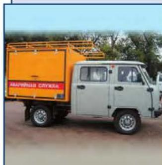
Автомобиль предназначен для выполнения работ и ликвидации аварий на объектах водоснабжения и канализации ЖКХ.
