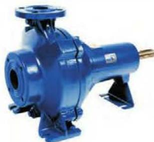
Горизонтально или вертикально устанавливаемый насос со спиральным корпусом, оснащенный свободновихревым (F), однолопастным (E) или многоканальным (K) либо диагональным однолопастным рабочим колесом (D), напорный фланец по стандартам DIN и ANSI. Исполнение по ATEX.
