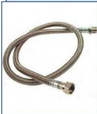
Используется как гибкий соединительный рукав для бытовых газовых приборов, отопительных котлов и другого оборудования, работающего по ГОСТ 5542-87 на газе или по ГОСТ 20448-90 и ГОСТ Р 52087-2003 на сжиженном газе. Представляет собой металлический шланг из нержавеющей стали AISI 316L сильфонного типа определенного размера. Толщина стенки шланга – более 0,21 мм согласно спецификации стандарта и документации завода-изготовителя.
