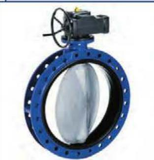
Центрический дисковый затвор с кольцевой вставкой из эластомера. С рычагом, редуктором, пневматическим, электрическим или гидравлическим приводом. Корпус с центрирующими дужками, U-образным корпусом с фланцами без выступающей кромки. Возможно одностороннее крепление к фланцу трубопровода и монтаж в качестве концевой арматуры с контрфланцем. Присоединения EN, ASME, JIS.
