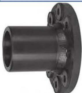
Бурт и фланец представляют цельное фланцевое изделие. Металлическая вставка во фланце для предотвращения явлений холодной текучести исключает случаи ухудшения прижатия прокладки к ответной части. Гарантирует отсутствие коррозии между фланцем и монтажными элементами – болтами и гайками.
