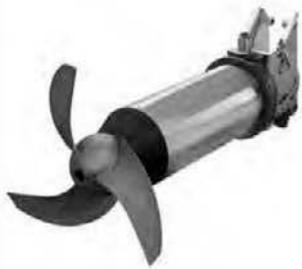
Горизонтальная погружная мешалка Amatrix с самоочищающимся пропеллером, в моноблочном исполнении, привод прямой или через редуктор. Исполнение по АTEX.
