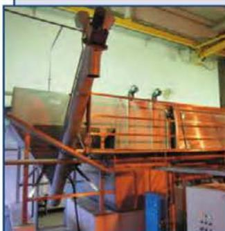
Предназначена для очистки ливневых сточных вод, стоков химического, мясного, рыбного, молочного, кондитерского производств, снижает показатели БПК, ХПК, взвешенных веществ, жиров, фосфатов. Производительность – от 20 до 120 м<sup>3</sup>/ч. Совмещенный вариант горизонтального флотатора с песколовкой. Включает донный шнек для удаления оседающих частиц.
