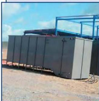
Обеспечивает очистку сточных вод до нормативов сброса в открытый водоем (взвешенные вещества – до 10 мг/л, БПК полн. – до 3 мг/л).
