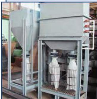
Станции обезвоживания мешочные COM1,2-500; -650 предназначены для обезвоживания осадков хозяйственно-бытовых сточных вод, промышленных сточных вод, водопроводных осадков, производственных шламов и т. п.
