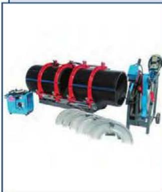
Предназначен для стыковой сварки напорных трубопроводов  $\varnothing$  315–630 мм (до PN 32), в т. ч. газопроводов, из полипропилена, полиэтилена и других термопластиков.
