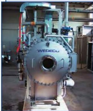
Генераторы озона серии PDA/PDO 1000–9500 применяются в системах водоподготовки питьевой воды высокой производительности, для обработки охлаждающей воды в системах охлаждения, а также для обработки сточной воды и т. д.
