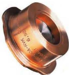
Зажимной обратный клапан BOA®-RVK применяется в промышленных установках и системах отопления, в системах водяного отопления, установках для переноса тепла, для жидкостей, газов и паров. Компактная конструкция, короткая строительная длина. Коррозионно-стойкая пружина из нержавеющей стали, при необходимости легко извлекается.
