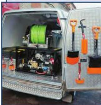
Водоструйные машины CamSpray (США) для прочистки канализации. Применяются для устранения засоров различной сложности – жир, ил, песок, промышленный мусор, а также для профилактической промывки сетей канализации.
