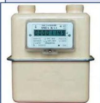
Счетчики газа объемные диафрагменные «Омега» с механическим термокорректором и «Омега ЭК» с электронным термокорректором предназначены для измерения потребляемого объема газа с приведением температуры газа к нормальным условиям (+20 °С).
