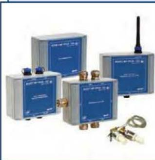
Измеряет средний объемный расход, объем реверсивных потоков воды и давления в трубопроводах диаметром до 1400 мм и передает измерительную, установочную, архивную информацию через сотовый модем или интерфейс RS-485.
