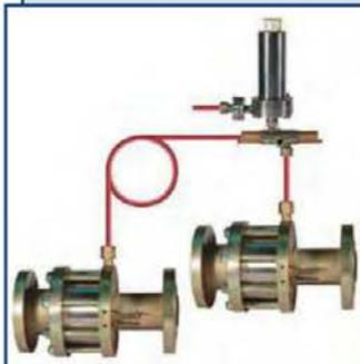
Арматура для защиты тепловых пунктов с присоединенными к ним местными системами потребителей тепла от аварийного повышения давления в обратном сетевом трубопроводе путем отсечки теплового пункта от сетевых трубопроводов – подающего и обратного, при превышении давления в обратном сетевом трубопроводе уставки срабатывания и автоматического возвращения системы в исходное состояние после устранения причины срабатывания.
