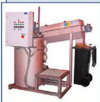
Установки для сгущения шламовых осадков сточных вод (мешковые сушилки) предназначены для обезвоживания всех типов осадков сточных вод. Не требуют много энергии и места.
