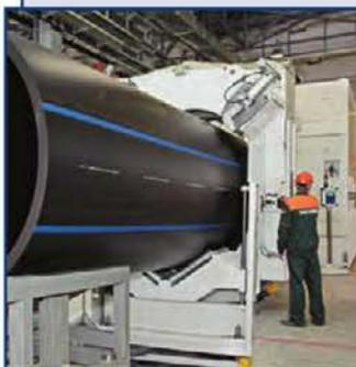
Впервые в России производство напорных полиэтиленовых труб диаметром 1400 и 1600 мм для водоснабжения и канализации на оборудовании немецкой компании battenfeld-cincinnati. Широкий диапазон типоразмеров: диаметры 800, 900, 1000, 1200, 1400, 1600 мм; SDR 9–33 в соответствии с ГОСТ 18599-2001 и ТУ. Изготовление полиэтиленовых труб с классом давления и толщиной стенки, выходящими за границы ГОСТа 18599-2001.
