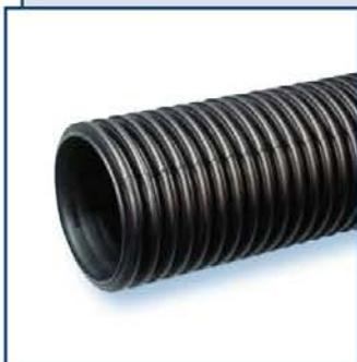
Трубы гофрированные двухслойные полиэтиленовые предназначены для наружной самотечной безнапорной канализации, систем дренажей, организации телефонной кабельной канализации. Производятся отрезками по 6 и 12 м, для их соединения используются муфты.
