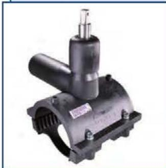
Седелка для врезки под давлением и многократного перекрытия потока среды для бесколодезной установки. Служит для врезки в действующие трубопроводы с давлением до 10 бар (газ) и 16 бар (вода) без утечек и образования стружки. Не требуется дополнительной изоляции. Имеет интегрированный сверло-резак с верхним и нижним упором, перемещающимся по металлической гильзе. Открытый нагревательный элемент для оптимальной теплопередачи.
