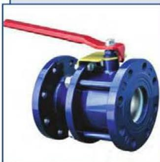
Разборная конструкция корпуса позволяет осуществлять ремонт и горячую замену основных деталей (уплотнений, шара и др.), тарельчатая пружина компенсирует износ уплотнительных элементов. DN 10–600 мм.
