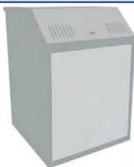
Бойлер косвенного нагрева отлично дополняет котлы серии КОВ мощностью 30; 37,5; 45; 63 кВт. Объем – 110 л. Максимальное рабочее давление – 6 Па. Максимальная мощность змеевика – 28 кВт. Время нагрева воды до температуры +50 °С – 17 мин. Производство ГВС – 960 л/час.
