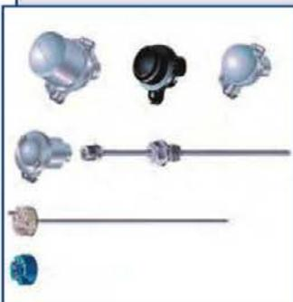
Ввинчивающийся термометр сопротивления предназначен для измерения температуры жидких и газообразных сред, обеспечивает герметичность при вакуумметрическом и избыточном давлении. Датчики 902002 и 902030 состоят из защитной арматуры, соединенной с соединительной головкой, и сменной измерительной вставки, которая может также оснащаться нормирующим преобразователем.
