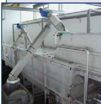
Комбинированные установки для механической очистки HUBER ROTAMAT® (Германия) включают:
