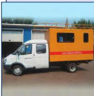
Автомобили предназначены для выполнения работ и ликвидации аварий на объектах водоснабжения и канализации ЖКХ.
