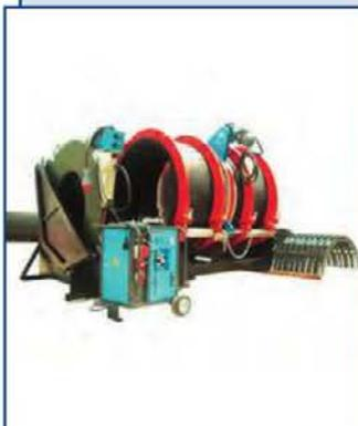
Предназначен для стыковой сварки напорных трубопроводов Ø 1200–1600 мм (до PN 32), в т. ч. газопроводов, из полипропилена, полиэтилена и других термопластиков.
