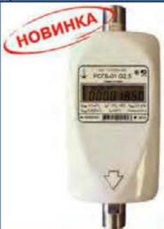
Бытовые ультразвуковые расходомеры – счетчики газа с автоматической температурной компенсацией РСГБ-01 типоразмеров G1,6, G2,5, G4 предназначены для измерения потребляемого объема газа в газопроводе низкого давления с приведением газа к нормальным условиям по температуре (+20 °С) в бытовом секторе ЖКХ.
