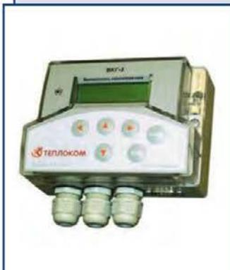
Вычислители ВКГ-ЗТ предназначены для измерений объема газа, приведенного к стандартным условиям, при контроле и учете, в т. ч. коммерческом, потребления природного газа в различных отраслях промышленности. Обеспечиваются измерения по одному или двум трубопроводам.
