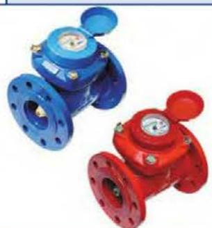
ВТХ (турбинные) предназначены для измерения объема холодной сетевой воды, протекающей по трубопроводу при температуре от 5 до 40 °С и рабочем давлении в водопроводной сети не более 1,6 МПа (16 кгс/см<sup>2</sup>).
