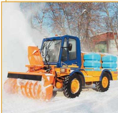
Многофункциональная машина ММД1 предназначена для зимней уборки дорог при помощи навесного шнекороторного снегоочистителя и очистки дорожных ограждений с помощью щеточного оборудования.
