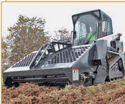
Грабли для обустройства парков и садов предназначены для подготовки почвы под посевы и посадки, удаления камней и мусора размером до 2 см. Захватывают камни диаметром 19 мм и более, а также сгребают большую часть камней диаметром 13 мм.
