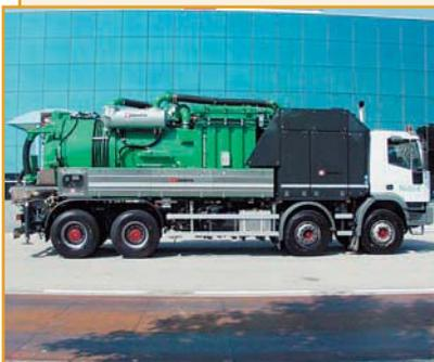
Вакуумные погрузчики MORO предназначены для перемещении сыпучих, дробленых, жидких и полужидких, а также других материалов, в том числе угля, угольной пыли и строительных отходов.
