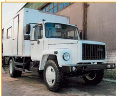
Передвижные авторемонтные мастерские ПАРМ предназначены для выполнения широкого перечня работ (слесарномеханических, газорезательных, токарных и сварочных) по ремонту и восстановлению автотракторной спецтехники, а также для проведения планового технического обслуживания раз-
