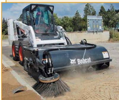
Подметальная щетка с бункером предназначена для подметания, сбора и вывоза мусора, песка и грязи. Подметает и собирает мусор одним непрерывным движением. Для подавления пыли может поставляться комплект водооросительного оборудования.
