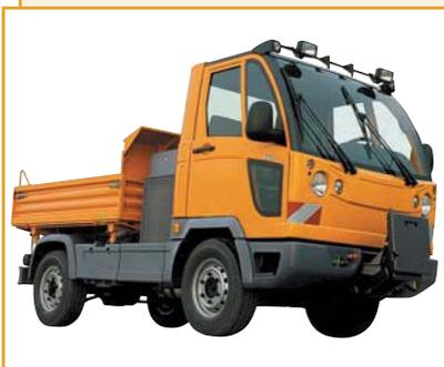
Многофункциональные машины Multicar (Германия) с различным навесным оборудованием применяются для решения различных задач по содержанию городских, дворовых и садово-парковых территорий, а также для осуществления строительных и аварийно-ремонтных работ.
