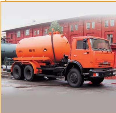
Машины ассенизационные МК-10, МК-4 предназначены для механизированного заполнения, транспортирования и выгрузки самотеком жидких отходов, не содержащих горючих и взрывоопасных веществ.
