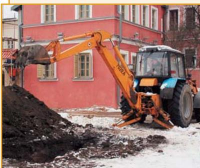
Экскаваторы-погрузчики АМКОДОР 702ЕА, АМКОДОР 702ЕА-01, АМКОДОР 702ЕМ-03 и экскаваторы АМКОДОР 702ЕВМ-01, АМКОДОР 702ЕВ, АМКОДОР 702ЕВ-02 созданы на базе трактора Беларус-92П.
