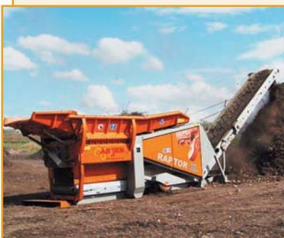
Машина мобильная для измельчения мусора ARJES RAPTOR XL предназначена для переработки бытового и промышленного мусора, биомассы, шин и др.
