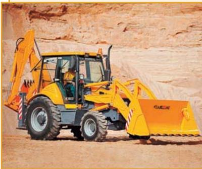
Экскаватор-погрузчик ДЭМ-310 предназначен для выполнения экскавационных и погрузочно-разгрузочных работ.
