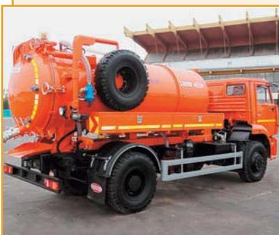
Машина илососная ТКМ-621 с оборудованием KATMERCILER предназначена для обслуживания ливневой канализационной сети и используется для очистки колодцев ливневой канализации, отстойников от слежавшегося осадка. Шасси – КамАЗ-53605. Объем цистерны – 5–7 м<sup>3</sup>. Вакуумный насос – 650–1400 м<sup>3</sup>/ч. Насос высокого давления – 2,4 м<sup>3</sup>/ч.
