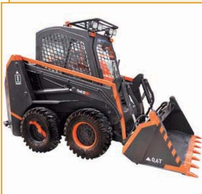
Погрузчик малогабаритный с бортовым поворотом ПмК-6.02 предназначен для механизации погрузочно-разгрузочных работ с грунтом I–IV категорий, сыпучими и мелкокусковыми материалами как в обычных, так и в стесненных условиях; транспортно-складских работ со штучными грузами; специальных работ (бурение скважин, очистка от снега и грязи дорог и тротуаров и др.).
