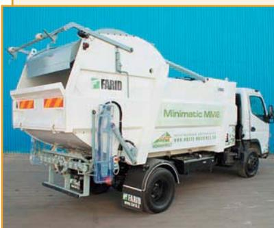
Малотоннажный мусоровоз с задней загрузкой предназначен для механизированного и ручного сбора твердых бытовых отходов и транспортирования их к местам утилизации, а также перегрузки в мусоровозы серии T1 и Super. Уплотнение отходов осуществляется при помощи прессующей и вы-
