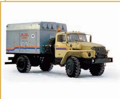
Моторный подогреватель на шасси автомобиля "Урал-43206-41"/"Урал-4320-41".
