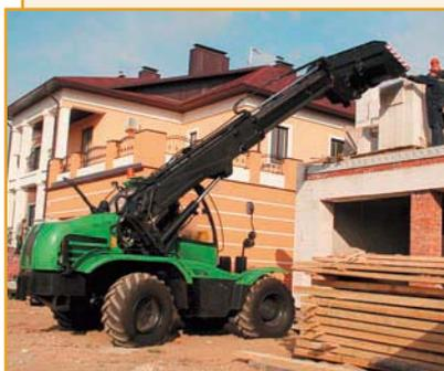
Погрузчик с телескопической стрелой АМКОДОР 527 предназначен для выполнения погрузочно-разгрузочных работ с сыпучими и кусковыми материалами, штучными грузами, объемными грузами (лен, солома, сено), а также для монтажных работ.
