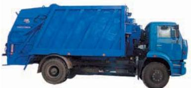
Базовое шасси – MA3-5337A2/КамАЗ-53605.
