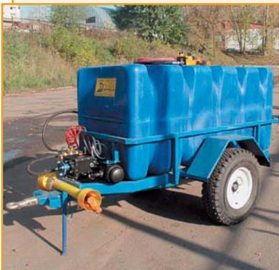
Трактор “Беларус-320” в комплектации с прицепом ПККД-20 обеспечивает эффективную мойку дорог, тротуаров, проездов дворовых территорий и придорожных сооружений, а также поливку газонов и зеленых насаждений. Мойка под высоким давлением позволяет значительно сократить расход воды, а также увеличить время работы техники на линии.
