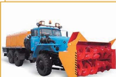
Шнекороторный снегоочиститель КО-650У предназначен для очистки от снега автомагистралей и взлетно-посадочных полос, а также для отбрасывания снежных валов, образованных другими снегоочистителями.
