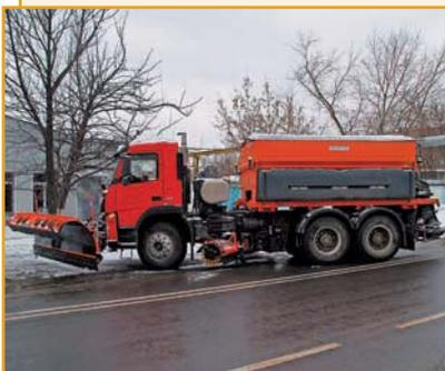
Дорожная машина ЭД-700 предназначена для всесезонного обслуживания скоростных автомагистралей с твердым покрытием. Базовое шасси – VOLVO FM, MERCEDES BENZ, IVECO.
