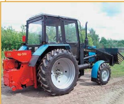
Фреза дорожная ФД-500 на базе трактора МТЗ-82 предназначена для холодного фрезерования асфальтовых покрытий при ремонте.
