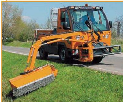
Машины Multicar (Германия) применяются для уборки парковых территорий, выкашивания откосов и газонов, вакуумного сбора скошенной травы, борьбы с дикорастущими травами и кустарником, поливки зеленых насаждений.
