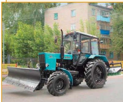
Высокопроизводительная коммунальная уборочная машина МК-Е с плужно-щеточным оборудованием предназначена для уборки проезжей части улиц, площадей, дорог и тротуаров с твердым покрытием от мусора и очистки от свежевыпавшего снега, а также для планировки неслежавшегося (рыхлого) грунта и засыпки им траншей и ям.
