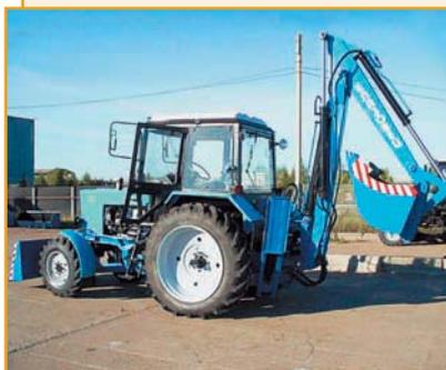
Высокопроизводительный экскаватор-бульдозер ЭО-2621Е с бульдозерным отвалом предназначен для рытья котлованов и траншей в грунтах I–IV категорий и выполнения планировочных работ.
