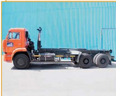
Автомобиль с крюковым погрузчиком предназначен для механизированных погрузочно-разгрузочных работ со сменными кузовами (контейнеры для ТБО, КГО, лома, быстросменного навесного оборудования различных назначений) и их транспортирования.
