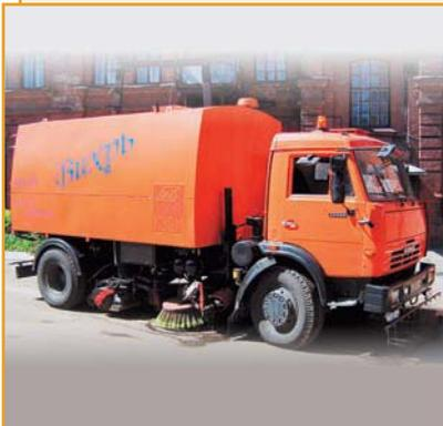
Машина вакуумная подметально-уборочная КО-318А предназначена для механизированной уборки городских дорог, площадей, аэропортов с асфальтовым или цементобетонным покрытием от пыли, песка, щебня, листьев. Выполняет полный комплекс работ от подметания и загрузки смета в бункер до самосвальной выгрузки в местах утилизации.
