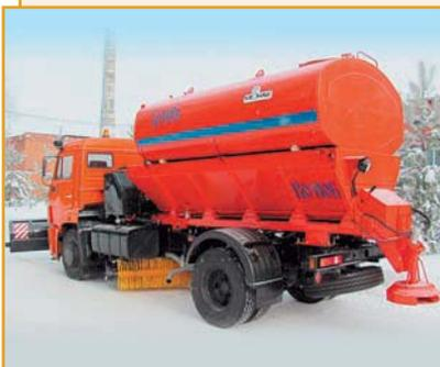
Поливочные машины для мойки и поливки дорожных покрытий, прилотовой полосы, поливки зеленых насаждений, а также в качестве дополнительного средства при тушении пожаров.
