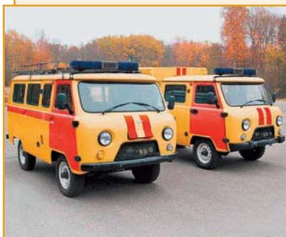
Аварийно-газовая машина АГМ-У предназначена для предупреждения и устранения аварий в системах газоснабжения, оперативной доставки специалистов к месту утечки газа, ликвидации аварий и неисправностей в системе газоснабжения с применением технических средств.
