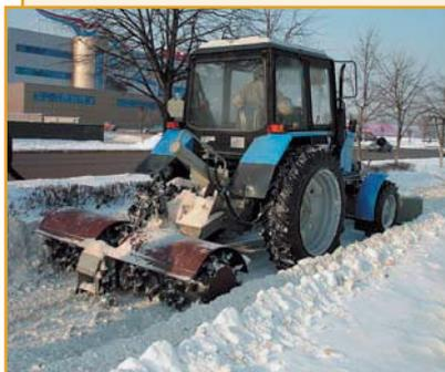
Предназначена для уборки дорог от ледяного покрытия.
