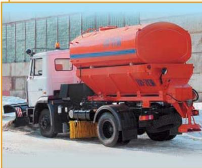
Комбинированные машины круглогодичного использования для содержания городских дорог с твердым покрытием (поливомоечное, плужное, щеточное, распределяющее оборудование).
