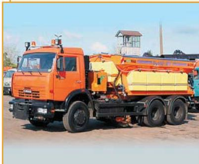
Пескоразбрасыватели для сметания мусора и снегоочистки городских дорог с усовершенствованным покрытием, а также для посыпки инертными материалами или антигололедными реагентами поверхности дорожного полотна.
