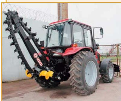
Экскаватор цепной универсальный ЭЦУ-150ГР предназначен для прокладки газо- и водопроводов, сетей канализации, связи и электропередачи и позволяет производить быструю смену режущего органа для получения траншей разной ширины. Используется на разных категориях грунта.
