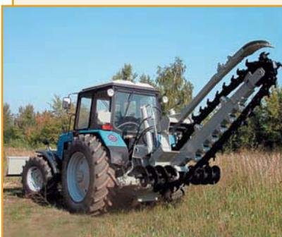
Экскаватор траншейный цепной ЭТЦ-201 с механическим приводом и ЭТЦ-201 Г с гидравлическим приводом рабочего органа, с бульдозерным оборудованием на базе трактора МТЗ-1221 предназначен для рытья в грунтах I–III категорий траншей прямоугольного сечения под кабельные линии связи, линии электропередач и трубопроводы различного назначения.
