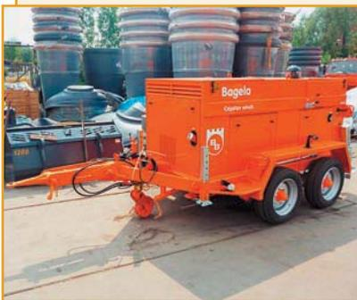
Гидравлическая тяговая лебедка предназначена для прокладки кабеля и ПЭ-труб.
