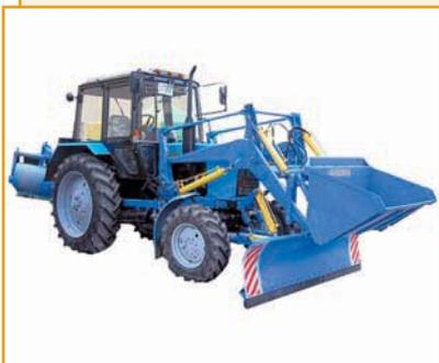
Машины уборочные универсальные КО-812-1, КО-707-1 предназначены для очистки улиц, дорог, тротуаров, строительных площадок и других участков от мусора, снега, песчаных наносов методом сгребания и погрузки в транспортные средства.
