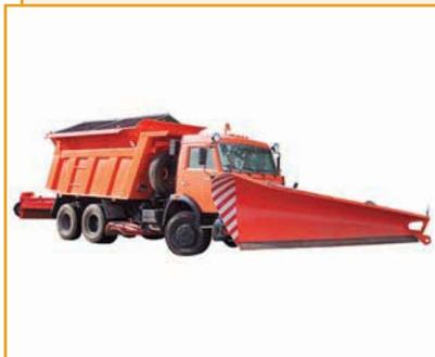
Универсальная комбинированная дорожная машина ДМК-70 предназначена для зимнего и летнего содержания автодорог, а также для перевозки сыпучих и прочих грузов.
