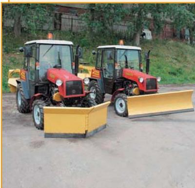
Машина коммунальная комбинированная МКК-10 на базе трактора “Беларус-320” (сборка объединения “Дормаш”) предназначена для круглогодичного содержания внутридворовых территорий и прочих объектов, имеющих ограниченное пространство.
