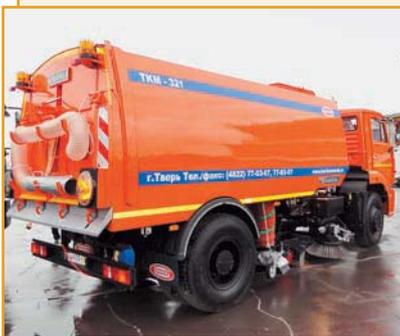
Вакуумные подметально-уборочные машины ТКМ-321 с оборудованием Erdemli makina (на базе КамАЗ-53605) предназначены для качественной уборки городских дорог, улиц, автострад, площадей и т. п. от пыли, песка, щебня, листьев и другого мусора с увлажнением подметаемой поверхности и вывозом смета в места его выгрузки.
