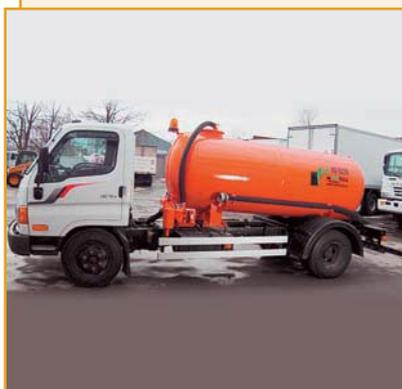
Вакуумная машина на базе шасси Hyundai HD 78 предназначена для очистки выгребных ям и транспортировки жидких отходов.
