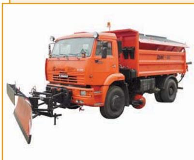
Универсальная комбинированная дорожная машина ДМК-65 предназначена для зимнего и летнего содержания автодорог, а также для перевозки сыпучих и прочих грузов.
