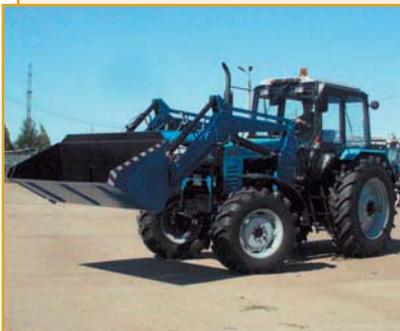
Погрузчик фронтальный предназначен для погрузки различных грузов (сыпучих строительных грузов, лесоматериалов, сена, соломы, навоза, минеральных удобрений, песка и т. п.) в транспортные средства, смесительные установки и машины для внесения удобрений, для механизации внутрискладских работ с затаренными и незатаренными минеральными удобрениями, для перевозки
