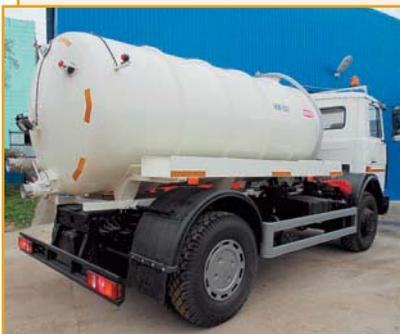
Машина вакуумная ТKM-632 на шасси МАЗ-5337 предназначена для вакуумной загрузки, транспортирования к месту утилизации и выгрузки жидких отходов, не содержащих горючих и взрывоопасных веществ.
