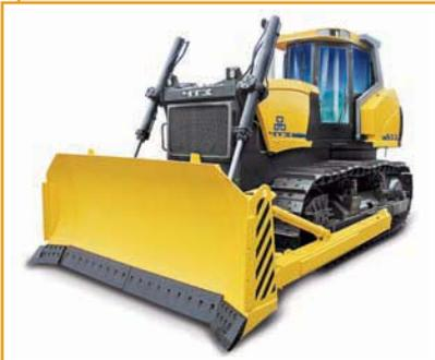
Бульдозер Б11 (класс 10) выполнен с применением новых конструкторско-технологических решений. Гидромеханическая трансмиссия с планетарным бортовым редуктором и вынесенной осью прокатки тележек гусениц обеспечивает увеличенный ресурс
