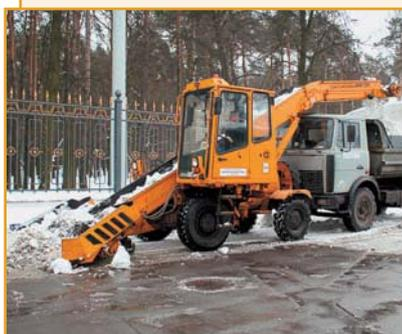
Машины погрузочные универсальные АМКОДОР 37 и АМКОДОР 37-01 предназначены для погрузки в транспортные средства свежевыпавшего, уплотненного снега и сколотого льда, предварительно собранных в валы и кучи, а также для других работ с помощью сменных рабочих органов.
