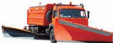
Комбинированные дорожные машины КО-829С1 КО-829С3 предназначены для всесезонного содержания городских и магистральных автомобильных дорог. В летний период машина используется в качестве самосвала. В зимний период машина используется для скоростной и патрульной снегоочистки, удаления наледи, распределения противогололедных материалов, в т. ч. увлажненных и жидких реагентов, а также для очистки дорожного полотна щеточным оборудованием.
