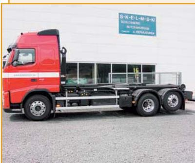
Автомобиль с крюковым погрузчиком предназначен для механизированных погрузочно-разгрузочных работ со сменными кузовами (контейнеры для ТБО, КГО, лома, быстростроенного навесного оборудования различных назначений) и их транспортирования.
