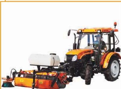
Подметально-уборочные машины PRONAR AGATA (Польша) предназначены для уборки территорий с твердым покрытием: дорог и тротуаров, площадей, парков.
