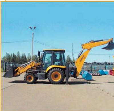
Экскаваторы-погрузчики "СUKUROVA – ЕлАЗ" 883/885/888 оснащены телескопной стрелой, челюстным ковшом вместимостью 1,1 м<sup>3</sup>, гидроразводкой под различные гидравлическое навесное оборудование (гидромолот, вибратор, бур и др.), ковшами обратной лопаты шириной 400, 600, 800 мм и др.
