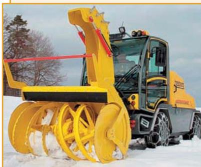
Специальный компактный маневренный самоходный фрезерно-роторный снегоочиститель BOSCHUNG B4 для работы в стесненных условиях, метания/погрузки снега в грузовики на городских улицах, тротуарах, в парках.
