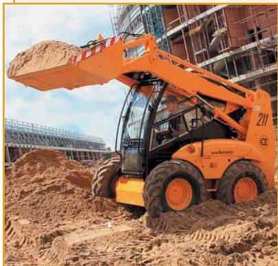
Погрузчик с бортовым поворотом АМКОДОР 211 предназначен для механизации погрузочно-разгрузочных и выполнения землеройно-транспортных работ на грунтах I и II категории, складских работ со штабелируемыми грузами, очистки дорог от мусора и снега, ухода за территориями, а также для выполнения различных специальных и вспомогательных работ.
