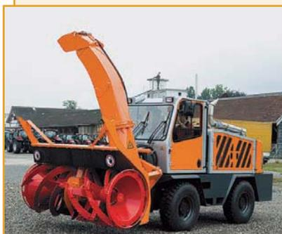
Мощный фрезерно-роторный снегоочиститель ZAUGG Rolba 1500 предназначен для уборки перевалов и территорий аэродромов.
