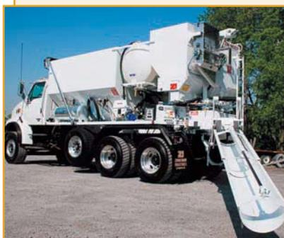
Мобильные бетоносмесительные установки Zimmerman Inc. производства США предназначены для производства различных бетонных смесей и растворов. Имеют уникальный цепной питатель с раздельной подачей инертных материалов, обеспечивающий точность дозирования. Максимальный срок службы питателя – до 3 лет. Производительность установки – от 22,5 до 45,0 м<sup>3</sup>
