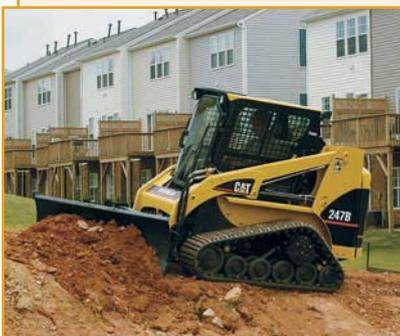
Двигатель – четырехтактный четырехцилиндровый безнаддувный водноохлаждаемый дизельный 3024C T компании CATERPILLAR.
