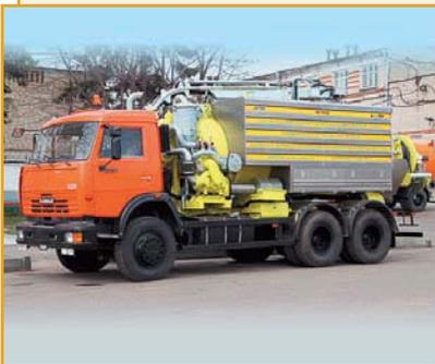
Комбинированные машины с илососным и каналопромывочным оборудованием для профилактической санитарной очистки колодцев и трубопроводов городской ливневой канализации от ила, грунтовых наносов и других загрязнений, а также ликвидации в них аварийных засоров.
