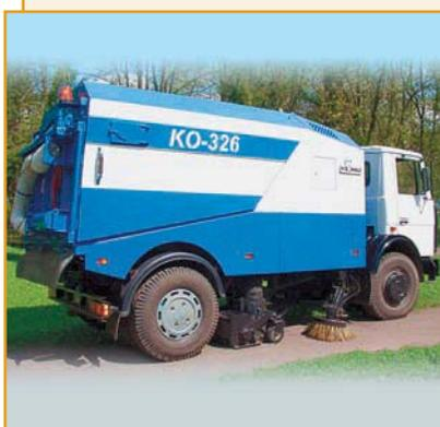
Машины подметально-уборочные вакуумные КО-326 предназначены для очистки городских дорог с твердым покрытием от мусора, подметания улиц, вакуумной загрузки смета в бункер-мусоросборник, вывоза и самосвальной выгрузки смета в местах утилизации.
