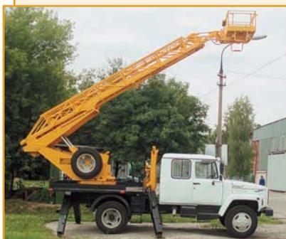
Автоподъемники локтевые и телескопические для подъема людей на высоту при выполнении ими различных строительных, ремонтных и монтажных работ.
