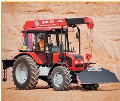
Кран-манипулятор телескопический ДЭМ-151 UNIC на базе трактора "Беларус" предназначен для проведения погрузочно-разгрузочных работ в условиях бездорожья, строительно-монтажных и других работ на высоте до 12 м, транспортировки грузов в агрегатируемом прицепе, выполнения земляных и планировочных работ в небольших объемах.
