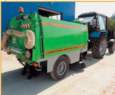
Применяется для очистки проезжей и пешеходной части городских улиц, площадей от пыли, листьев, мусора, песка, щебня, кусков асфальта после фрезерования с увлажнением подметаемой поверхности и вывозом собранного мусора в места его выгрузки.
