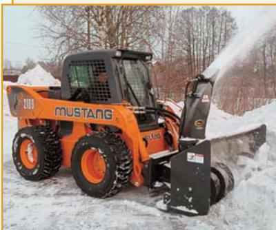
Универсальный мини-погрузчик Mustang-2109 (США) со снегометателем шнеко-роторного типа.
