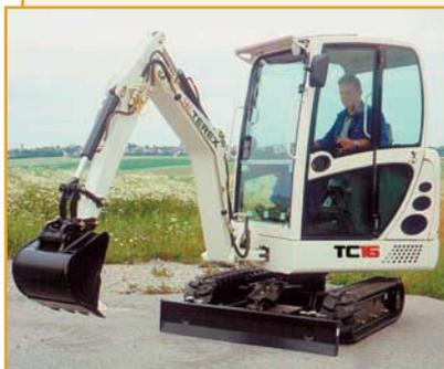
Мини-экскаватор Terex-TC 16 (Германия) незаменим в городском хозяйстве. Компактен, используется в стесненных городских условиях, на узких старинных улочках. Оказывает низкое давление на грунт, имеет быстрый цикл землеройных работ.
