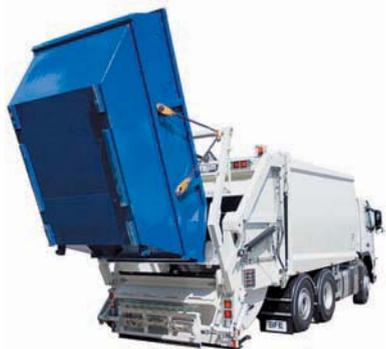
Мощные мусоровозы BFE серии HD (Швеция) с уникальной конструкцией пресс-плиты предназначены для сбора и транспортировки как твердых бытовых отходов, так и крупногабаритного мусора.
