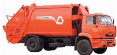
Мусоровозы с задней загрузкой КО-440В, КО-440ВМ, КО-440В1, КО-440В1-01, КО-440ВГ предназначены для механизированного сбора твердых бытовых отходов из металлических и пластмассовых контейнеров всех типов объемом до 1,1 м<sup>3</sup>, их уплотнения, транспортирования и механизированной выгрузки в местах утилизации.
