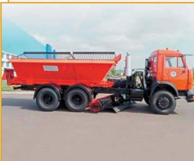
Универсальная дорожная машина УДМ-80Е предназначена для круглогодичного содержания автомобильных дорог с твердым покрытием: очистки дорожного полотна и обочин от снега; подметания; распределения твердых и жидких противогололедных материалов; мойки и поливки дорожных покрытий, элементов обустройства автомобильных
