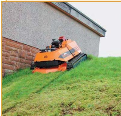
Малогобаритная самоходная машина Robo Flail one с высокой маневренностью и проходимостью для окоса травостоя и ликвидации древесно-кустарниковой растительности в труднодоступных местах: на откосах глубоких выемок, в местах со слабыми грунтами, заболоченных местностях, на полосах отвода автомобильных и железных дорог.
