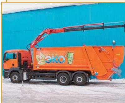
Большегрузный мусоровоз с задней загрузкой предназначен для механизированного сбора твердых бытовых отходов из заглобленных контейнеров и транспортирования их к местам утилизации.
