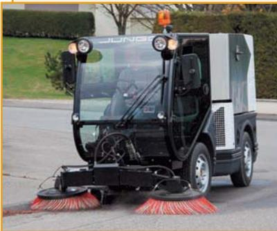
Многофункциональная коммунальная машина City Ranger (JUNGO JET) 3500 (Германия) предназначена для круглогодичного содержания дорог, тротуаров, площадей и открытых общественных зон (автомобильных парковок и др.). Сочлененная рама обеспечивает превосходную маневренность и максимальную производительность.
