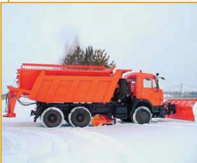
Универсальная дорожная машина УДМ-80ЕС на шасси КАМАЗ 65115 предназначена для круглогодичного ухода за автодорогами с твердым покрытием: очистки дорожного полотна передним поворотным отвалом и сметания щеткой одновременно, распределения жидких и твердых противогололедных материалов, поливки и мойки.
