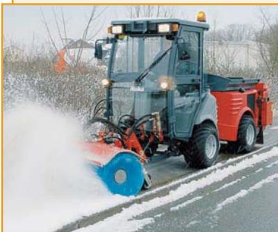
Вакуумные подметальные машины Hako-Citymaster (Германия) применяются для эффективной уборки снега с дорожного покрытия при помощи щетки или отвала.
