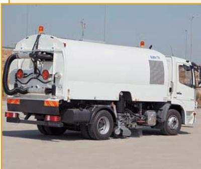
Вакуумные подметально-уборочные машины ТКМ-322 с оборудованием KATMERCILER (на базе КамАЗ-53605) предназначены для качественной уборки городских дорог, улиц, автострад, площадей и т. п. от пыли, песка, щебня, листьев и другого мусора с увлажнением подметаемой поверхности и вывозом смета в места его выгрузки.
