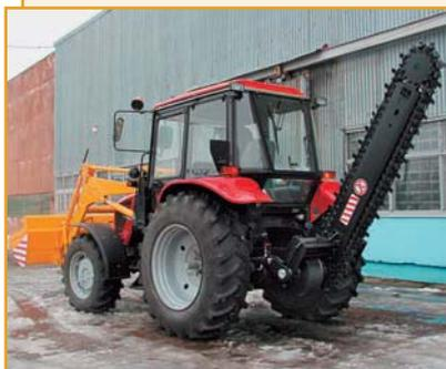
Экскаватор цепной универсальный ЭЦУ-150ГР предназначен для прокладки газо- и водопроводов, сетей канализации, связи и электропередачи в твердых и мерзлых грунтах, планировочных и земляных работ.
