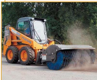
Универсальный мини-погрузчик Mustang-2054 (США) с подметальной щеткой. Компактен, легко проходит по узким тротуарам и не создает помех при уборке в любое время года. Где нет доступа тракторам, там доминирует мини-погрузчик Mustang-2054. Дизельный двигатель – Yanmar (Япония). Объем двигателя – 2,2 л.
