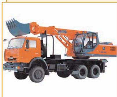
Экскаватор-планировщик ТЭП-18 оснащен телескопической стрелой.
