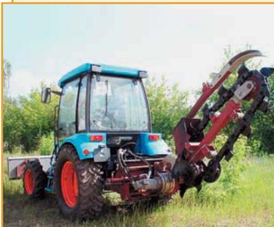
Экскаватор траншейный цепной ЭТЦ-121 на базе малогабаритного трактора "Агромаш 60ТК" предназначен для рытья и засыпки траншей прямоугольного профиля в грунтах I–III категорий, а также мерзлых грунтах.
