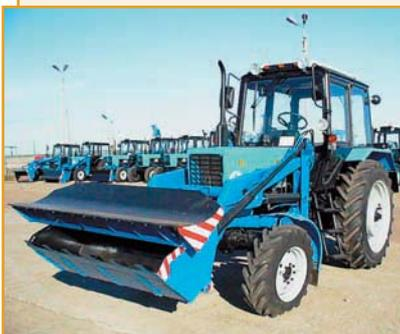
Высокопроизводительный погрузчик ПК-10Е предназначен для погрузки сыпучих и мелкокусковых материалов, мусора и очистки проезжей части улиц, площадей, дорог и тротуаров с твердым покрытием от свежевыпавшего снега и мусора.
