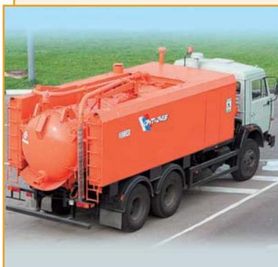
Комбинированные машины совмещают каналопромывочное и илососное оборудование, что позволяет производить аварийную и профилактическую прочистку канализационных и водосточных сетей высоконапорной мойкой и откачкой загрязнений.
