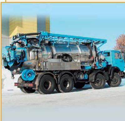
Комбинированные каналоочистительные машины предназначены для аварийной и профилактической прочистки канализационных и водосточных труб, отстойников, колодцев, водоприемников и вывоза загрязнений. Возможна эксплуатация в зимний период.
