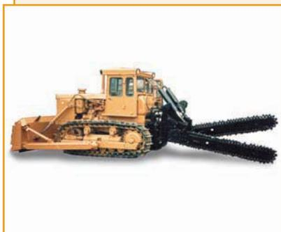
Траншеекопатели БР-01, БР-01-300, БР-00 предназначены для прорезания щелей в мерзлых и твердых грунтах IV-V категорий. Базовый трактор – Т-10 (Т-170) (гусеничный).
