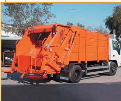
Мусоровоз ТКМ-480 с задней загрузкой KATMERCILER предназначен для механизированной погрузки твердых бытовых отходов, их уплотнения, транспортирования и механизированной выгрузки.
