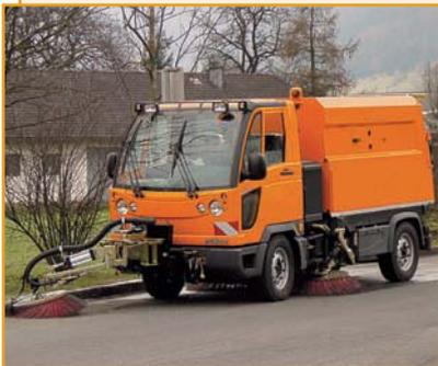
Многофункциональные универсальные машины Multicar (Германия) комплектуются мощным и эффективным вакуумным подметальным оборудованием.
