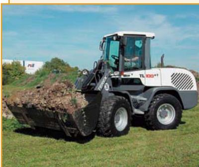
Фронтальный погрузчик TEREX-TL100 (Германия) шарнирно-сочлененного типа с эргономичным дизайном. Отличается высокой маневренностью и повышенной износостойкостью шин, экономичностью двигателя и высокой производительностью.
