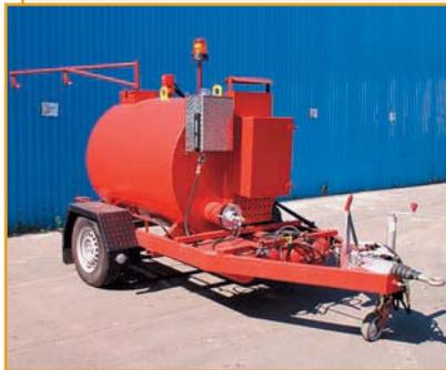
Заливщик швов ЭД-235М предназначен для приема, поддержания рабочей температуры и розлива горячих герметизирующих материалов в швы и трещины дорожных покрытий, грунтовки карт при производстве ремонтных работ.
