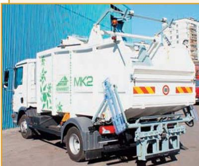
Среднетоннажный мусоровоз с задней загрузкой предназначен для механизированного и ручного сбора твердых бытовых отходов и транспортирования их к местам утилизации, а также перегрузки в мусоровозы серии T1 и Super. Уплотнение отходов осуществляется при помощи прессующей и вы-
