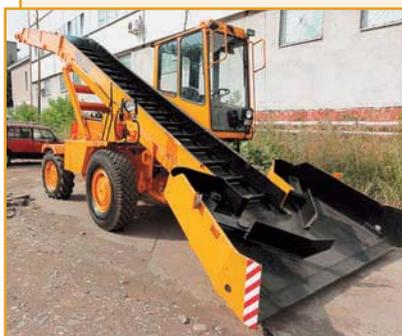
Снегопогрузчик ТКМ-237-02 с лаповым питателем и цепным транспортером предназначен для погрузки в транспортные средства свежевыпавшего, уплотненного снега и сколотого льда через кабину или задний борт. Регулируемая рулевая колонка. Подогрев сиденья водителя. Предпусковой подогреватель. Трансмиссия гидрообъемная. Привод рабочих органов – гидравлический.
