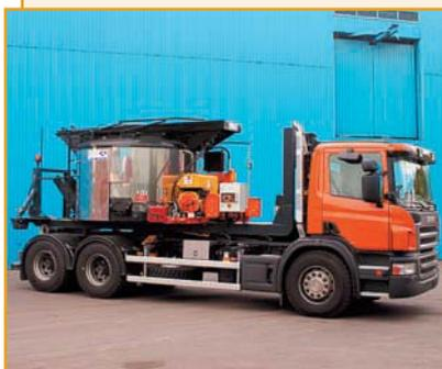
Машина МРД-5944 предназначена для ремонта дорог литым асфальтобетоном. Имеет вертикальный цилиндр с вертикальной мешалкой и гидравлическим приводом через приводную цепь. Полная изоляция. Обогрев дизельной горелкой. Загрузочное устройство смонтировано сзади. Привод агрегатов от автономного двигателя. Вместимость бункера – не менее 5000 л, масса перевозимого материала – не менее 12 т. Соответствует требованиям ГОСТов и ТУ.
