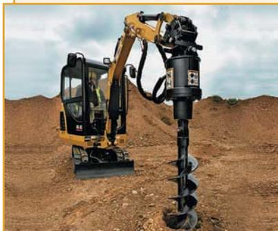
Гусеничная база – около 1390 мм. Максимальная габаритная высота – 3709 мм, длина с опущенным на землю ковшом – 3690 мм, высота до верха кабины – 2190 мм.
