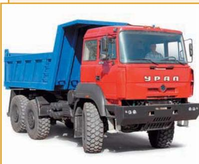
Автомобиль-самосвал на шасси «Урал-6370» с колесной формулой 6 × 6.
