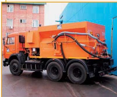
Машина для ремонта дорог пневмонабрызгом и струйно-инъекционным методом. Шасси – КАМАЗ-65115. Автономный двигатель HATZ. Объем кузова для щебня – 4–8 м³. Два шнековых транспортера для подачи щебня. Емкость для эмульсии – 1200–1800 л. Радиус работы – 4500 мм.
