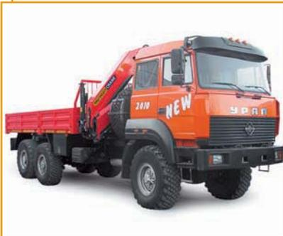
Бортовой автомобиль с КМУ Palfinger-15500A на шасси "Урал 4320-3951-58 с КМУ".
