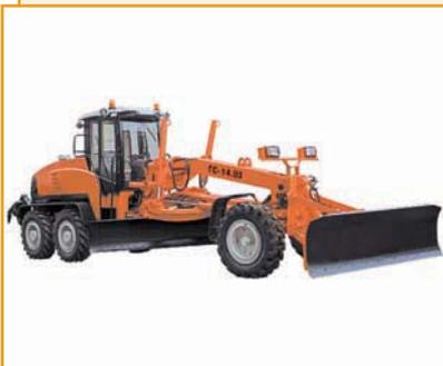
Автогрейдер ГС-14.03 (класс 140) применяется в строительстве, при содержании дорог, работает на грунтах I–III категорий.
