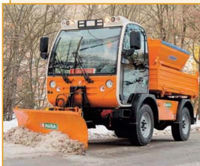
Многофункциональные коммунальные машины AUSA (Испания) и City Ranger (JUNGO JET) 3500 (Германия) предназначены для круглогодичного содержания дорог, тротуаров, площадей и открытых общественных зон (автомобильных парковок и др.).
