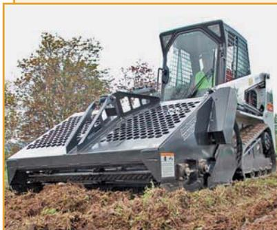
Грабли для обустройства парков и садов предназначены для подготовки почвы под посевы и посадки, удаления камней и мусора размером до 2 см. Захватывают камни диаметром 19 мм и более, а также сребают большую часть камней диаметром 13 мм.
