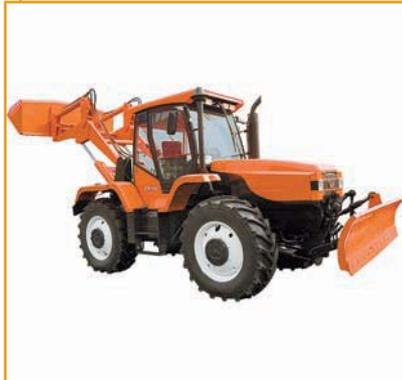
Трактор РТ-М-160У с фронтальным погрузчиком предназначен для погрузочно-разгрузочных и транспортных работ по перевозке сыпучих материалов; перемещения грузов на небольшие расстояния; земляных работ на грунтах I и II категории; работ по планировке площадок, засыпки траншей, ям и очистки проезжей части улиц и площадей.
