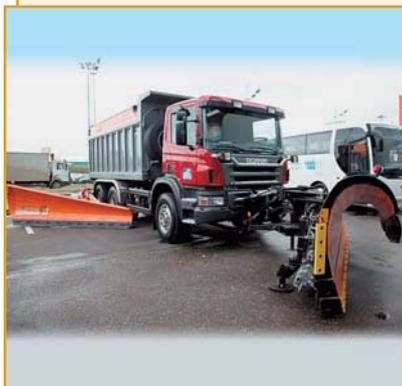
Комбинированная дорожная машина SCANIA на специально сконструированном шасси: компоненты шасси и силовая линия подобраны с учетом особенностей эксплуатации в России. Мощные и прочные двойные лонжероны рамы общей толщиной 17,5 мм обеспечивают жесткость и прочность всей конструкции. Шасси имеют дополнительные выходы и разъемы для оптимальной и оперативной установки дополнительного кузовного оборудования.
