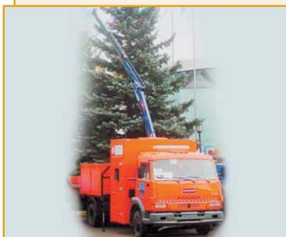
Аварийно-ремонтная машина АРМ-Е на базе трехместного грузопассажирского автомобиля КАМАЗ 4308, оборудованного краноманипулятором, предназначена для подъема и перемещения грузов массой до 990 кг на высоту до 6 м; перевозки звена рабочих до 6 человек и необходимого оборудования; проведения работ по содержанию автомо-
