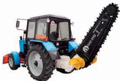
Грунторез 2086.31.00.000 предназначен для различных земляных работ в городском, сельском и транспортном строительстве.
