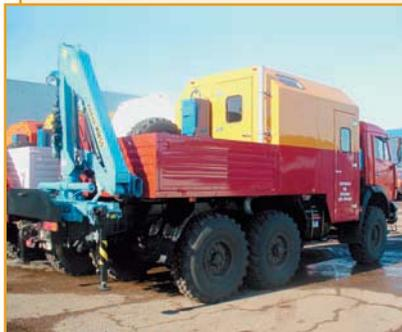
Агрегат для ремонта и обслуживания станков-качалок АРОК позволяет производить сварочные, газорезательные, монтажно-демонтажные, слесарные работы, покраску оборудования и сооружений; при наличии быстросъемной люльки – окраску и ремонт оборудования на высоте до 12 м; транспортировку различного оборудования, перевозку дежурной бригады в количестве до 5 человек.
