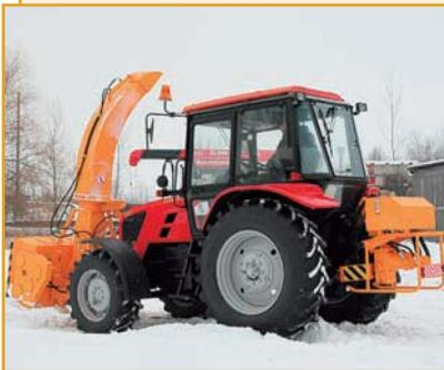
Снегоочиститель шнекороторный ФРС-200М предназначен для очистки дорожных покрытий от снега, а также для удаления снежных валов, образованных другими снегоочистителями, путем отбрасывания в сторону или погрузки в транспортное средство.
