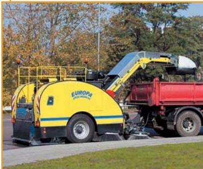
Двухколесная подметальная машина EUROPA прицепляется к грузовику. Загружает грязь непосредственно в кузов-платформу грузовика. Привод от автономного дизельного двигателя. Скорость подметания – 1–20 км/ч. Транспортная скорость – до 40 км/ч.
