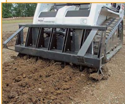
Рыхлитель предназначен для проведения работ по обустройству ландшафтов: для разрыхления уплотненного грунта перед посадками, экскавационными работами или перед разравниванием грунта, для удаления тонких слоев асфальта.
