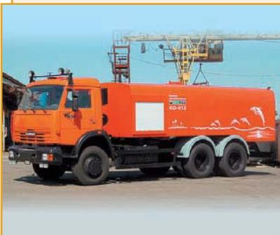
Каналопромывочные машины для очистки ливневых канализационных труб от осадков и засоров.
