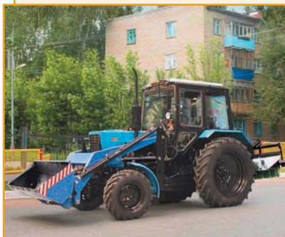
Высокопроизводительная погрузочно-уборочная машина ПУМ-4853 с погрузочно-щеточным оборудованием предназначена для уборки проезжей части улиц, площадей, дорог и тротуаров с твердым покрытием от мусора и для погрузочно-разгрузочных работ. Возможно комплектование быстросменным отвалом и другим навесным оборудованием.
