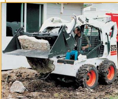
Мини-погрузчик Bobcat S175 с удлиненной базой, плавными ходовыми качествами, вертикальной траекторией подъемного оборудования, имеет большой вылет при максимальной высоте разгрузки.
