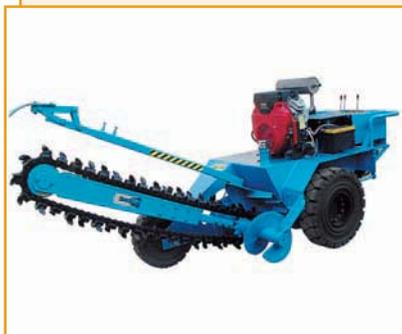
Малогабаритный траншеекопатель ручной ТКМГ-1200 выполнен на спецшасси. Импортные комплектующие, в т. ч. гидравлический привод и бензиновый двигатель (Япония). Сопоставим по характеристикам с зарубежными аналогами.
