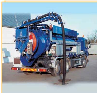
Комбинированные каналопромывочные установки для очистки канализационных и водопроводных сетей на базе двух-, трех- и четырехосных шасси Scania производства компании J. Hvidtved Larsen A/S (Дания).
