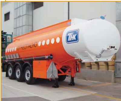
Полуприцепы-цистерны INDOX самонесущей конструкции предназначены для перевозки, временного хранения и перекачивания светлых нефтепродуктов плотностью до 860 кг/м<sup>3</sup>.
