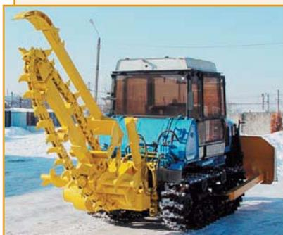
Землеройные машины МЗЦ-75, ЭТЦ-75, ЭТЦ-75У на базе трактора "Агромаш 90ТГ" (ДТ-75 – гусеничный). Дополнительно оснащены отвалами с гидравлическим переключением, поворотными отвалами, стрелой трубоукладчика грузоподъемностью до 4 т.
