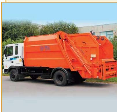
Мусоровозы КО-456 с задней загрузкой предназначены для механизированного (из контейнеров объемом 0,12–1,1 м<sup>3</sup>) и ручного сбора твердых бытовых отходов, их уплотнения, транспортирования и механизированной разгрузки в местах утилизации.
