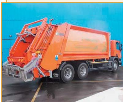
Большегрузный мусоровоз с задней загрузкой предназначен для механизированного и ручного сбора твердых бытовых отходов и транспортирования их к местам утилизации. Уплотнение отходов осуществляется при помощи прессующей и выталкивающей плит. Выгрузка отходов производится выталкивающей плитой.
