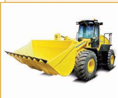
Фронтальный колесный погрузчик ПК-65 предназначен для погрузки сыпучих и кусковых материалов, производства земляных работ на грунтах I и II категорий с выгрузкой грунта в отвал или в транспортные средства, планировки площадок, перемещения сыпучих материалов на небольшие расстояния, а также для строительного-дорожных, монтажных и такелажных работ.
