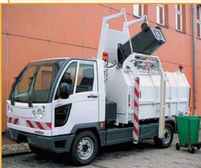
Многофункциональная коммунальная машина Multicar (Германия).
