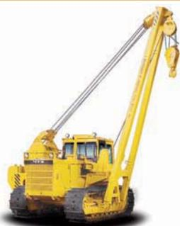
Трубоукладчик ТР 12 выполнен на базе специальной модификации трактора. Увеличенная колея и длина опорной поверхности гусениц с широкими башмаками обеспечивают уменьшенное давление на грунт, большой момент устойчивости трубоукладчиков. За счет изменений конструкции трансмиссии базового трактора уменьшена скорость движения на 1-й передаче. Применение гидростатического привода стрелы обеспечивает
