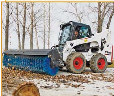
Угловая (поворотная) щетка Bobcat с гидроприводом предназначена для сметания сырой и засохшей грязи, легкого снега и мусора.
