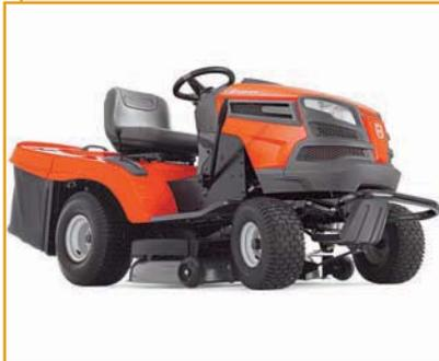
Садовый трактор Husqvarna СТН 182Т применяется для быстрой и эффективной стрижки газонов. Гидростатическая трансмиссия. Двухцилиндровый двигатель с системой принудительной смазки под давлением.
