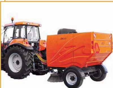
Вакуумная подметально-уборочная машина PRONAR ZMC 2.0 (Польша) предназначена для уборки территорий с твердым покрытием: тротуаров, площадей, парков. Применяется в коммунальном хозяйстве для очистки обочин дорог, в дорожно-эксплуатационных предприятиях для технологической очистки поверхности дорог.
