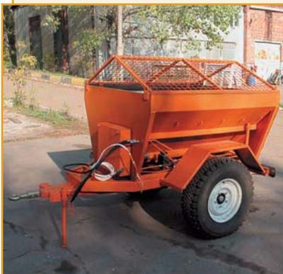
Трактор “Беларус-320” в комплектации с прицепом ПККД-20 с распределяющим оборудованием применяется для распределения на дорожном покрытии твердых материалов (песко-соляная смесь, гранитная или мраморная крошка и др.) или реагентов, используемых в зимнее время для содержания тротуаров и иных территорий.
