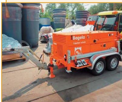
Гидравлическая тяговая лебедка предназначена для прокладки кабеля и ПЭ-труб.
