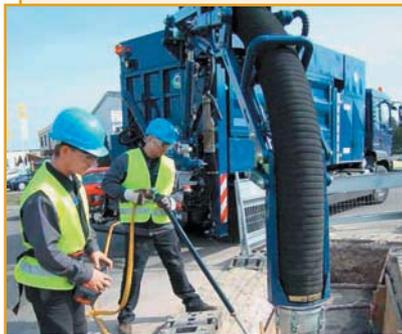
Вакуумный погрузчик МТС (Германия) – автономное транспортное средство на базе автомобилей VOLVO, MAN, IVECO с высокопроизводительной турбиной, вспомогательным пневматическим инструментом и контейнером объемом до 12 м<sup>3</sup>.
