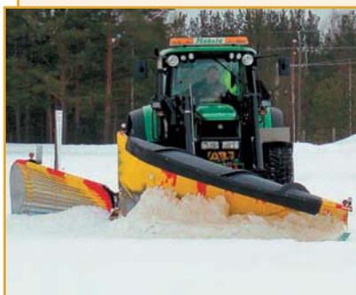
Применение бокового отвала Arctic Machine 207 на тракторе с одновременным использованием переднего отвала позволяет увеличить ширину уборки и сократить количество проходов. Обеспечивает эффективность и рентабельность работ по содержанию дорог.
