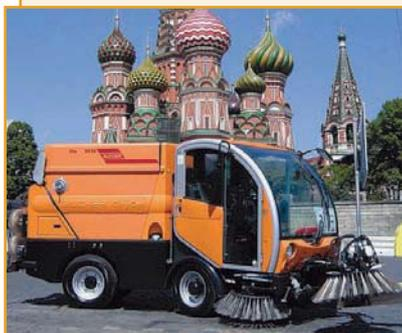
Подметально-вакуумная машина Bucher CityCat-2020XL имеет систему рулевого управления с шарнирно-сочлененной рамой. Возможна установка зимних агрегатов: фронтального плуга, подметальной щетки, распределителя ПГМ.
