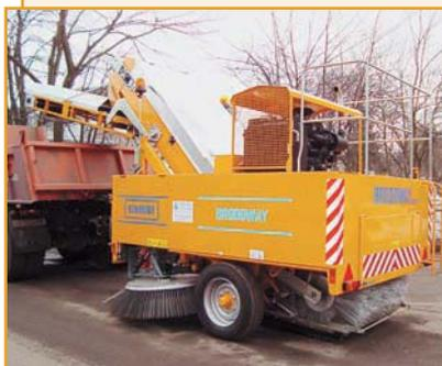
Прицепная механическая подметально-уборочная машина Broddway Senior 2000 (Швеция) буксируется самосвалом. Механический подбор и прямая загрузка смета в кузов самосвала для тяжелой и скоростной уборки. Легко, быстро и чисто убирает слежавшийся зимний песок, асфальт после фрезерования,
