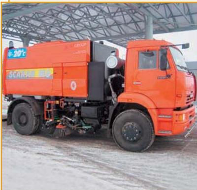
Вакуумные подметально-уборочные машины серии МКУ предназначены для автоматизированной уборки магистралей, городских дорог, площадей и аэродромов с увлажнением подметаемой поверхности в летний и зимний период.
