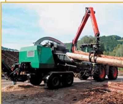
Установка SHIPPO 500 производства компании КОМПТЕЧ (Австрия) представляет собой дробилку барабанного типа с приводом от трактора для измельчения срезанных ветвей и древесных стволов. Активная система подачи измельчаемого материала, две скорости вращения барабана и возможность выгрузки материала посредством патрубка с нагнетателем или ленточного конвейера придают установке совершенство и универсальность.
