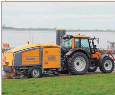
Прицепная механическая подметально-уборочная машина Broddway WASA 300 (Швеция) оснащена приводом агрегатов от гидронасоса, устанавливаемого на вал отбора мощности трактора, а также системой увлажнения для борьбы с пыленностью.
