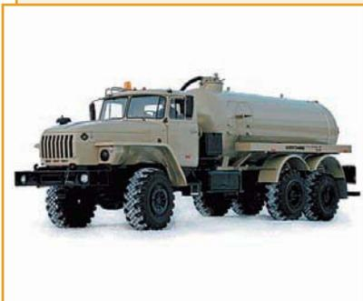
Машины вакуумные на шасси автомобилей «Урал».
