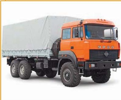
Автомобиль с бортовой платформой на шасси "Урал 4320-3951-58 борт" колесной формулой 6 × 6.
