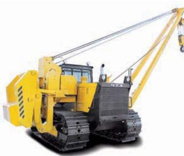
Трубоукладчик ТР 20 выполнен на базе специальной модификации трактора. Увеличенная колея и длина опорной поверхности гусениц с широкими башмаками обеспечивают уменьшенное давление на грунт, большой момент устойчивости трубоукладчиков. За счет изменений конструкции трансмиссии базового трактора уменьшена скорость движения на 1-й передаче. Применение гидростатического привода стрелы обеспечивает
