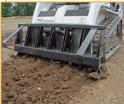
Рыхлитель предназначен для проведения работ по обустройству ландшафтов: для разрыхления уплотненного грунта перед посадками, экскавационными работами или перед разравниванием грунта, для удаления тонких слоев асфальта.
