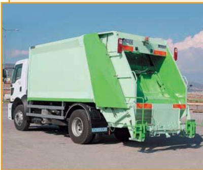
Мусоровоз ТКМ-420 с задней загрузкой KATMERCILER предназначен для механизированной погрузки твердых бытовых отходов, их уплотнения, транспортирования и механизированной выгрузки.
