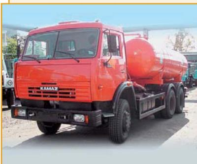
Илососные машины для вакуумной очистки колодцев, ливневой и канализационной сетей от ила и транспортировки его к месту выгрузки.
