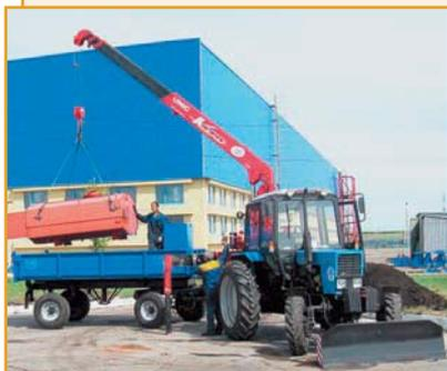
Кран-манипуляторная установка КМУ-Е предназначена для проведения погрузочно-разгрузочных работ в условиях бездорожья, строительного-монтажных и других работ на высоте до 10 м, транспортировки грузов в агрегируемом прицепе, выполнения земляных и планировочных работ в небольших объемах.
