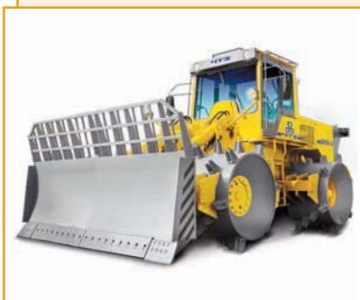
Компактор БКК-1 предназначен для перемещения, разравнивания, дробления и уплотнения твердых бытовых и производственных отходов, закрытия их покрывающим грунтом в районах с тропическим, умеренным или холодным климатом при температуре окружающего воздуха до -40 °С.
