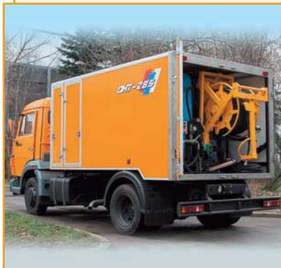
Малогабаритные каналопромывочные машины предназначены для всесезонной прочистки и устранения аварийных засоров канализационных, водосточных и промышленных сетей в стесненных и труднодоступных местах.
