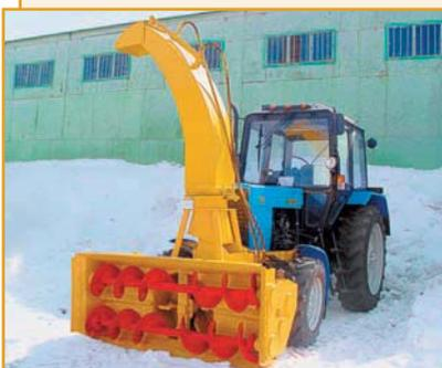
Снегоочиститель шнекороторный ШРС предназначен для очистки дорожных покрытий от снега, а также для удаления снежных валов, образованных другими снегоочистителями, путем отбрасывания в сторону или погрузки в транспортное средство.
