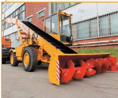
Снегопогрузчик ТКМ-237-01 со шнековым питателем и цепным транспортером предназначен для погрузки в транспортные средства свежевыпавшего и уплотненного снега через кабину или задний борт.
