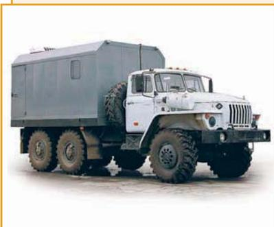
Транспортно-бытовая машина на шасси автомобиля "Урал-4320-41".
