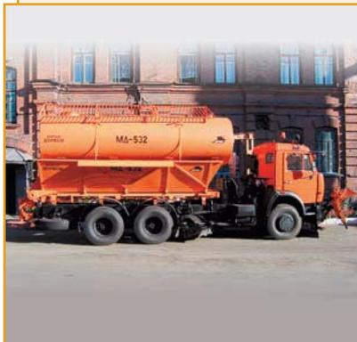
Машины комбинированные уборочные МД-43253, МД-532, МД-651 предназначены для очистки усовершенствованных дорожных покрытий от свежевыпавшего снега (сгребание, подметание, удаление с проездов) и распределения по поверхности дорог материалов и специальных реагентов при зимнем содержании дорог.
