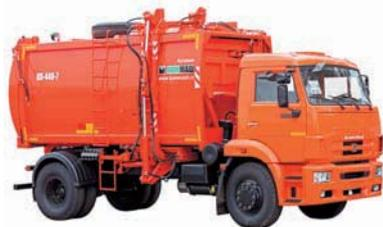
Мусоровозы с боковой загрузкой КО-440-4К, КО-440-4К1, КО-440-4М, КО-440-5, КО-440-6, КО-440-7, КО-440-8 предназначены для механизированной загрузки, уплотнения, транспортировки и выгрузки твердых бытовых отходов.
