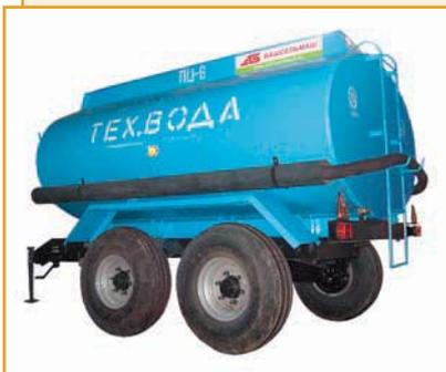
Полуприцеп-цистерна ПЦ-6 балансирующая с рабочей пневматической системой тормозов для тракторов тягового класса 1,4 и выше. Предназначена для перевозки и временного хранения технической воды, в т. ч. и в полевых условиях.
