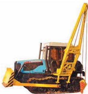
Универсальная ремонтная машина УРМ-4 на базе трактора "Агромаш 90ТГ" (ДТ-75 – гусеничный) грузоподъемностью до 4 т. Дополнительно комплектуется отвалом с гидроперекосом или поворотным отвалом. При транспортировке трубоукладчика его стрела складывается.
