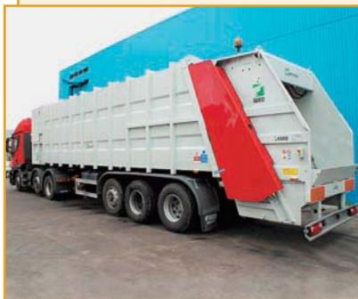
Транспортный мусоровоз с задней загрузкой предназначен для механизированного сбора твердых бытовых отходов и транспортирования их к местам утилизации.
