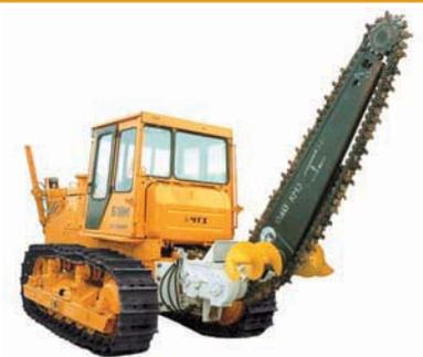
Агрегат траншейный АТ.00.00.000 предназначен для разработки плотных грунтов при различных земляных работах в городском, сельском и транспортном строительстве.
