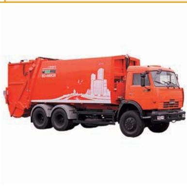
Мусоровозы с задней загрузкой КО-440К20, КО-440К15, КО-440К8, КО-440П8, КО-440R1 предназначены для механизированного сбора твердых бытовых отходов из металлических и пластмассовых контейнеров всех типов объемом до 1,1 м<sup>3</sup>, их уплотнения, транспортирования и механизированной выгрузки в местах утилизации.
