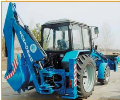
Экскаватор-погрузчик со смещаемой осью копания ЭП-2630ЕМ предназначен для механизации погрузочно-разгрузочных работ с сыпучими и мелкокусковыми материалами для землеройно-транспортных работ на грунтах I–II категорий (ковшом) и на грунтах I–IV категорий (экскаваторным оборудованием). Работа на грунтах выше III категории возможна после предварительного рыхления.
