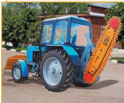
Баровые машины БГМ-1, БГМ-2, БГМ-2У предназначены для разработки траншей прямоугольного сечения под кабельные линии связи и электропередач, трубопроводы различного назначения, а также для прокладки других коммуникаций в талых грунтах до I-II категории. Конструкция предусматривает установку барового органа "Урал-33" для резки щели в мерзлых грунтах до V категории включительно.
