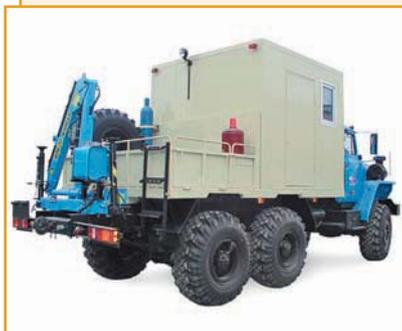
Автомобиль специальный АНРВ предназначен для ремонта и профилактического обслуживания технологического оборудования водопроводов, канализации в коммунальном хозяйстве населенных пунктов, а также наземного оборудования нефтепромыслов, технологических трубопроводов нефтесборных пунктов, элементов фонтанной арматуры и станков-качалок.
