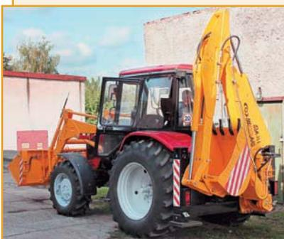
Экскаватор-погрузчик ДЭМ-1143 предназначен для выполнения экскавационных работ на грунтах I–III категории и погрузочно-разгрузочных работ.
