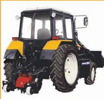
Фрезерные машины АМКОДОР 8047А, АМКОДОР 8047А-01, АМКОДОР 8047А-02 предназначены для подготовки покрытий дорог, аэродромов, тротуаров и т. п. к ремонту методом холодного фрезерования.
