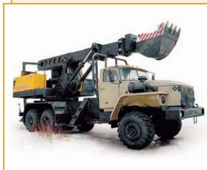
Экскаватор-планировщик на шасси "Урал-4320-40" с полноповоротным ковшом на конце телескопической стрелы.
