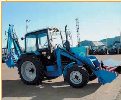
Экскаватор-погрузчик ЭП-2626ЕМ предназначен для механизации погрузочно-разгрузочных работ с сыпучими и мелкокусковыми материалами, для землеройно-транспортных работ на грунтах I–II категорий (ковшом) и на грунтах I–IV категорий (экскаваторным оборудованием). Работа на грунтах выше III категории возможна только после предварительного рыхления. Гидрораспределитель и уплотнители (Италия) обе-
