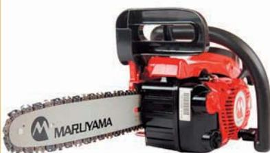
Бензопила MARUYAMA MCV3100S (16") производства Японии. Бензиновый 2-тактный двигатель MARUYAMA®, мощность – 1,7 л. с., рабочий объем – 31 см<sup>3</sup>, функция самоочистки, облегченный запуск. Длина шины – 41 см. Объем бензобака – 0,23 л. Вес – 3,6 кг.
