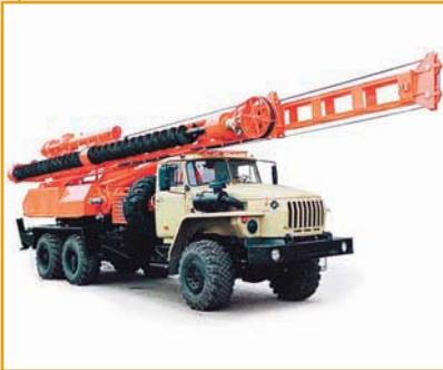
Бурильно-сваебойная машина на шасси "Урал-4320-40" предназначена для бурения скважин в талых и вечномерзлых грунтах I-IV категорий на заданную глубину с заданным диаметром и забивания в них свай при строительстве свайных фундаментов зданий и сооружений.
