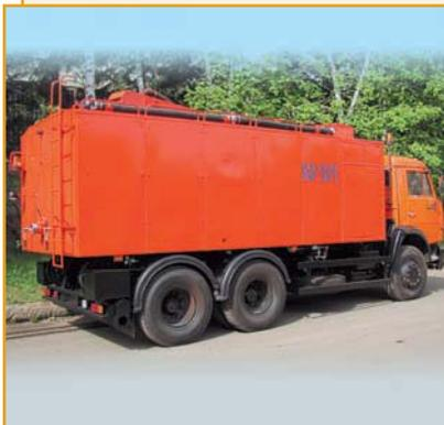
Машина комбинированная каналоочистительная КО-564 предназначена для механизированной очистки трубопроводов ливневой и канализационной сетей от засоров, очистки заполненных канализационных колодцев, выгребных ям и отстойников от ила, песка и иных отложений и вывоза их к месту утилизации.
