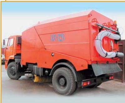
Подметально-уборочные машины для очистки городских дорог с асфальтовым или цементобетонным покрытием от загрязнений, а также для перевозки собранного смета к местам свалок.
