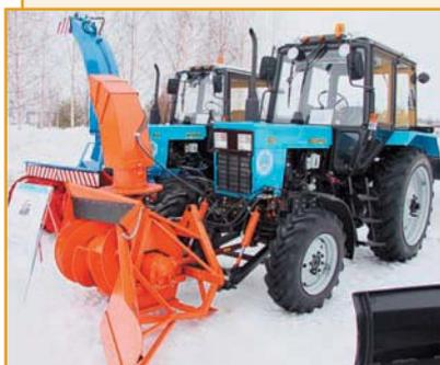
Высокая производительность снегоочистителя позволяет работать на тракторе без ходоуменьшителя.
