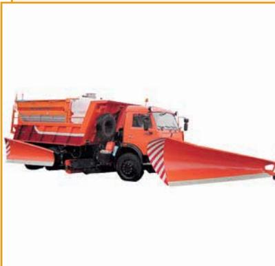
Универсальная дорожная машина УДМ-80ЕС на базе КАМАЗ 65115-62 с навесным оборудованием для распределения увлажненной соли АСОМЕТИС V3020D (Франция).
