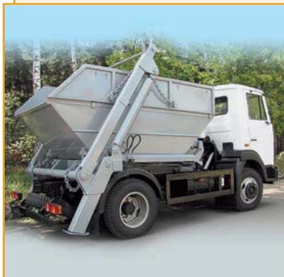
Мусоровозы контейнерные КО-450 предназначены для сбора твердых бытовых отходов и крупногабаритного строительного мусора, транспортирования и разгрузки в местах утилизации.
