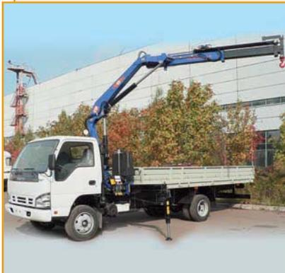
Краны-манипуляторы автомобильные с краноманипуляторными установками КМУ UNIC (Япония) и РМ (Италия) предназначены для погрузки, перевозки и разгрузки различных грузов и проведения монтажных работ.
