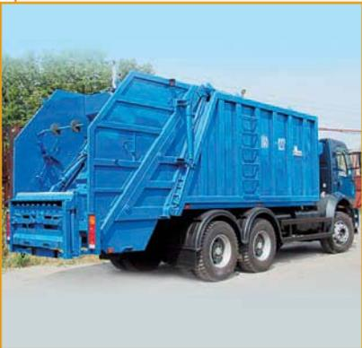
Большегрузные мусоровозы КО-427 с задней загрузкой кузова предназначены для механизированного и ручного сбора твердых бытовых отходов, их уплотнения, транспортирования и механизированной разгрузки в местах утилизации. Спецоборудование может монтироваться на шасси КамАЗ, МАЗ, HYUNDAI, FORD, MAN, Dong Fehng и др.
