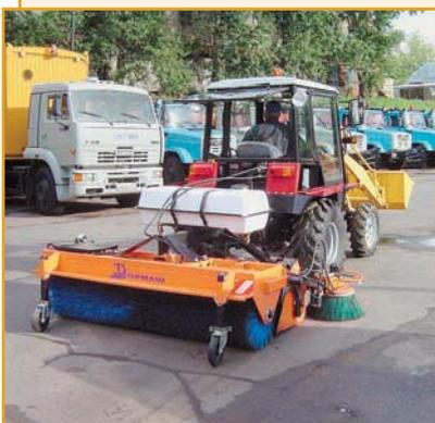
Машина коммунальная комбинированная МКК-10 на базе трактора “Беларус-320” в комплектации с фронтальным погрузчиком и подборщиком смета обеспечивает очистку дворовых территорий, тротуаров, площадок и др. мест от пыли, мусора, смета, опавшей листвы путем сгребания в специальный накопительный бункер и дальнейшей погрузки в кузов автомобиля или прицепа.
