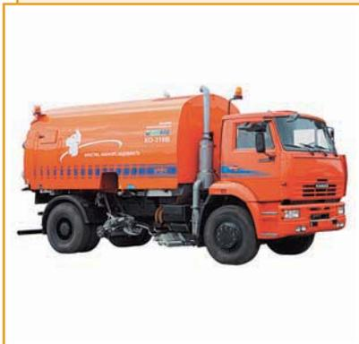
Вакуумные подметально-уборочные машины КО-316Б, КО-316Б-01 предназначены для автоматизированной летней уборки дорожных покрытий с увлажнением подметаемой поверхности, поглощением пыли, транспортированием смета и его механизированной разгрузки. На машину КО-316Б устанавливается навесное подметально-вакуумное оборудование "K7" фирмы KOBIT (Чехия).
