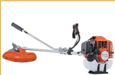
Травокосилка Husqvarna 143R-II предназначена для профессионалов-озеленителей. Высокая производительность. Комплектуется двойной ременной оснасткой, диском для травы, триммерной головкой и комбинированным кожухом. Эффективный воздушный фильтр. Топливоподкачивающий насос. Рабочий объем цилиндра – 41,5 см<sup>3</sup>. Мощность – 1,5 кВт/2,0 л. с. Топливный бак – 0,95 л. Масса – 7,6 кг. Страна производства – Япония.
