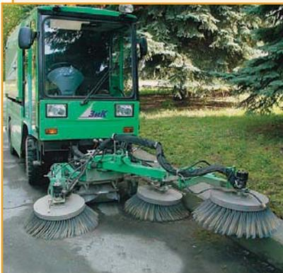
С 2005 г. в рамках конверсии предприятием освоен выпуск коммунальных вакуумных тротуароуборочных машин серии МК-1500, предназначенных для механизированной уборки дворов, тротуаров и других подобных мест от мусора, пыли и грязи.
