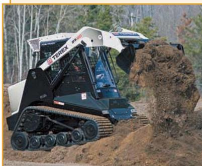
Гусеничный погрузчик Terex-PT 60 (США) с повышенной проходимостью и отличным сцеплением с дорожным покрытием благодаря гусеничной ходовой. Дополнительная гидравлика в передней части мини-погрузчика позволяет использовать различное навесное оборудование для выполнения различных видов работ в ЖКХ.
