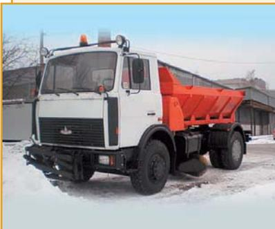
Снегоуборочные машины для снегоочистки городских дорог с усовершенствованным покрытием, а также для посыпки инертными материалами или антигололедными реагентами поверхности дорожного полотна. Может использоваться для перевозки снега и других сыпучих материалов.
