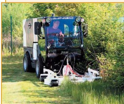
Многофункциональная коммунальная машина City Ranger (JUNGO JET) 3500 (Германия) предназначена для круглогодичного содержания дорог, тротуаров, площадей и открытых общественных зон (автомобильных парковок и др.).
