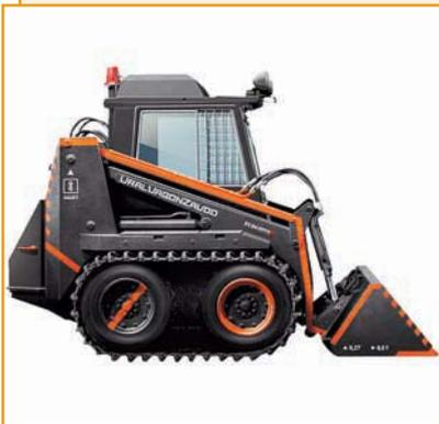
Универсальный малогабаритный погрузчик ПУМ-500У предназначен для механизации погрузочно-разгрузочных работ с грунтом I–IV категорий, сыпучими и мелкокусковыми материалами как в обычных, так и в стесненных условиях; транспортно-складских работ со штучными грузами; для специальных работ (бурение скважин, очистка от снега и грязи дорог и тротуаров и др.).
