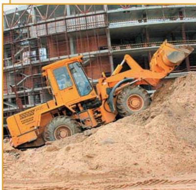
Погрузчики универсальные АМКОДОР 332С4, АМКОДОР 342С4, АМКОДОР 352С грузоподъемностью от 3,4 до 4,7 т – это модифицированные погрузчики с гидравлическими устройствами (адаптерами) и большим набором специальных сменных рабочих органов.
