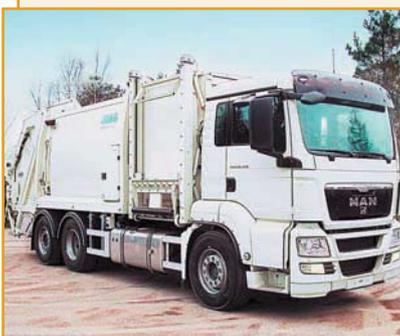
Кузов мусоровоза JOAB (Швеция) оснащен лебедкой и подъемным приспособлением для всех типов баков и контейнеров. Усиленные стенки кузова и заднего приемного бункера, коробка отбора мощности, гидроцилиндры механизма прессования позволяют перевозить крупногабаритные отходы. Пневматическая система заменена гидравликой. Подшипники не требуют смазки, обеспечивают высокую надежность узлов.
