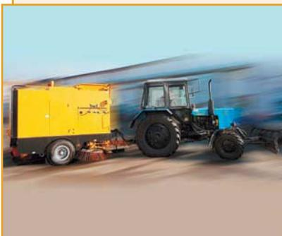
Подметально-уборочная машина "ПУМА" предназначена для уборки улиц, площадей, производственных территорий и автодорог, в том числе имеющих разделительные полосы, транспортные развязки, путепроводы и мосты. Буксируется трактором тягового класса 1.4. Снабжена системой увлажнения и механическим транспортированием смета в бункер,
