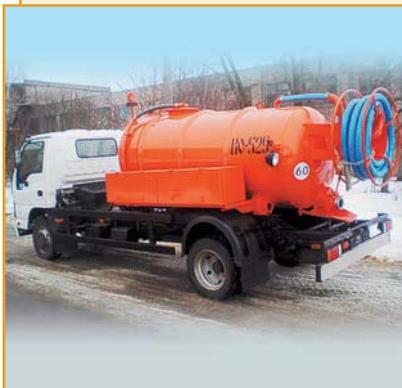
Машины ассенизационные (вакуумные) КО-529 предназначены для вакуумной очистки выгребных ям и канализационных колодцев, транспортирования и выгрузки в местах утилизации жидких отходов, не содержащих горючих и взрывоопасных веществ.
