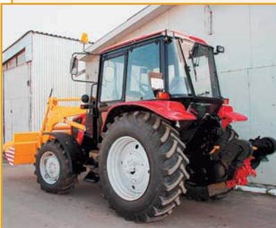
Машина фрезерная ДЭМ-121 предназначена для ямочного ремонта асфальтовых покрытий и территорий.
