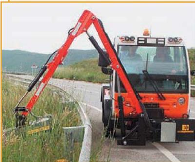
Многофункциональная коммунальная машина AUSA (Испания) предназначена для круглогодичного содержания дорог, тротуаров, площадей и открытых общественных зон (автомобильных парковок и др.).
