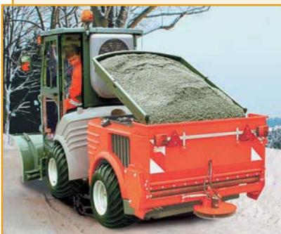
Вакуумные подметальные машины Hako-Citymaster (Германия) предназначены в том числе и для распределения антигололедных материалов.
