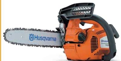
Бензопила для работы на вышке Husqvarna T435 применяется для профессионального ухода за деревьями, ликвидации опасно зависших ветвей и др. Компактная, управляется одной рукой. Быстро развивает мощность в любых режимах работы. Натяжитель цепи не требует инструментов. Система легкого запуска Smart Start®. Тормоз цепи перфорирован для контроля за процессом пиления. Отверстие для крепления веревкой пилы к снаряжению. Рабочий объем цилиндра – 35,2 см<sup>3</sup>.
