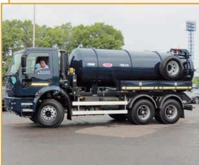
Машина илососная ТКМ-670 с оборудованием KATMERCILER предназначена для обслуживания ливневой канализационной сети, а также используется для очистки колодцев ливневой канализации, отстойников от слежавшегося осадка.
