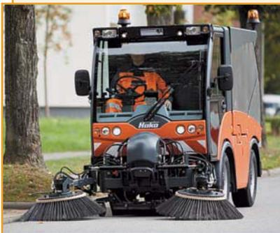
Вакуумные подметальные машины Hako-Citymaster (Германия) с бункером объемом 1 и 2 м<sup>3</sup>.
