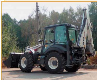
Экскаватор-погрузчик TEREX-970 (Великобритания) с колесной формулой 4 × 4 × 4 (все ведущие и все поворотные равновеликие колеса). “Крабовый ход” и повышенная проходимость по бездорожью и слабым грунтам. Гидроразводка на обратной лопате, быстросменная сцепка для замены ковша на дополнительное навесное оборудование.
