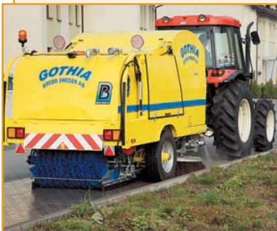
Боковые щетки сметают грязь к центру, основная широкая щетка забрасывает ее на прочный подъемник с резиновыми лентами. Выгрузка смета в бункер. Привод от гидравлики трактора. Скорость подметания – 1–20 км/ч. Транспортная скорость – до 40 км/ч. Тормозная система накатом.
