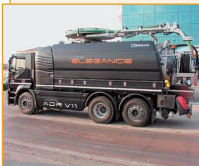
Комбинированная каналопромывочная машина MORO предназначена для аварийной и профилактической очистки и обслуживания канализационных и водопроводных сетей.
