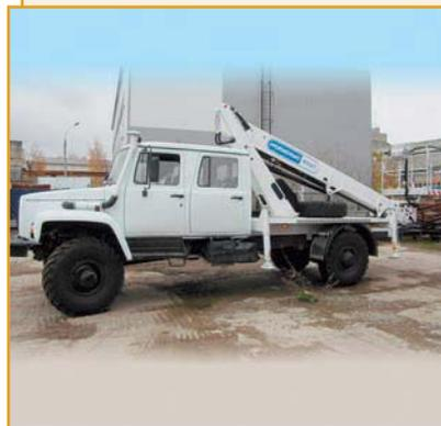
Автогидроподъемники на дорожных и полноприводных шасси предназначены для подъема людей с инструментом в люльке с целью проведения работ на высоте.
