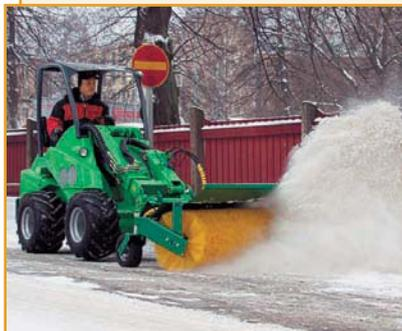
Шарнирно-сочлененный мини-погрузчик Avant 635 (Финляндия) – новое решение для уборки территории в ЖКХ. Отличается максимальной компактностью, повышенной проходимостью. Более 60 видов универсального сменного оборудования. Дизельный двигатель – Kubota (Япония). Мощность двигателя – 36 л. с.
