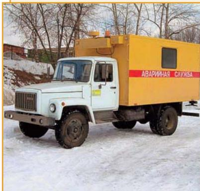
Аварийно-ремонтная машина "МАВР" предназначена для доставки бригады ремонтников и проведения профилактических, ремонтных и аварийных работ в канализационных, теплофикационных, водопроводных, электрических, газовых и иных инженерных сетях.
