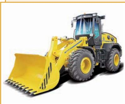
Фронтальный колесный погрузчик ПК-46 предназначен для погрузки сыпучих и кусковых материалов, производства земляных работ на грунтах I и II категорий с выгрузкой грунта в отвал или в транспортные средства, планировки площадок, перемещения сыпучих материалов на небольшие расстояния, а также для строительного-дорожных, монтажных и такелажных работ.
