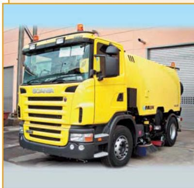
Вакуумные подметально-уборочные машины SYMPAJET на шасси SCANIA предназначены для механизированной уборки городских дорог, улиц, автострад, площадей с асфальтовым и цементным покрытием с увлажнением подметаемой поверхности и поглощением пыли, транспортированием смета в бункер и его механизированной разгрузкой.
