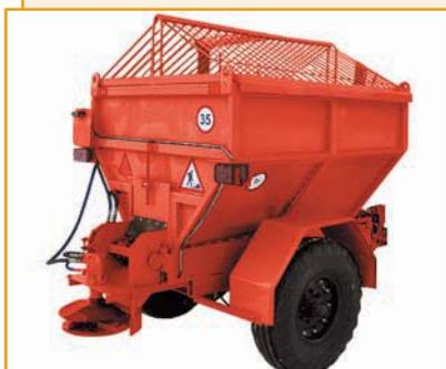
Пескоразбрасыватель УДМ-ПР-3 предназначен для разбрасывания песчано-соляных смесей на тротуарах и дорогах в населенных пунктах.
