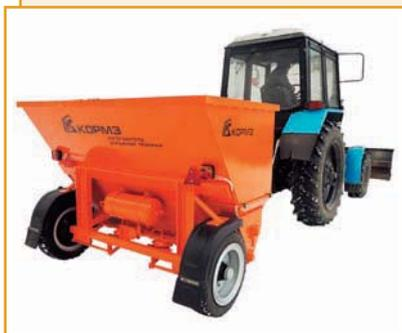
Пескораспределитель ПРТ предназначен для распределения твердыми противогололедными материалами (ПГМ) поверхностей дорог, тротуаров, пешеходных зон, площадей, скверов дворовых проездов и проходов в осенне-зимне-весенний период, а также для работ по вывозу убираемого снега. Агрегируется с тракторами тягового класса 1.4.
