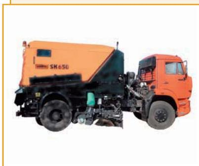
Базовое шасси – КамАЗ-53605/МАЗ-5551А2.
