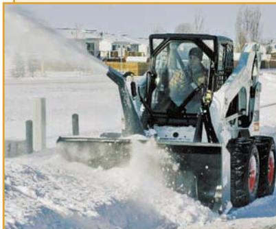
Снегометатель оснащен гидравлическим двигателем с прямым приводом для вентилятора и шнека, что обеспечивает более высокую износостойчивость по сравнению с приводами, использующими редукторы, цепи, звездочки и срезаемые штифты. Поворотный желоб позволяет выбрасывать снег на расстояние до 15 м.
