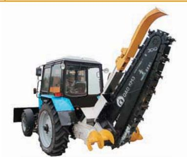
Грунторез 2086.51.00.000 предназначен для прорезки траншей для укладки линий связи и электросиловых кабелей, трубопроводов и прочих коммуникаций.
