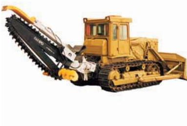
Агрегат траншейный модернизированный (АТМ) обеспечивает резку траншей в грунтах шириной щели 280 или 400 мм и глубиной прорезания от 2000 до 2700 мм.
