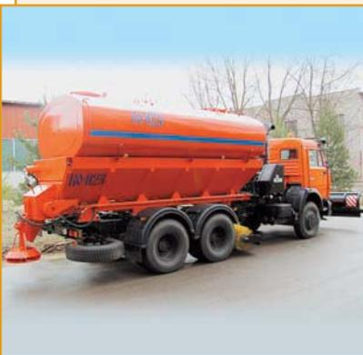
Машины комбинированные предназначены для круглогодичного использования по содержанию городских дорог с твердым покрытием и автомагистралей.
