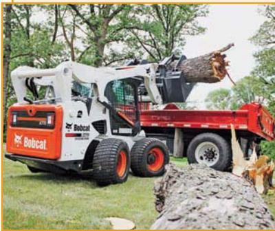
Мини-погрузчик A770 с двойной системой поворота обеспечивает щадящее воздействие на травяной покров за счет возможности поворота всех колес и максимальную маневренность в стесненных условиях за счет бортового поворота.
