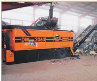
Мобильный универсальный измельчитель предназначен для первичного или вторичного измельчения/дробления различных материалов в целях уменьшения размера фракции и/или подготовки материала для переработки или утилизации. Область применения: твердые бытовые отходы, крупногабаритные отходы, древесные отходы, строительные отходы и т. д.
