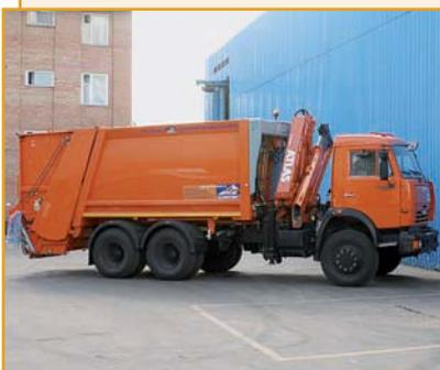
Большегрузный мусоровоз с задней загрузкой предназначен для механизированного сбора твердых бытовых отходов из заглубленных контейнеров и транспортирования их к местам утилизации. Уплотнение отходов осуществляется при помощи прессующей и выталкивающей плит. Выгрузка отходов производится выталкивающей плитой.
