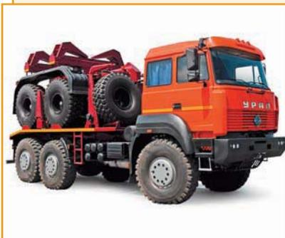
Автомобиль-трубоплетевоз на шасси «Урал-6902-22».
