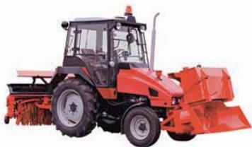
Тротуароуборочные машины КО-718 на базе трактора предназначены для содержания дорожек и тротуаров, имеющих асфальто-бетонное покрытие.
