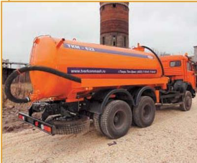
Машины ТKM-622, ТKM-622A на шасси автомобиля КамАЗ-65115 предназначены для вакуумной загрузки, транспортирования к месту утилизации и выгрузки жидких отходов, не содержащих горючих и взрывоопасных веществ. Различные варианты комплектации машин насосами и дополнительным оборудованием по требованию заказчика.
