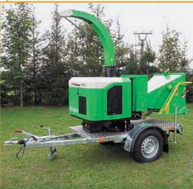
Измельчитель LS150D производства LASKI (Чехия) предназначен для утилизации древесных отходов, мелких веток, коры и т. п. с последующей выдачей щепы.
