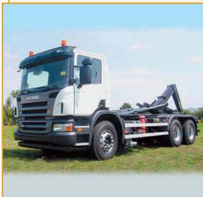
Погрузочно-разгрузочный механизм с системой крюкового захвата MARREL на шасси SCANIA позволяет заменить целый парк спецтехники и использовать одну машину в течение дня для разных работ.
