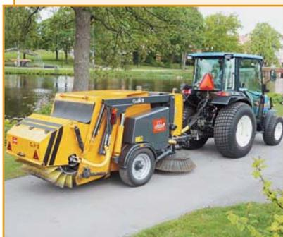
Подметально-уборочные машины Vemab G1 и G2 (Швеция) предназначены для уборки малых территорий, тротуаров, торговых площадей, дворов. Механическая система подбора смета с увлажнением. Буксируются трактором, работают с российскими моделями тракторов. Низкие затраты на техническое обслуживание.
