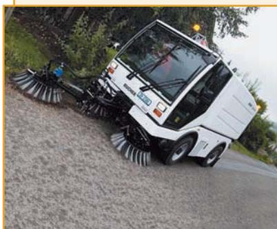
Компактная подметально-уборочная машина CityCat 5000 благодаря рулевому управлению на четыре колеса отличается не только максимальной маневренностью, но и высокой боковой устойчивостью.
