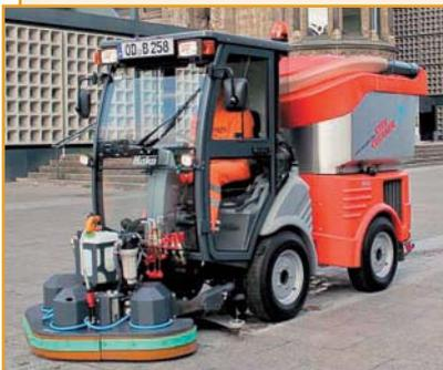
Малогабаритные тротуароуборочные и поливомоечные машины Hako-Citymaster (Германия) отличаются высокой маневренностью и большой мощностью.
