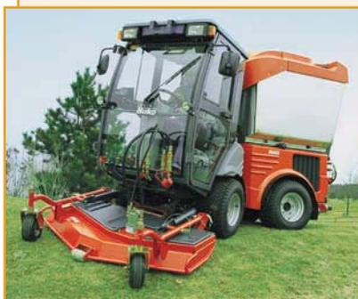
Вакуумная подметальная машина Hako-Citymaster 1200 (Германия) в комбинации с газонокосилкой и системой для сбора скошенной травы незаменима для содержания в идеальном состоянии газонов большой площади.
