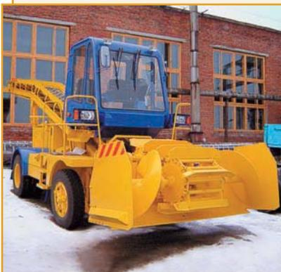
Шнекороторный снегопогрузчик СнП-18 предназначен для погрузки снега, снола и других сыпучих материалов в кузов автомобиля-самосвала через кабину или задний борт. Двухместная отопляемая и вентилируемая кабина располагается посередине над стрелой транспортера.
