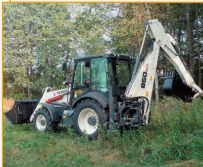
Экскаватор-погрузчик TEREX-860 SX (Великобритания) с колесной формулой 4 × 4. Курсовая устойчивость хода, нивелировка ковша от просыпания груза, гидроразводка на обратной лопате, быстросменная сцепка для замены ковша на гидромолот, гидробур, вырывной клык, трамбовку. Дизельный двигатель – Perkins.
