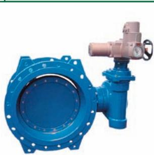
Поворотные затворы с двойным эксцентриком AWT Kolk – альтернатива вертикальным задвижкам с металлическим и обрешиненным клином на диаметрах трубопровода от Ду 300 и выше. Особенности конструкции: механизм двойного эксцентрика – снижение поворотных моментов и увеличение срока службы уплотнения диска, возможна бесколодезная (подземная) установка.
