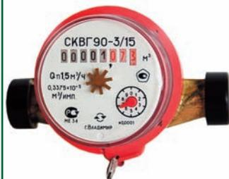
Счетчики СКВГ применяются для учета и экономии потребления воды в индивидуальном секторе и системах коммунального и промышленного водоснабжения. Предназначены для измерения объема как горячей, так и холодной воды при температуре от 5 до 90 °С и давлении не более 1 МПа.
