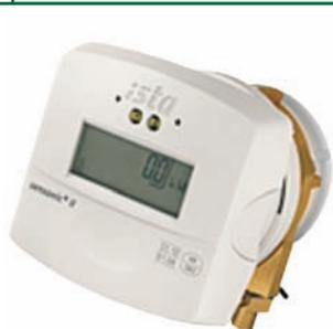
Компактный теплосчетчик "Сенсоник II" – вычислитель, многоструйный расходомер и датчик температуры в одном корпусе. Второй датчик выносной, подключается кабелем, длиной до 3 м.
