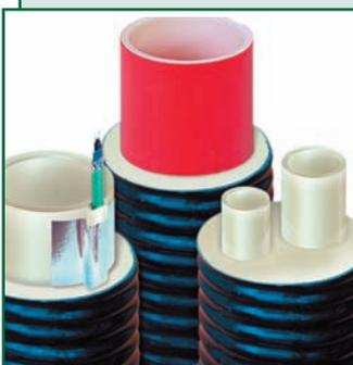
Область применения гибких пластиковых труб в ППУ-изоляции: капитальное, промышленное и гражданское строительство, в т. ч. объекты ЖКХ. Используются в качестве наружных сетей тепло/водоснабжения для транспортировки горячей и холодной воды. Внутренняя несущая труба выполнена из химически модифицированного ("сшитого") полиэтилена РЕХ-а, заключена в пенополиуретановую теплоизоляцию и гидрозащитную оболочку из полиэтилена.
