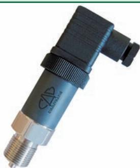
Измерительные преобразователи давления предназначены для непрерывного измерения параметра давления измеряемой среды и пропорционального преобразования его в выходной сигнал 4–20 мА. 3-диапазонное исполнение. Варианты изготовления: 2,50–1,60–1,00 и 1,60–1,00–0,60 МПа.
