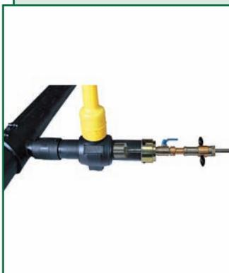
Оборудование (Hütz+Baumgarten, Германия) позволяет осуществлять врезку диаметром 50–315 мм в действующие полиэтиленовые трубопроводы без отключения потребителей.
