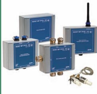
Энергонезависимый ультразвуковой расходомер-счетчик УРСВ-322 применяется для измерения среднего объемного расхода, объема реверсивных потоков холодной воды и давления в трубопроводе диаметром 150–1500 мм и передачи измерительной, установочной, архивной информации через сотовый модем или интерфейс RS-485.
