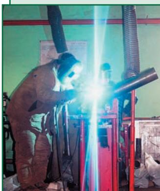
Производство стальных фасонных частей трубопроводов пара и горячей воды для дальнейшей изоляции ППУ.
