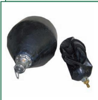
Конусовидные кевларовые и складные пневмозаглушки в виде подушки перекрывают широкий диапазон больших диаметров трубопроводов (1000–2200 мм).
