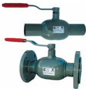
Шаровой кран фланцевый сварной предназначен для установки в качестве запорного устройства на трубопроводах для воды и пара (температура рабочей среды до +200 °С, PN 1,6–2,5 МПа); на объектах газового хозяйства (температура природного, топливного газа до +100 °С, PN 0,6 МПа); для масла и нефтепродуктов (температура рабочей среды до +90 °С) и др. слабоагрессивных сред. Подача рабочей среды в любом направлении.
