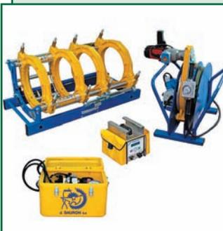
Сварочные аппараты предназначены для стыковой сварки полимерных труб.
