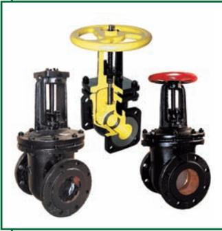
Применяется в качестве запорного устройства на трубопроводах для воды и пара (30ч 6бр), газопроводах (30ч 76к), масло-нефть (30ч 6бк). Температура рабочей среды задвижки 30ч 6бр – до +225 °С, PN 1,6 МПа (16 атм). Подача рабочей среды в любом направлении. В корпус и диски завальцованы латунные уплотнительные кольца. Присоединение к трубопроводу – фланцевое. Затвор – кран с двумя параллельными дисками.
