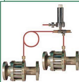
Арматура для защиты тепловых пунктов с присоединенными к ним местными системами потребителей тепла от аварийного повышения давления в обратном сетевом трубопроводе путем отсечки теплового пункта от сетевых трубопроводов – подающего и обратного, при превышении давления в обратном сетевом трубопроводе установки срабатывания и автоматического возвращения системы в исходное состояние после устранения причины срабатывания.
