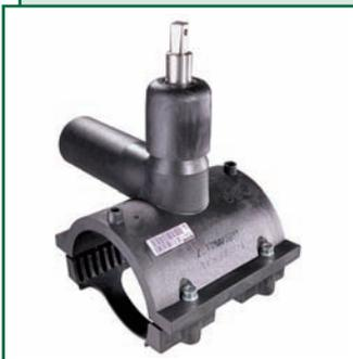
Седелка для врезки под давлением и многократного перекрытия потока среды для бесколдезной установки. Служит для врезки в действующие трубопроводы с давлением до 10 бар (газ) и 16 бар (вода) без утечек и образования стружки. Не требуется дополнительной изоляции.
