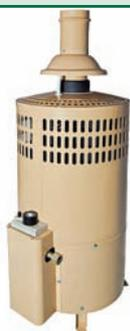
Конвектор отопительный газовый бытовой предназначен для нагрева воздуха в помещении за счет естественной конвекции воздуха. Работает на сжиженном газовом топливе. Может устанавливаться в строительной бытовке, палатке, гараже, дачном домике, использоваться МЧС для обогрева мобильных госпиталей и пунктов временного пребывания пострадавших. Номинальная тепловая мощность –  $3,12 \pm 0,3$  кВт.
