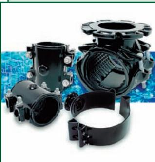
Фланцевый врезной хомут RingSeal предназначен для врезки в трубы из ПЭ, чугуна, стали. Конструкция позволяет произвести врезку в трубопровод без снятия давления в сети, с использованием специального оборудования, что позволяет существенно снизить время на монтаж. Корпус хомута полностью охватывает окружность трубы и не деформирует ее.
