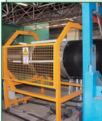
Трубы-оболочки из полиэтилена ПЭ-80 и ПЭ-100 диаметром от 90 до 1200 мм для изготовления труб в ППУ изоляции, применяемых при бесканальной прокладке и прокладке в непроходных каналах, а также термоусаживаемых муфт.
