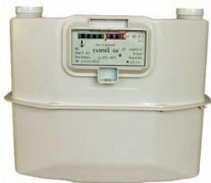
Диафрагменный счетчик газа ГАММА G6 производится совместно с немецкой фирмой. Предназначен для измерения объема газа в газопроводе низкого давления. Применяется в жилищно-коммунальном хозяйстве и быту. Исполнение – левостороннее. Диапазон расходов – от 0,06 до 10 м<sup>3</sup>/ч.
