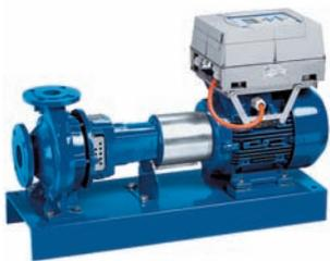
Одноступенчатый горизонтальный насос со спиральным корпусом Etanorm применяется для дождевания, орошения, водоотвода централизованных сетей тепло- и водоснабжения. Используется в установках для отопления и кондиционирования воздуха, перекачивания конденсата, техники плавательных бассейнов, для перекачивания горячей и холодной воды, воды для тушения пожаров, солоноватой воды, масел, рассолов, питьевой воды, воды для хозяйственных нужд и т. п.
