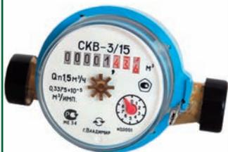
Счетчики СКВ применяются для учета и экономии потребления воды в индивидуальном секторе и системах коммунального и промышленного водоснабжения. Предназначены для измерения объема холодной воды при температуре не выше 40 °С и давлении не более 1 МПа.
