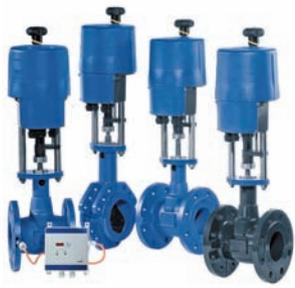
Регулирующий клапан BOA®-C/E/CS/IMS/EKB применяется в системах водяного отопления с температурой рабочей среды до 120 °С, вентиляции и кондиционирования. Клапан с управляемыми микропроцессорами и "интеллектуальными" электрическими сервоприводами от 1200 до 14 000 Н, электронное конфигурирование кривой расхода жидкости, установочного сигнала возможно посредством датчика РС.
