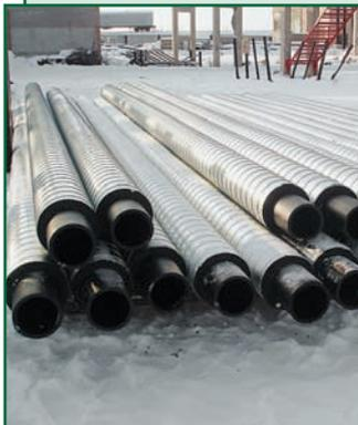
Трубы и фасонные изделия полиэтиленовые с тепловой изоляцией из пенополиуретана с защитной оболочкой СТО 47114136-002-2006.
