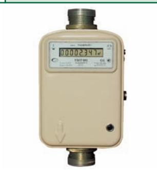
Ультразвуковые счетчики газа УБСГ 001 типоразмеров G4; G6; G10 предназначены для измерения объема газа в газопроводах низкого давления и других газообразных неагрессивных топлив в ЖКХ и быту. Предусмотрена возможность настройки коэффициентов P (рабочее избыточное давление газа) и G (плотность газа) под реальные условия.
