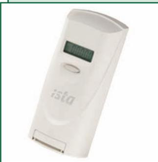
Распределитель затрат на отопление "Доприно 3" – компактный недорогой электронный прибор для поквартирных систем учета тепла в домах с вертикальной разводкой труб отопления. Устанавливается на поверхность радиатора отопления. Не требует врезки в трубопроводы. Применяется в домах с установленным общедомовым счетчиком тепла.
