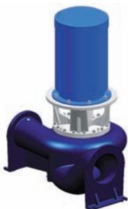
Вертикальный моноблочный циркуляционный насос системы отопления Etaline-R предназначен для применения в системах водяного отопления, в контурах охлаждающей воды, системах кондиционирования воздуха, водоснабжении, установках хозяйственного водоснабжения и промышленных системах циркуляции. Конструкция линейного типа обеспечивает легкий монтаж и упрощенное встраивание в систему приводов. Компактный дизайн требует минимум площади для установки.
