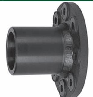
Бурт и фланец представляют цельное фланцевое изделие. Металлическая вставка во фланце для предотвращения явлений холодной текучести исключает случаи ухудшения прижатия прокладки к ответной части. Гарантирует отсутствие коррозии между фланцем и монтажными элементами – болтами и гайками.
