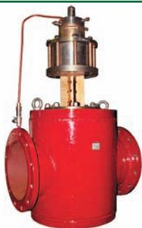
Регуляторы перепада давления предназначены для автоматического поддержания заданного перепада давления на гидравлическом сопротивлении, в том числе между выходным давлением ("+" регулятора (подающим трубопроводом теплоносителя) и давлением в обратном трубопроводе теплоносителя ("-") в системах теплоснабжения.
