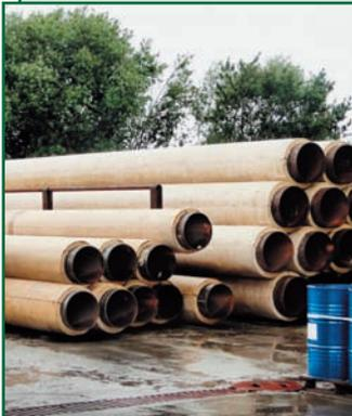
Производство и поставка предизолированных трубопроводов и фасонных изделий в пенополиминеральной изоляции (ППМ) для тепловых сетей и систем горячего водоснабжения.
