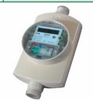
Ультразвуковые счетчики газа АГАТ типоразмеров G16; G25. Предназначены для измерения объема газа в газопроводах низкого давления и других газообразных неагрессивных топлив в ЖКХ и быту. Предусмотрена возможность настройки коэффициентов P (рабочее избыточное давление газа) и G (плотность газа) под реальные условия.
