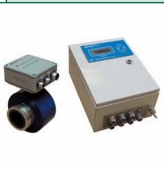
Теплосчетчик ТС-11 представляет собой многоканальный прибор, построенный по составному принципу. В составе теплосчетчика тепловычислитель ТВ-11 и измерительные блоки БИ-1. К ТВ-11 одновременно возможно подключение до 6 блоков БИ-1. В памяти тепловычислителя 11 основных и 24 дополнительных варианта расчета теплоснабжения, которые потребитель может компоновать на свое усмотрение и менять неограниченное число раз.
