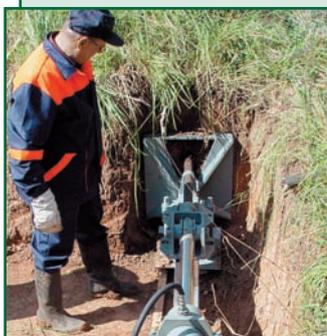
Прокальвающая установка ПУ-2 предназначена для прокладки магистралей методом прокола в грунтах любых типов с одновременным расширением и протяжкой кабеля или трубы ПНД.
