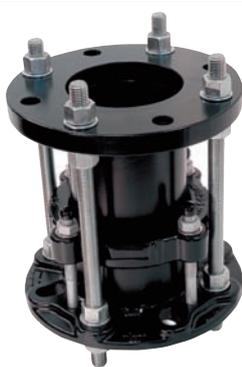
Демонтажные вставки работают как двухфланцевые механические патрубки с изменяемой длиной. Рекомендуются к применению на всех типоразмерах арматуры.
