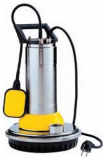
Вертикальные одноступенчатые, полностью затопляемые погружные электронасосы Ama-Drainer для автоматического осушения котлованов, шурфов, подтопляемых дворов и подвалов; для понижения уровня грунтовых вод, дренажа, откачивания воды из подземных переходов; забора воды из рек и резервуаров; удаления сильно загрязненных вод с волокнистыми примесями.
