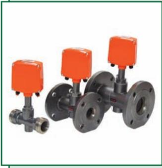
ВПС предназначен для преобразования расхода (объема) холодной или горячей воды, а также других жидкостей с удельной электропроводностью не менее  $2 \times 10^{-3}$  См/м в выходной импульсный электрический сигнал.
