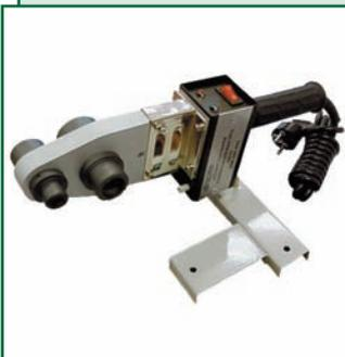
Сварочный аппарат Контур Standart 32, 63, 75 для монтажа полипропиленовых трубопроводов.
