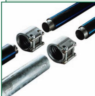
Муфты с жесткой осевой фиксацией для полимерных труб (ПЭ, ПП) и комбинированные для соединения полимерных труб с металлическими. Готовы к монтажу, свободно демонтируются и могут многократно использоваться при повторном монтаже.
