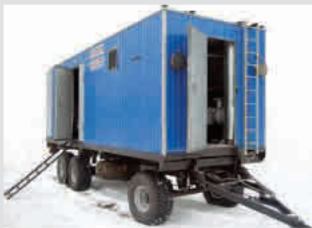
Передвижная котельная на ходовой части
