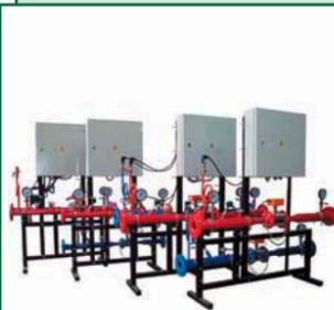
Узлы учета тепловой энергии модульные (УУТЭМ) предназначены для автоматизированного коммерческого учета и оперативного контроля количества тепловой энергии и технологических параметров теплоносителя в водяных системах отопления и горячего водоснабжения.
