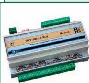
Регистратор предназначен для приема, обработки, анализа и хранения информации, характеризующей хронологию изменения параметров различного рода процессов. Максимальное количество подключаемых внешних устройств – 255. Типы баз данных – периодическая, периодическая по изменениям, оперативный журнал, база аварийных событий, база архивов.
