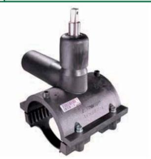
Седелка для врезки под давлением и многократного перекрытия потока среды для бесколодезной установки. Служит для врезки в действующие трубопроводы с давлением до 10 бар (газ) и 16 бар (вода) без утечек и образования стружки. Не требуется дополнительной изоляции. Имеет интегрированный сверло-резак с верхним и нижним упором, перемещающимся по металлической гильзе. Открытый нагревательный элемент для оптимальной теплопередачи.
