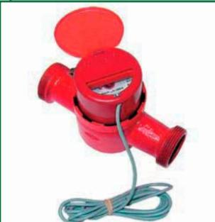
Универсальные счетчики холодной и горячей воды СКБ работают в диапазоне температур от 5 до 90 °С и давлении в трубопроводе до 1,6 МПа. Диаметр условного прохода – 20–40 мм. По заказу потребителя комплектуются герконовым датчиком для дистанционной передачи низкочастотных импульсов.
