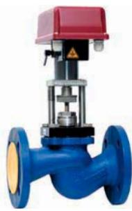
Запорно-регулирующие седельные клапаны ВКСР с электрическим исполнительным механизмом. Назначение – дистанционное управление расходом теплоносителя в системах отопления, вентиляции и горячего водоснабжения. Рабочая среда – вода с температурой до 150 °С и давлением до 1,6 МПа. Диаметры условного прохода – от 15 до 100 мм. Линейная пропускная характеристика.
