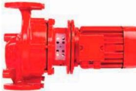
Моноблочный циркуляционный насос системы отопления Etaline предназначен для применения в системах водяного отопления, в контурах охлаждающей воды, системах кондиционирования воздуха, установках хозяйственного водоснабжения и промышленных системах циркуляции.
