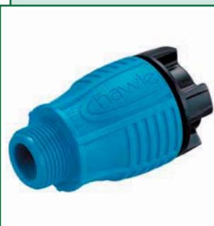
Новое поколение фитингов Hawle Fit было разработано для соединения полиэтиленовых труб наружного диаметра от 25 до 63 мм и для рабочего давления до Ру 1,6 МПа. Область применения – сети питьевого водоснабжения в диапазоне температур до +30 °С.
