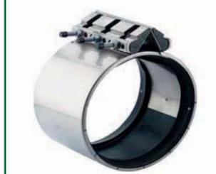
Гидравлический хомут применяется для ремонта и соединения труб, изготовленных из различных материалов и имеющих различный диаметр. Может использоваться в случае несоосности труб до 6°.
