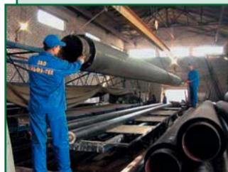
Производство и поставка стальных, предварительно изолированных пенополиуретаном труб с защитной оболочкой из оцинкованной стали для надземной прокладки и с защитной оболочкой из полиэтилена для подземной бесканальной прокладки.
