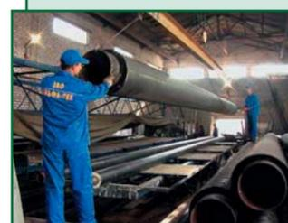
Производство и поставка фасонных изделий с защитной оболочкой из оцинкованной стали для надземной прокладки и с защитной оболочкой из полиэтилена для подземной бесканальной прокладки.
