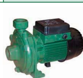
Центробежные насосы DAB K с одним или двумя рабочими колесами предназначены для повышения давления в системах водоснабжения, а также для питания напорных баков. Подходят для установки в спринклерные системы полива или пожаротушения, а также в системы, требующие повышенного давления воды при небольшом расходе.
