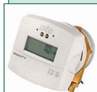
Компактный теплосчетчик "Сенсоник II" – вычислитель, многоструйный расходомер и датчик температуры в одном корпусе. Второй датчик выносной, подключается кабелем, длиной до 3 м. Применяется для учета тепла в квартирах, офисах, коттеджах. Исполнение для подающего или обратного трубопровода. Номинальный расход – 0,6; 1,5; 2,5 м³.
