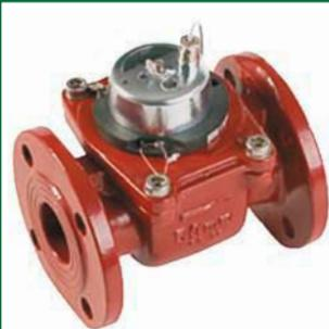
Домовые счетчики холодной и горячей воды MT, WS, WP крыльчатые и турбинные. Номинальный расход – от 0,75 до 250 м<sup>3</sup>. Ду от 20 мм до 200 мм. Возможен монтаж в горизонтальном и вертикальном положении. Оснащены импульсным выходом для подключения к системам дистанционного сбора данных.
