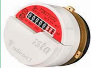
Квартирный счетчик холодной и горячей воды "Истаметр М" патронного типа с многоструйной крыльчаткой. Номинальный расход – 1,5 или 2,5 м<sup>3</sup>. Стабильно работает при малых и очень малых расходах воды. Присоединитель Ду 1/2; 3/4 или 1" с крышкой в комплекте.
