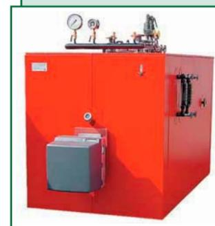
Паровые двухходовые жаротрубные стальные котлы типа Е. Предназначены для производства пара низкого давления, используемого в технологических целях. Паропроизводительность – 0,5 т/ч. Вид топлива – газ, жидкое топливо. КПД котла – 89%.
