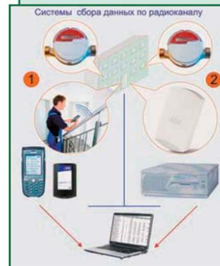
Предоставление ежедневных данных по расходам в виде таблицы Excel. Полный контроль состояния счетчиков. Возможно оснащение радиоблоками ранее установленных квартирных или домовых счетчиков с импульсным выходом.
