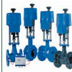
Регулирующий клапан BOA®-CVE C/CS/IMS/EKB применяется в системах водяного отопления с температурой рабочей среды до 120 °С, вентиляции и кондиционирования. Клапан с управляемыми микропроцессорами и "интеллектуальными" электрическими сервоприводами от 1 200 до 14 000 Н, электронное конфигурирование кривой расхода жидкости, установочного сигнала возможно посредством датчика РС.
