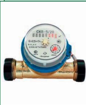
Счетчики СКВ применяются для учета и экономии потребления воды в индивидуальном секторе и системах коммунального и промышленного водоснабжения. Предназначены для измерения объема холодной воды при температуре не выше 40 °С и давлении не более 1 МПа.
