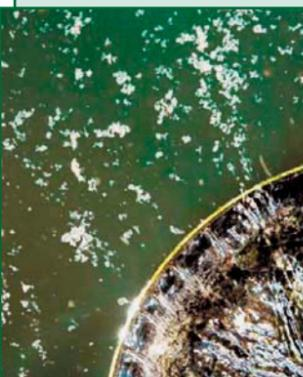
Фильтр полимерный с фильтрующей загрузкой из синтетического материала в виде легко сжимающихся шариков диаметром 50 мм способен задерживать частицы размером от 0,005 мм и выше.
