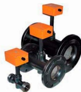
ВПС предназначен для преобразования расхода (объема) холодной или горячей воды, а также других жидкостей с удельной электропроводностью не менее  $2 \times 10^{-3}$  См/м в выходной импульсный электрический сигнал.
