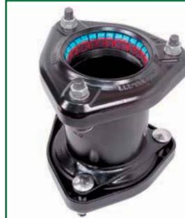
Специальные муфты UltraGrip предназначены для соединения труб разных диаметров и из разных материалов: чугуна, стали, ПВХ, ПЭ в различных сочетаниях и без дополнительных приспособлений. Возможно использование в сложных погодных условиях: высокая влажность, низкая температура.
