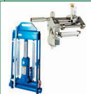
Профессиональный инструмент для монтажа ПЭ труб при помощи фитингов с закладным нагревательным элементом производства Caldervale Technology (Англия).
