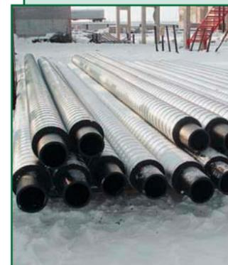
Трубы и фасонные изделия полиэтиленовые с тепловой изоляцией из пенополиуретана с защитной оболочкой ТУ СТО 471 14136-002-2006.
