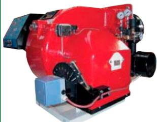
Горелки серии РВУ работают на тяжелых видах жидкого топлива с вязкостью до 16 °Е при 80 °С, с содержанием воды до 30% и механических примесей. Применяется пневматическое распыление топлива с помощью сжатого воздуха (от компрессора) или пара с целью достижения большей эффективности его сжигания.
