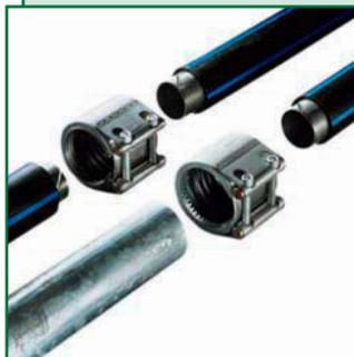
Муфты с жесткой осевой фиксацией для полимерных труб (ПЭ, ПП) и комбинированные для соединения полимерных труб с металлическими. Готовы к монтажу, свободно демонтируются и могут многократно использоваться при повторном монтаже. Поставляются в диапазоне диаметров от 40,0 до 355,0 мм (большие диаметры по запросу). Позволяют компенсировать угловое смещение
