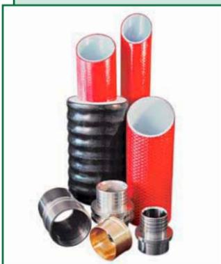
Запатентованные гибкие трубы повышенной надежности "ИЗОПРОФЛЕКС®-А" предназначены в первую очередь для подземной бесканальной прокладки сетей горячего водоснабжения и отопления с рабочей температурой 115 °С и максимальным рабочим давлением 1,0 МПа.
