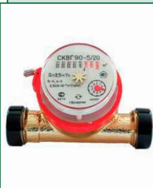
Счетчики СКВГ применяются для учета и экономии потребления воды в индивидуальном секторе и системах коммунального и промышленного водоснабжения. Предназначены для измерения объема как горячей, так и холодной воды при температуре от 5 до 90 °С и давлении не более 1 МПа.
