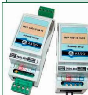
Коммутатор предназначен для подключения сегментов сетей интеллектуальных устройств к общей линии RS-485/CAN с различными протоколами и скоростями обмена. Применение коммутатора позволяет повысить надежность системы в целом за счет сегментирования отдельных участков ее сети. Повреждение отдельных участков при этом не приводит к неисправности сети в целом.
