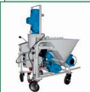
Штукатурная станция SMZ 120G предназначена для приготовления, транспортировки и нанесения строительных растворов при проведении внутренних и наружных отделочных работ готовыми сухими смесями (гипс/гипсоизвестковая штукатурка, наливные полы, клеевые смеси и т. д.). Производительность – 1,2/2,4 м³/ч. Дальность подачи – до 40 м. Мощность электродвигателя – 5,5 кВт. Объем загрузочного бункера – 110 л.
