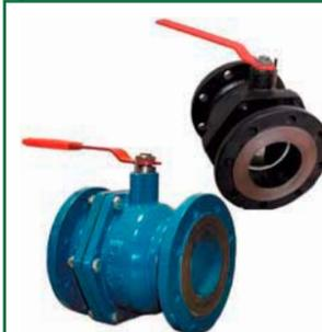
Шаровой кран фланцевый 11ч 37 Пф-4, 11с 37 Пф-4 применяется в качестве запорного устройства на трубопроводах для воды и пара (температура рабочей среды до +200 °С, PN 1,6–2,5 МПа); на объектах газового хозяйства (температура природного, топливного газа до +100 °С, PN 0,6 МПа); для масла и нефтепродуктов (температура рабочей среды до +90 °С) и др. слабоагрессивных сред. Подача рабочей среды в любом направлении.
