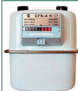
Счетчики газа типоразмеров СГК-1,6; СГК-2,5; СГК-4 предназначены для измерения объема природного и сжиженного газа в квартирах и частных домах, оборудованных газовыми плитами, газовыми водонагревательными колонками, водонагревательными котлами. Порог чувствительности счетчиков не превышает 3 л/ч, что позволяет контролировать работу любых типов бытовых горелок и фитилей на самом малом уровне горения.
