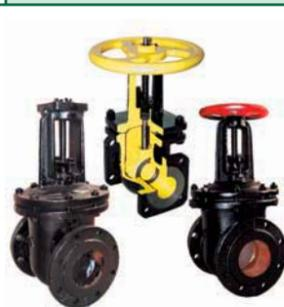
Применяется в качестве запорного устройства на трубопроводах для воды и пара (30ч 6бр), газопроводах (30ч 7бк), масло-нефть (30ч 6бк). Температура рабочей среды задвижки 30ч 6бр – до +225 °С, PN 1,6 МПа (16 атм). Подача рабочей среды в любом направлении. В корпус и диски завальцованы латунные уплотнительные кольца. Присоединение к трубопроводу – фланцевое. Затвор – кран с двумя параллельными дисками.
