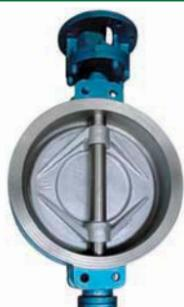
Затворы дисковые трехэксцентриковые запорно-регулирующие ТУ 3741-029-29012225-2007. Серия ВА 99017. Класс герметичности по ГОСТ 9544 – А. DN 50–2 400. PN 6–100. Применяются в качестве запорных и регулирующих устройств на трубопроводах общепромышленного назначения и объектах, подконтрольных Ростехнадзору.
