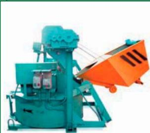
Бетоносмесители предназначены для приготовления бетона и строительных растворов, состоящих из цемента, наполнителей, твердых добавок и воды. Бетоносмесители гравитационные. Производительность – 100–1 200 л. Мощность – 0,7–10 кВт. Бетоносмесители с принудительным перемешиванием. Производительность – 250–1 500 л. Мощность – 7,5–37 кВт. Всегда в наличии бетоносмесители от 100 до 500 л. В продаже бетоносмесители марки СБР производства России.
