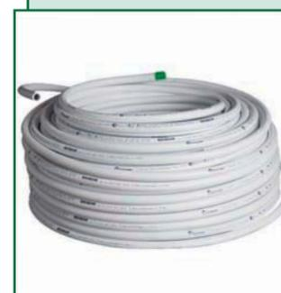
Металлопластиковые трубы ALTSTREAM (Италия). Предназначены для создания систем центрального и индивидуального отопления и водоснабжения в жилых, общественных, административных и промышленных зданиях. Производятся на современном оборудовании, с полным пооперационным контролем качества. Диаметр труб – 16; 20; 26; 32 мм. Выпускаются в бухтах по 50; 100; 200 м. Срок службы – не менее 50 лет. Продукция сертифицирована и застрахована в страховой группе «УРАЛСИБ».
