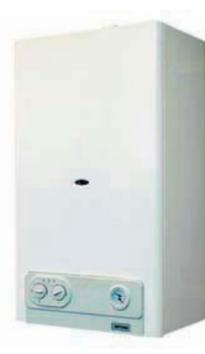
Аппарат отопительный газовый бытовой с водяным контуром и закрытой камерой сгорания АОГВ-24-1, АОГВ-30-1 предназначен для поквартирного отопления жилых многоэтажных зданий и индивидуальных жилых домов, оборудованных системами водяного отопления закрытого типа и получения горячей воды для хозяйственных нужд. Аппарат имеет герметичную камеру сгорания, вследствие чего полностью герметичен от среды помещения: забор воздуха для горения и выброс продуктов сгорания осуществляются вне помещения.
