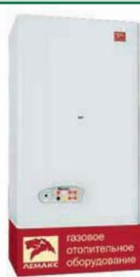
Современный настенный газовый котел "ЛЕМАКС" предназначен для отопления жилых помещений и горячего водоснабжения, идеален для квартир и других помещений. Максимальная мощность – 24 кВт. КПД – 93%. Варианты с искусственной и естественной тягой. Два монотермических теплообменника. Циркуляционный насос Grundfos (Дания).
