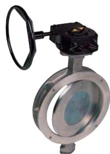
Поворотные затворы применяются в качестве как перекрывающей, так и регулирующей арматуры. Поворотный затвор герметично перекрывает поток в оба направления. Диск затвора имеет двойной эксцентриситет. Корпус затвора серии 41000 – увеличенной установочной длины. Затвор серии 411 отличается более компактной конструкцией. Привод может быть легко установлен на монтажный фланец затвора, стандартизированный по ISO.
