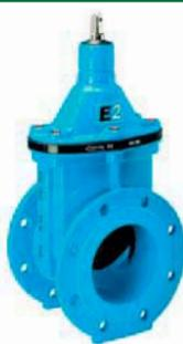
Упругозапирающаяся клиновидная задвижка E2 с гладким проходным каналом. Область применения – сети питьевого водоснабжения с допустимой рабочей температурой до +40 °С. DN 50–600.
