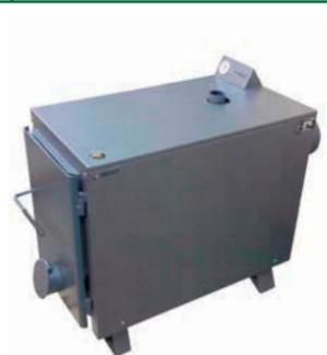
Твердотопливные котлы WARMOS-ТТ выпускаются двух видов. WARMOS-ТТ 18К и 25К дополнительно комплектуются регулятором тяги для автоматического регулирования доступа воздуха в камеру сгорания, ТЭНом с термостатом и термоограничителем для поддержания температуры воды. Диапазон регулирования тепловой мощности от минимальной (не более 30% номинальной) до номинальной.
