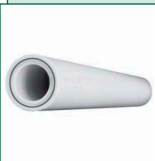
Трубы Master pipe® изготовлены из полипропилена, армированного перфорированной алюминиевой фольгой. Предназначены для монтажа систем холодного, горячего водоснабжения и отопления. Диаметр – от 20 до 32 мм.
