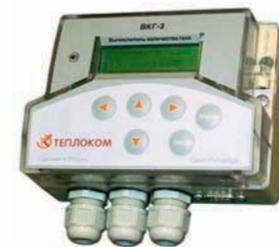
Вычислители ВКГ-3 предназначены для преобразований выходных сигналов измерительных преобразователей температуры, давления и объема газа в их показания и определения объема газа, приведенного к стандартным условиям, при контроле и учете потребления природного газа.
