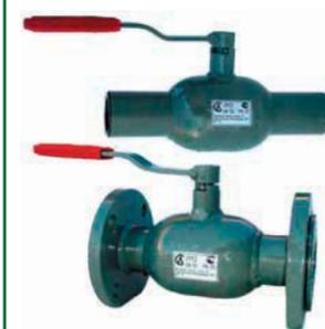
Шаровой кран фланцевый сварной предназначен для установки в качестве запорного устройства на трубопроводах для воды и пара (температура рабочей среды до +200 °С, PN 1,6–2,5 МПа); на объектах газового хозяйства (температура природного, топливного газа до +100 °С, PN 0,6 МПа); для масла и нефтепродуктов (температура рабочей среды до +90 °С) и др. слабоагрессивных сред. Подача рабочей среды в любом направлении.
