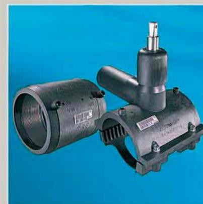
Каждому специалисту понятно: большая длина вставки трубы в фитинг ведет к лучшей компенсации деформаций трубы и равномерному распределению давления расплава. В результате мы получаем большую надежность процесса сварки и большую прочность соединения.
