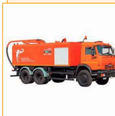
Комбинированные машины КО-560, КО-560А с илососным и каналопромывочным оборудованием предназначены для профилактической санитарной очистки колодцев и трубопроводов городской ливневой канализации от ила, грунтовых наносов и других загрязнений, а также ликвидации в них аварийных засоров.
