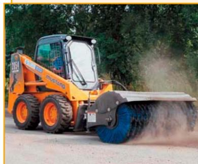
Универсальный мини-погрузчик Mustang-2054 (США) с подметальной щеткой. Компактен, легко проходит по узким тротуарам и не создает помех при уборке в любое время года. Где нет доступа тракторам, там доминирует мини-погрузчик. Дизельный двигатель – Yanmar (Япония). Объем двигателя – 2,2 л.
