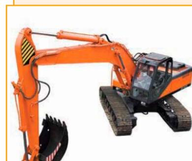
Гидравлический гусеничный экскаватор ЭО-41211 (перспективная модель) предназначен для разработки грунтов I–IV категорий, а также предварительно разрыхленных скальных и мерзлых грунтов V–VI категорий. Используется для проведения земляных работ среднего объема в дорожном и коммунальном строительстве.
