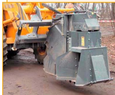
Дисковая фреза VENIERI (Италия) предназначена для пропила бетона и асфальта во время проведения дорожных работ и прокладки инженерных сетей.
