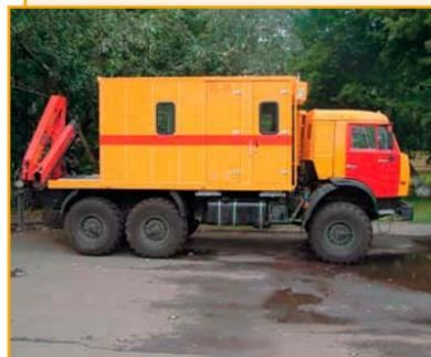
Автомобили аварийно-технической службы с кран-манипуляторами предназначены для выполнения работ и ликвидации аварий на объектах ЖКХ.
