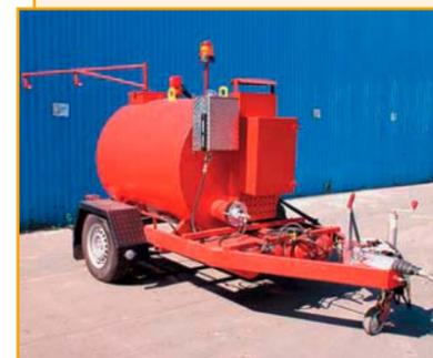
Заливщик швов ЭД-235М предназначен для приема, поддержания рабочей температуры и розлива горячих герметизирующих материалов в швы и трещины дорожных покрытий, грунтовок карт при производстве ремонтных работ.
