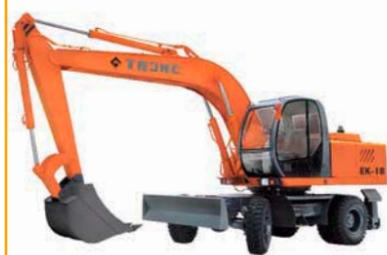
Экскаватор EK-18 – многоцелевая землеройная машина. Предназначен для разработки котлованов, траншей, карьеров в грунтах I-IV категорий, погрузки и разгрузки сыпучих материалов, разрыхленных скальных пород и мерзлых грунтов (при величине кусков не более 200 мм). Отличается высокой производительностью.
