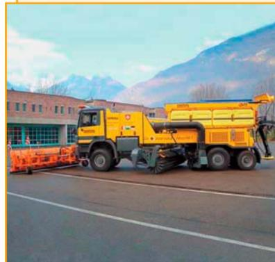
Высокоскоростная машина BOSCHUNG Jetbroom для круглогодичного содержания автобанов, магистральных дорог и аэродромов.
