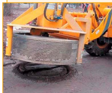
Фреза для вырезания люков для спецтехники VENIERI (Италия) – это навесное оборудование, позволяющее механизировать, существенно ускорить и сделать более качественным процесс установки и ремонта канализационных люков при реконструкции инженерных сетей.
