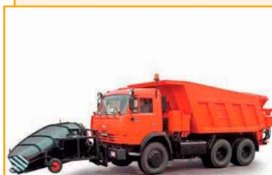
Машина дорожная универсальная СДК-65115 изготавливается на автомобилях-самосвалах заказчика, находящихся в эксплуатации.
