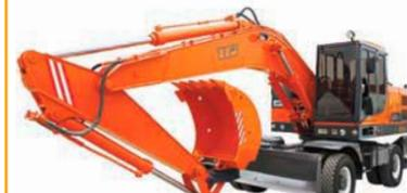
Колесный экскаватор ЭО-33211А предназначен для разработки мерзлых грунтов I-IV категорий, а также предварительно разрыхленных скальных и мерзлых грунтов с величиной кусков не более 200 мм. Эксплуатируется в диапазоне температур от -40 до +40 °С. Эксплуатационная масса – 18 000 кг.
