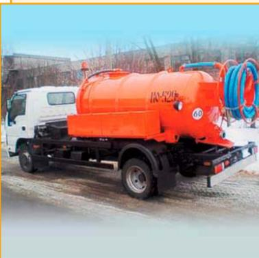
Машины ассенизационные (вакуумные) серии КО-529 предназначены для вакуумной очистки выгребных ям и канализационных колодцев, транспортирования и выгрузки в местах утилизации жидких отходов, не содержащих горючих и взрывоопасных веществ.
