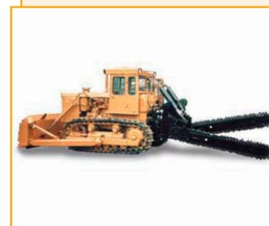
Траншеекопатели БР-01, БР-01-300, БР-00 предназначены для прорезания щелей в мерзлых и твердых грунтах IV–V категорий. Базовый трактор – Т-10 (Т-170) (гусеничный). Ширина прорезаемых траншей – 140, 300 мм. Глубина прорезаемых траншей – до 1 800 мм. Категория грунтов – I–V. Количество режущих органов – 1 или 2.
