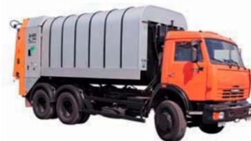
Мусоровозы с задней загрузкой КО-440К20, КО-440К15, КО-440К8, КО-440П8, КО-440R1 предназначены для механизированного сбора твердых бытовых отходов из металлических и пластмассовых контейнеров всех типов объемом до 1,1 м³, их уплотнения, транспортирования и механизированной выгрузки в местах утилизации.
