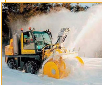
Высокотехнологичный, высокопроизводительный, безопасный и комфортабельный фрезерно-роторный снегоочиститель BOSCHUNG Snowbooster B6 последнего поколения для уборки снежных валов с дальностью прямого выброса снега на расстояние до 50 м. Гидравлически поворачиваемый метательный патрубок из нержавеющей стали с крышкой для регулировки направления выброса снега может обеспечивать погрузку
