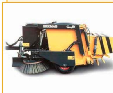
Подметально-уборочная машина Bemab (Швеция) буксируется любым трактором, в т. ч. отечественного производства. Предназначена для уборки малых территорий, тротуаров, торговых площадей, дворов. Механическая система подбора смета с увлажнением. Низкие затраты на техническое обслуживание.
