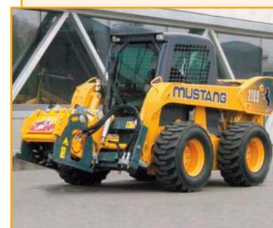
Универсальный мини-погрузчик Mustang-2109 (США) с дорожной барабанной фрезой. Рабочая ширина – от 350 до 1 000 мм. Незаменимый помощник при ямочном ремонте и реконструкции дорог.
