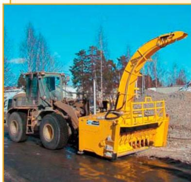
Снегоочиститель Arctic Machine 2500 устанавливается на стрелу колесного фронтального погрузчика (вместо ковша). Для установки подходят фронтальные колесные погрузчики грузоподъемностью от 3,7 т, собственной массой от 7 т.
