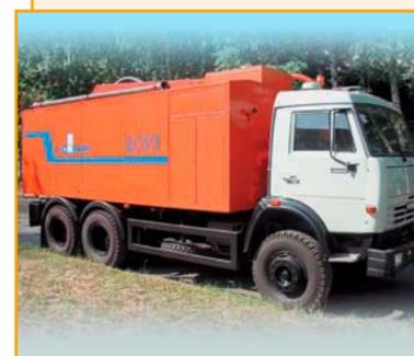
Комбинированная каналочистительная машина серии КО-564 предназначена для механизированной очистки трубопроводов ливневой и канализационной сетей от засоров, очистки заполненных канализационных колодцев, выгребных ям и отстойников от ила, песка и иных отложений и вывоза их к месту утилизации.
