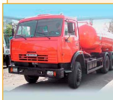
Илососные машины для вакуумной очистки колодцев, ливневой и канализационной сетей от ила и транспортировки его к месту выгрузки.
