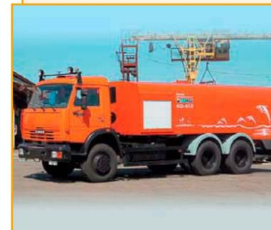
Каналопромывочные машины для очистки ливневых канализационных труб от осадков и засоров.
