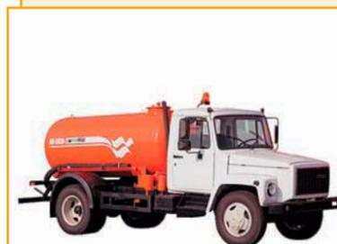
Вакуумные машины КО-522А (Б, Г), КО-503В, КО-503В-3, КО-515А, КО-520, КО-505А, КО-523 предназначены для вакуумной очистки выгребных ям и транспортировки фекальных жидкостей к месту утилизации. Специальное оборудование состоит из цистерны, вакуумного насоса с приводом, сигнально-предохранительного устройства, приемного лючка с всасывающим шлангом, кранов управления с трубопроводом, дополнительного электрооборудования.
