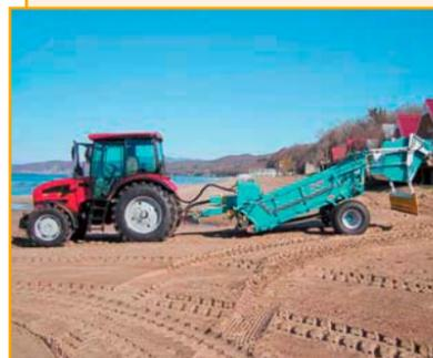
Буксируемая трактором машина для уборки пляжей Beach Tech 2800 адаптирована для использования с большинством тракторов зарубежного и отечественного производства. Применяется для уборки пляжей с любым рельефом. Сбор мусора от мелких фракций (пробки, окурки) до крупных камней, работа у кромки
