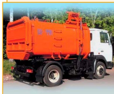
Мусоровозы серии КО-449 с боковой загрузкой с кузовом прямоугольной формы предназначены для механизированной погрузки из стандартных контейнеров емкостью 0,75–1,1 м³ твердых бытовых отходов, их уплотнения, транспортирования и механизированной выгрузки в местах утилизации.
