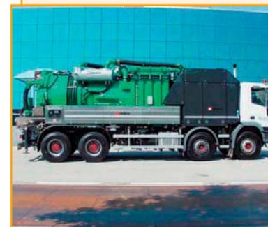
Вакуумные погрузчики Мого предназначены для специальных погрузочных работ твердых, порошкообразных, жидких и полужидких отходов. Применяются для уборки щебня, сухой или мокрой почвы, седимента, различных смесей, очистки дренажных каналов, отверстий, канализационных трубопроводов, седиментационных ям, дренажных каналов, труднодоступных мест на обо-
