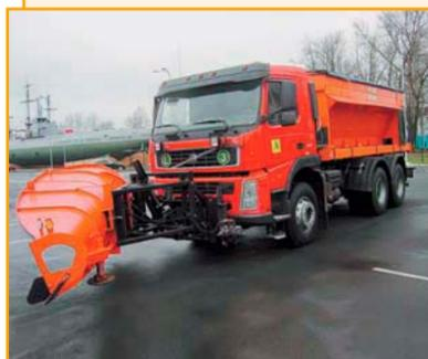
Машина дорожная комбинированная БАС-10Д предназначена для всесезонного содержания скоростных федеральных и региональных автомобильных дорог с твердым покрытием. Модель шасси – VOLVO FM-13. Колесная формула – 6 × 4.
