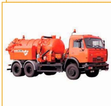
Илососные машины КО-510 (Д, К), КО-524, КО-507А-2, КО-507АМ (А3) предназначены для вакуумной очистки колодцев, ливневой и канализационной сетей от ила и транспортировки его к месту выгрузки.
