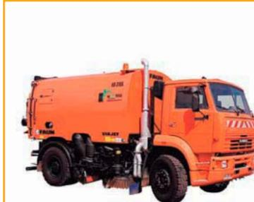
Вакуумные подметально-уборочные машины КО-316А, КО-316Б предназначены для автоматизированной летней уборки дорожных покрытий с увлажнением подметаемой поверхности, поглощением пыли, транспортированием смета и его механизированной разгрузки. На машину КО-316А устанавливается навесное подметально-вакуумное оборудование VIAJET фирмы FAUN (Германия).
