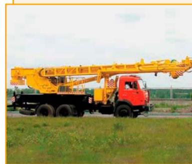
Автокран "МОТОВИЛИХА" представляет собой уникальную машину, которая работает как подъемник и как кран грузоподъемностью 25 т. При работе с люлькой для подъема людей высота подъема составляет 37 м, грузоподъемность люльки – 300 кг.
