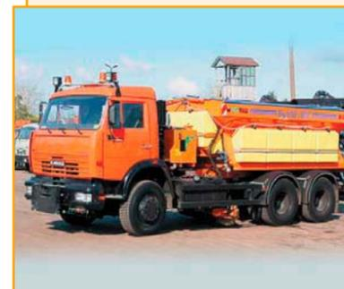
Пескоразбрасыватели для сметания мусора и снегоочистки городских дорог с усовершенствованным покрытием, а также для посыпки инертными материалами или антигололедными реагентами поверхности дорожного полотна.
