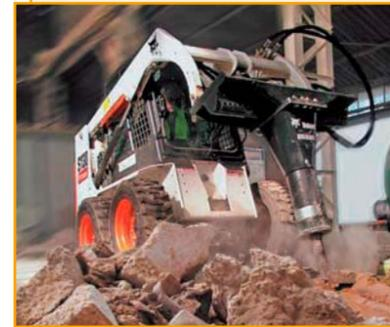
Гидромолот Bobcat предназначен для сноса бетонных конструкций и земляных работ, включая рытье траншей. Имеет раму цилиндрической конструкции, облегчающую доступ к труднодоступным объектам. Оснащен системой звукоизоляции. Отличается высокой производительностью. Удобен и надежен в эксплуатации. Не требует дополнительных затрат в обслуживании.
