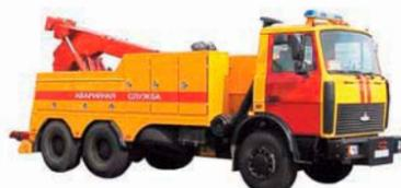
Эвакуаторы неисправных автобусов, троллейбусов и большегрузных транспортных средств типа ЭТС грузоподъемностью от 4 до 8 т предназначены для транспортировки неисправного транспортного средства методом полупогрузки на гидроприводном транспортирующем устройстве или буксировкой на жесткой сцепке, а также вытаскивания, локального перемещения и позиционирования.
