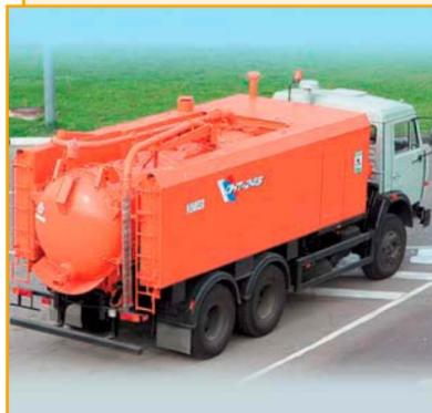
Комбинированные машины совмещают каналопромывочное и илососное оборудование, что позволяет производить аварийную и профилактическую прочистку канализационных и водосточных сетей высоконапорной мойкой и откачкой загрязнений. Разрежение в цистерне создается насосом высокого давления с помощью водовоздушного эжектора.
