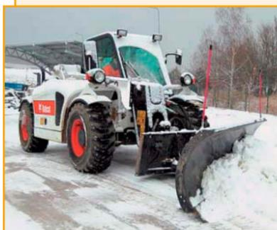
Снежный отвал Bobcat – прекрасный инструмент для быстрой уборки небольшого или среднего снежного покрова с тротуаров и проезжей части. Может поворачиваться в обе стороны на 30°. Хороший обзор позволяет следить за положением углов отвала.
