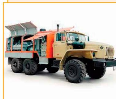
Передвижная компрессорная станция ПКС-7/100 на шасси автомобиля "Урал-5557-40" предназначена для проведения работ по ремонту и освоению нефтяных скважин, а также наполнения в полевых условиях воздухом баллонов до давления 100 кгс/см<sup>2</sup>, очистки, продувки, опрессовки трубопроводов при температуре окружающего воздуха от -45 до +40 °С.
