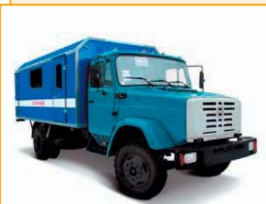
Передвижная аварийная водопроводно-канализационная мастерская предназначена для выполнения ремонтных работ на трубопроводах различного назначения: водопроводах, теплотрассах, безнапорных трубопроводах (канализация).
