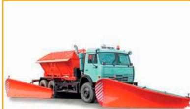
Машина дорожная комбинированная МДК-53229 предназначена для круглогодичного ухода за дорогами с твердым покрытием всех категорий. Базовое шасси – КАМАЗ-65115-62, КАМАЗ-65115-97, КАМАЗ-53229. Колесная формула – 6 × 4. Тип двигателя – дизельный. Модель – КАМАЗ-740.62-280/Cummins 6ISBe285.
