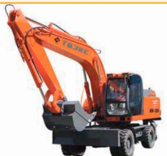
Экскаватор нового поколения EK-20-20. Увеличена производительность машины за счет применения более производительной насосной установки и более мощного двигателя. Рабочее оборудование оптимизировано, что позволило увеличить параметры копания и уменьшить габариты экскаватора по высоте. Все гидроцилиндры рабочего оборудования снабжены демферами, исключены удары
