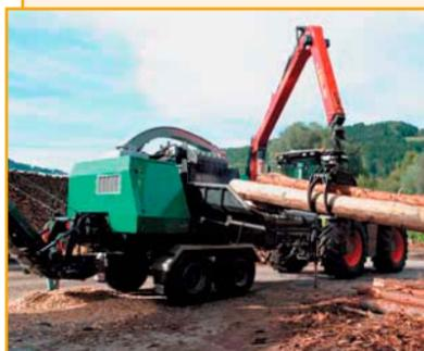
Установка ШИРРО 500 производства компании КОМПТЕЧ (Австрия) представляет собой дробилку барабанного типа с приводом от трактора для измельчения срезанных ветвей и древесных стволов. Активная система подачи измельчаемого материала, две скорости вращения барабана и возможность выгрузки материала посредством патрубка с нагнетателем или ленточного конвейера придают установке совершенство и универсальность.
