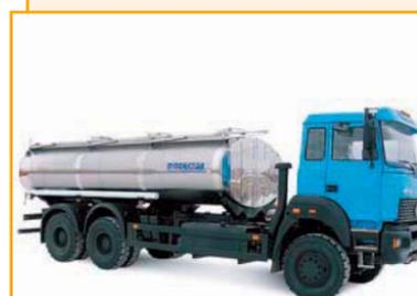
Автоцистерна 46151-02 (АЦПТ-13) на базе шасси "Урал-63685-6111-21". Предназначена для транспортирования и кратковременного хранения пищевых жидкостей в условиях, предназначенных для изделий, изготовленных по I категории ГОСТ 15150-69 в климатическом исполнении "У".
