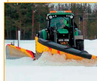
Применение бокового отвала Arctic Machine 207 на тракторе с одновременным использованием переднего отвала позволяет увеличить ширину уборки и сократить количество проходов. Обеспечивает эффективность и рентабельность работ по содержанию дорог.
