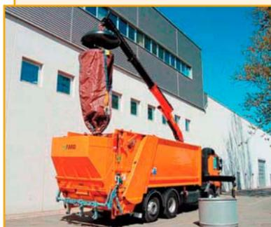
Мусоровоз Farid T1 20 UG предназначен для механизированной загрузки твердых бытовых отходов, уплотнения, транспортировки к местам утилизации и захоронения ТБО.
