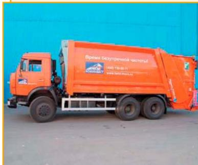
Большегрузный мусоровоз FARID серии T1 с задней загрузкой спроектирован для механизированного и ручного сбора твердых бытовых отходов, уплотнения, транспортирования и механизированной загрузки в местах утилизации.
