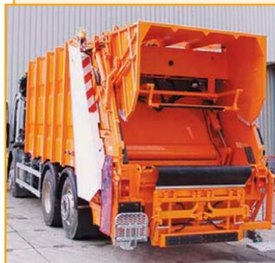
Мусоровозы ZOELLER MEDIUM XL с краново-манипуляторной установкой на шасси SCANIA предназначены для селективного сбора отходов и обслуживания специальных контейнерных систем и заглубленных емкостей типа MOLOK.
