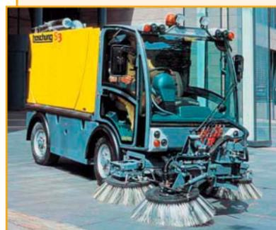
Подметально-вакуумная машина BOSCHUNG S3 отличается максимальным для своего класса бункером для смета из нержавеющей стали. Оснащается бесступенчатым гидростатическим приводом и подключаемым на все четыре колеса рулевым управлением. Машина может комплектоваться поливомоечной установкой, водяным пистолетом и ручным всасывающим патрубком.
