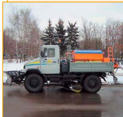
Полноприводная комбинированная уборочная машина КМСД-1 на шасси ЗИЛ-43272Т предназначена для летней и зимней уборки дорог, улиц и проездов в стесненных условиях города, мойки придорожных разделительных ограждений и придорожных сооружений, поливки зеленых насаждений или обработки их специальными составами.
