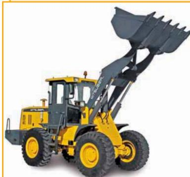
Погрузчик MITSUBER ML 333N Stuttgart – высокопроизводительная машина для землеройных и планировочных работ, погрузки различных материалов: грунтов, горных пород, песка, щебня, древесины.
