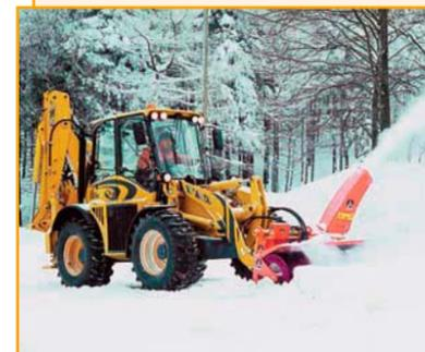
Роторные снегометатели различной мощности и производительности. Позволяют эксплуатировать погрузчики и экскаваторы-погрузчики производства фирмы VENIERI (Италия) и в зимний период. Различные модели снегометателей могут убирать как рыхлый свежеснеживший, так и плотный слежавшийся снег. Возможен выбор моделей как для уборки дворов и тротуаров, так и дорог общего пользования и шоссе.
