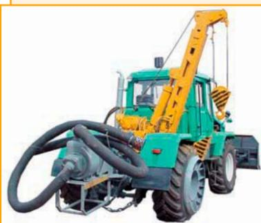
Производство трубоукладчиков на базе гусеничных тракторов ДТ-75 и Т-10М, а также на базе колесного трактора Т-150К (ХТЗ, ХТА). Базовый трактор – Т-150К (ХТЗ, ХТА колесный). Грузоподъемность – 3,2 т. Высота подъема крюка – 4,0 м. Основные функции:
