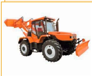
Трактор РТ-М-160У с фронтальным погрузчиком предназначен для погрузочно-разгрузочных и транспортных работ по перевозке сыпучих материалов; перемещения грузов; для земляных работ, а также работ по планировке площадок, засыпке траншей, ям и очистке проезжей части улиц и площадей. Максимальная высота подъема ковша – 4 500 мм. Максимальная высота разгрузки – 3 470 мм.
