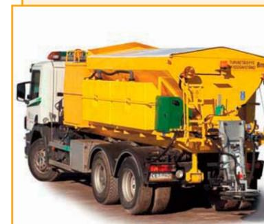
Распределители Arctic Machine серии 3000 предназначены для распределения песка и песко-солевой смеси. Широкий ассортимент позволяет выбрать оптимальный вариант под необходимое шасси.
