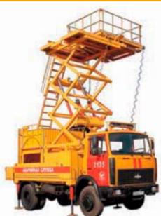
Аварийно-техническая машина АТМ-0,5/7 предназначена для обслуживания и ремонта контактной сети трамваев и троллейбусов с номинальным напряжением до 600 В в условиях интенсивного транспортного потока, а также под мостами, эстакадами и в тоннелях. Высота подъема – 8,5 м, боковое смещение рабочей площадки – 1,2 м, оснащена устройствами подъема грузов до 200 кг и перевоз-
