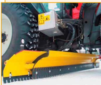
Средние отвалы Arctic Machine расширяют возможности базового трактора при проведении работ по содержанию дорог. Устанавливаются под базу трактора мощностью от 120 л. с. между передней и задней осью. Применяются для уборки снега, удаления ледяного наката, а также для обработки и планирования поверхностного слоя грунтовых дорог.
