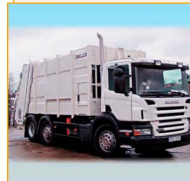
Мусоровозы ZOELLER MEDIUM и MEDIUM XL на шасси SCANIA – оптимальны для сбора, уплотнения и транспортировки отходов в тесненных городских условиях: задняя загрузка не требует маневрирования при подъезде к контейнерной площадке, подъемные механизмы позволяют работать со всеми типами мусорных контейнеров.
