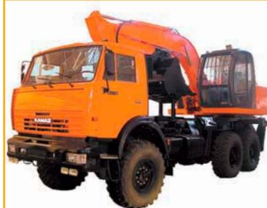
Одноковшовый экскаватор EA-17K на шасси автомобиля КАМАЗ. Новая гидравлическая схема. Рабочее оборудование, поворотная платформа от экскаватора EK-12. Накладная рама увеличенной прочности.
