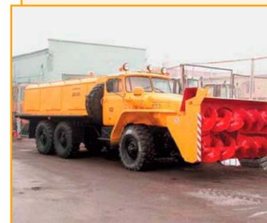
Снегоочиститель шнекороторный АМКОДОР 9531-03 предназначен для очистки от снега взлетно-посадочных полос, рулевых дорожек, мест стоянок самолетов, вертолетов, подъездных путей к аэродромам, автомагистралей, а также для отбрасывания валов, образованных другими снегоочистителями.
