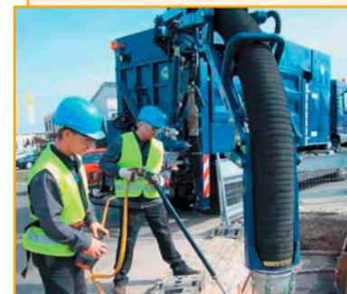
Вакуумный погрузчик МТС (Германия) – автономное транспортное средство на базе автомобилей VOLVO, MAN, IVECO с высокопроизводительной турбиной, вспомогательным пневматическим инструментом и контейнером объемом до 12 м<sup>3</sup>. Используется для быстрых и качественных раскопок трубопроводов в городских условиях. Не повреждает находящиеся рядом коммуникации и не загрязняет дороги и тротуары.
