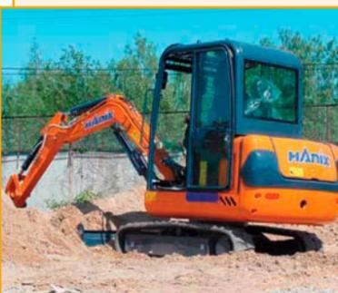
Мини-экскаватор Hanix H15B Plus (Япония) незаменим в городском хозяйстве. Компактен, используется в стесненных городских условиях, на узких старинных улочках. Оказывает низкое давление на грунт, имеет очень быстрый цикл землеройных работ. Двигатель – Mitsubishi L3E. Номинальная мощность – 12,5 кВт/17 л. с.
