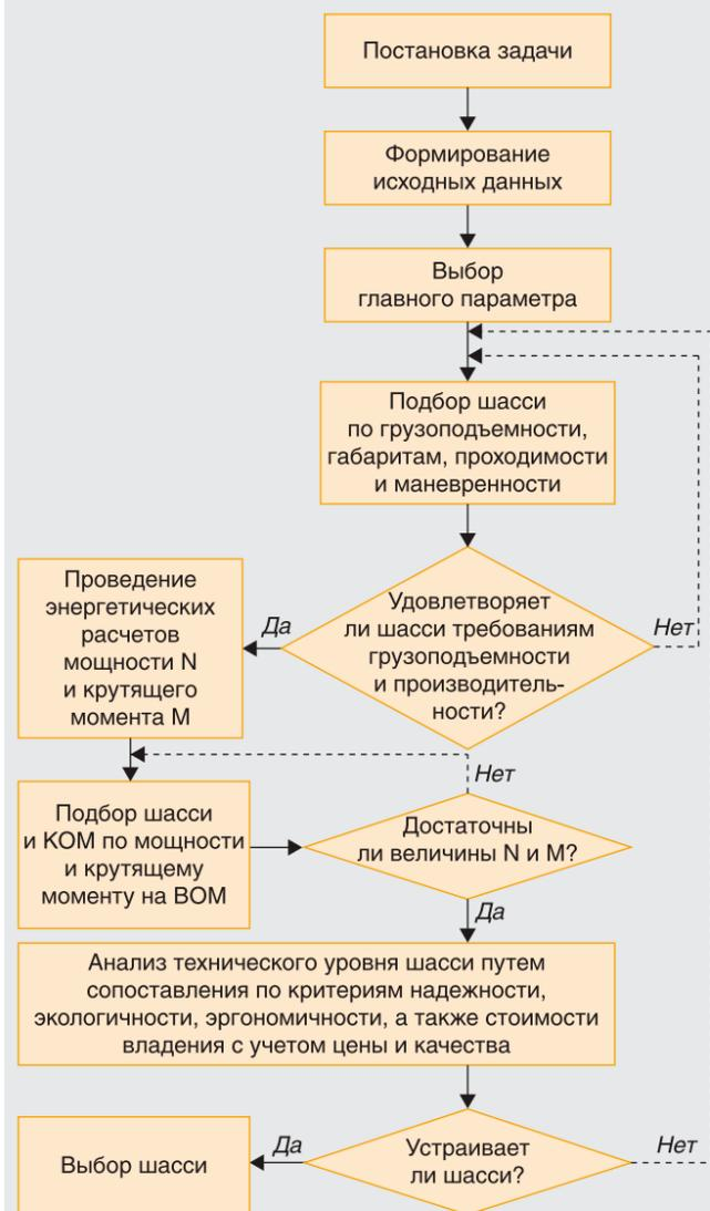
1. Формирование исходных данных с учетом назначения создаваемой машины (тип машины см. рис., класс – прил. 1, проектные параметры – прил. 2), условий ее эксплуатации, финансовых и иных ограничений.
