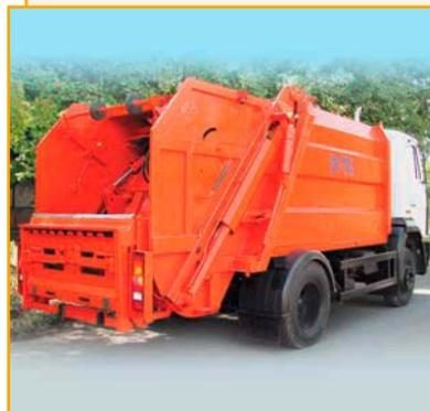
Мусоровозы с задней загрузкой кузова серии КО-456 предназначены для механизированного (из контейнеров объемом 0,12–1,1 м³) и ручного сбора твердых бытовых отходов, их уплотнения, транспортирования и механизированной разгрузки в местах утилизации.
