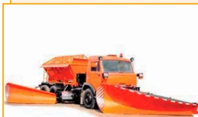
Машина дорожная комбинированная МДК-53215 предназначена для круглогодичного ухода за дорогами с твердым покрытием всех категорий. Изготавливается на шасси автомобилей заказчика, находящихся в эксплуатации. Базовое шасси – КАМАЗ-53215 (6 × 4). Тип двигателя – дизельный.
