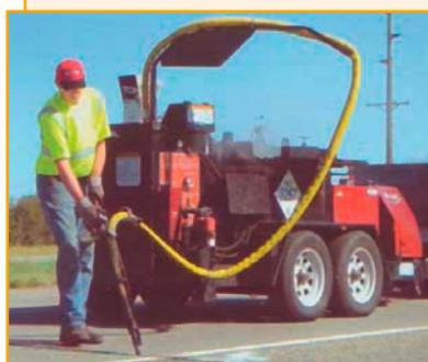
Плавильно-заливочные машины Cimline (США) серии MAGMA предназначены для разогрева и поддержания требуемой температуры мастики, подачи ее под давлением в герметизируемый участок трещины или шва. Нагрев мастики производится через термальное масло. Постоянное перемешивание и равномерный разогрев по всему объему бака. Подогрев в шлангах.
