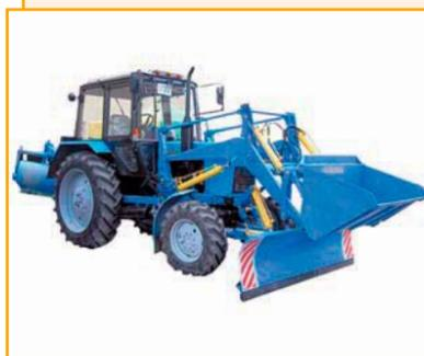
Машины уборочные универсальные КО-812-1, КО-707-1 предназначены для очистки улиц, дорог, тротуаров, строительных площадок и других участков от мусора, снега, песчаных наносов методом сгребания и погрузки в транспортные средства. Тип базового трактора – МТЗ-82.1. Вместимость основного ковша – не менее 0,5 или 0,8 м<sup>3</sup>. Ширина захвата:
