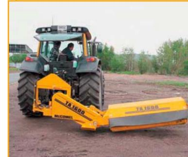
Высокопроизводительная механическая косилка McCONNEL TA 1600 с ножами молоткового типа используется для скашивания травостоя на обочинах и откосах дорожного полотна. Расположение только правостороннее. Минимальная мощность двигателя трактора – 45 л. с. Привод от заднего ВОМ. Количество оборотов ВОМ – 540/1 000 об/мин.
