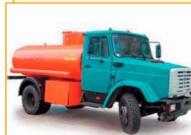
Автотопливозаправщики АТЗ 7-433362, АТЗ 7-432932 предназначены для транспортирования, кратковременного хранения и механизированной заправки различной техники светлыми нефтепродуктами, а также для перекачки топлива из одной емкости в другую, минуя собственную. Базовое шасси – ЗИЛ-433362/ЗИЛ-432932 (4 × 2). Тип двигателя – карбюраторный/дизельный.
