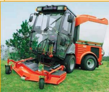
Вакуумная подметальная машина Hako-Citymaster 1200 (Германия) в комбинации с газонокосилкой и системой для сбора скошенной травы незаменима для содержания в идеальном состоянии газонов большой площади.
