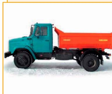
Автомобили-самосвалы ЗИЛ-СААЗ-4545, ЗИЛ-СААЗ-454510 предназначены для перевозки и механизированной разгрузки строительных и навалочных грузов. Базовое шасси – ЗИЛ-494560/ЗИЛ-497442 (4 × 2). Тип двигателя – карбюраторный/дизельный. Модель двигателя – ЗИЛ-508300/ММЗ Д-245.9.
