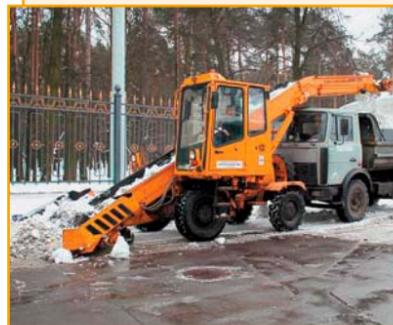
Машины погрузочные универсальные АМКОДОР 37 и АМКОДОР 37-01 предназначены для погрузки в транспортные средства свежеснежавшего, уплотненного снега и сколотого льда, предварительно собранных в валы и кучи, а также для других работ с помощью сменных рабочих органов.
