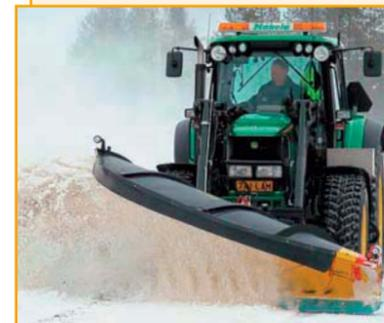
Отвалы Arctic Machine серии D устанавливаются на базовые тракторы мощностью от 120 л. с., в том числе МТЗ 1221, МТЗ 2022, а также на стрелу фронтального погрузчика, стрелу трактора или на его раму.
