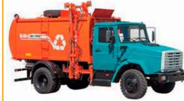
Мусоровозы с боковой загрузкой КО-440-4, КО-440-4К, КО-440-5, КО-440-6, КО-440-7, КО-440-8 предназначены для механизированной загрузки, уплотнения, транспортировки и выгрузки твердых бытовых отходов.
