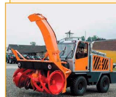
Мощный фрезерно-роторный снегоочиститель ZAUGG Rolba 1500 предназначен для уборки перевалов и территорий аэродромов. Колесная база – 2 300 мм. Колея – 1 660 мм. Производительность – 3 500 т/ч.
