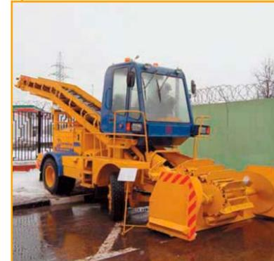
Шнекороторный снегопогрузчик СнП-18 предназначен для погрузки снега, снола и других сыпучих материалов в кузов автомобиля-самосвала через кабину или задний борт.
