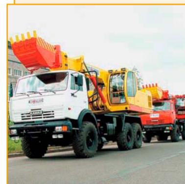
Мобильный многофункциональный экскаватор-планировщик ET-4322 на шасси КАМАЗ-43118 (6 × 6). Длина стрелы достигает 11,3 м. Не требуется установка удлинителя. Радиус копания увеличивается соответственно до 11 м.
