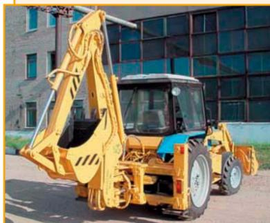
Базовый трактор – МТЗ-82.1. Ковш обратной лопаты – 0,28 м³. Челюстной погрузчик – 0,8 м³. Нечелюстной погрузчик – 0,63 м³. Ширина захвата – 2 м. Максимальная глубина копания – 4,3 м. Высота выгрузки – 3,6 м. Радиус копания – 5,5 м.
