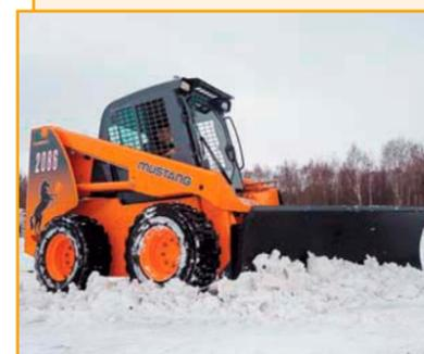
Универсальный мини-погрузчик Mustang-2086 (США) со снегоочистительным отвалом – отличное решение для зимней снегоуборки. Простота применения и недорогая технология оптимизируют накладные расходы коммунальных служб. Дизельный двигатель – Yanmar (Япония). Объем двигателя – 3,3 л.
