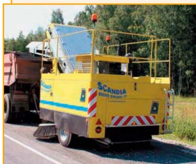
Подметально-уборочная машина SCANDIA 2W элеваторного типа. Две боковые щетки сметают грязь и мусор к центру и отправляют на транспортер с помощью задней цилиндрической щетки. Выгрузка по транспортеру в кузов грузовой машины опционно. Боковые скребки для разбивания твердых образований на поверхности дороги.
