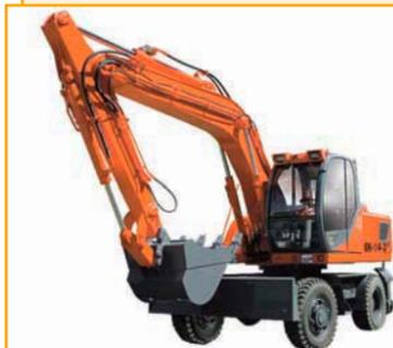
Экскаватор EK-14-20 – многоцелевая землеройная машина. Обладает увеличенным ресурсом и запасом по мощности. Усиленная металлоконструкция рабочего оборудования обеспечивает высокую надежность и долговечность. Усиленная ходовая рама повышенной прочности и надежности.
