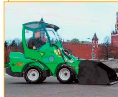
Шарнирно-сочлененный мини-погрузчик Avant 528 (Финляндия) отличается небольшими габаритами, экономичным двигателем и мощной гидравлической системой для работы с навесным оборудованием. Высокая проходимость и функциональность. Дизельный двигатель – Kubota (Япония). Номинальная мощность – 28 л. с. Максимальная грузоподъемность – 600 кг.
