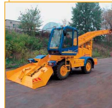
Лаповый снегопогрузчик СнП-17 предназначен для погрузки снега, снола и др. сыпучих материалов в кузов автомобиля-самосвала через кабину или задний борт.
