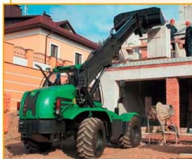
Погрузчик с телескопической стрелой АМКОДОР 527 предназначен для выполнения погрузочно-разгрузочных работ с сыпучими и кусковыми материалами, штучными грузами, а также для монтажных работ.
