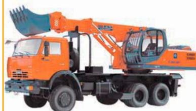
Экскаватор-планировщик ТЭП-18 оснащен телескопической стрелой. Возможно агрегирование с различными типами сменного рабочего оборудования. Оборудован механизмом ротации ковша (360 град.) и точкой подключения ручного гидроинструмента (опционально), что существенно расширяет сферу применения.
