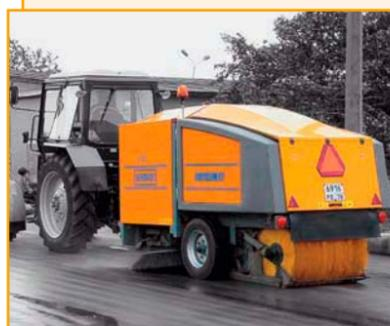
Прицепная механическая подметально-уборочная машина Broddway WASA 300 (Швеция) буксируется трактором (МТЗ). Привод агрегатов от гидронасоса, устанавливаемого на вал отбора мощности трактора. Система увлажнения для борьбы с пылеобразованием и для увеличения ресурса щеток.
