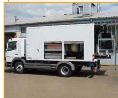
Каналопромывочные машины KROLL (Германия) применяется для очистки канализационных, водосточных сетей, технологических и промышленных трубопроводов, нефтехимических резервуаров. Устанавливается на шасси MAN, MERCEDES и др., шасси с прицепом, прицепа, полуприцепа. Возможно изготовление в виде рамной конструкции для установки на различную колесную базу (контейнеровоз, ГАЗель, Бычок и т. д.).
