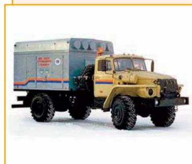
Моторный подогреватель на шасси автомобиля "Урал-43206-41"/"Урал-4320-41".
