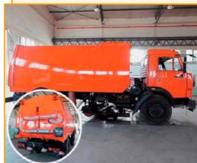
Вакуумные подметально-уборочные машины ТКМ-320 (на базе КАМАЗ-43253), ТКМ-321 (на базе КАМАЗ-53605) предназначены для качественной уборки городских дорог, улиц, автострад, площадей и т. п. от пыли, песка, щебня, листвы и другого мусора с увлажнением подметаемой поверхности и вывозом смета в места его выгрузки.
