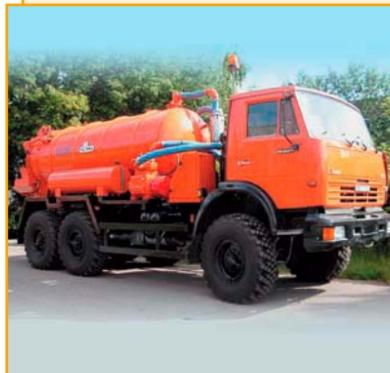
Машины серии КО-530 предназначены для механизированной очистки колодцев дождевых (ливневых) канализационных сетей от ила и транспортировки его к месту выгрузки. Могут применяться для очистки колодцев и отстойников очистных сооружений промышленных организаций.
