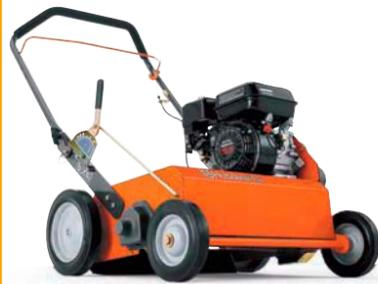
Мощный и компактный скарификатор Husqvarna DT 22 рассчитан на длительное и интенсивное использование. Может оснащаться рабочими органами трех типов, травосборником и сеялкой. Система легкого запуска, компактная конструкция. Центральная система установки рабочей глубины. Высококачественные саморегулирующиеся шарикоподшипники. Двигатель – Honda. Мощность – 5,5 л. с. Масса – 65,3 кг. Страна производства – США.
