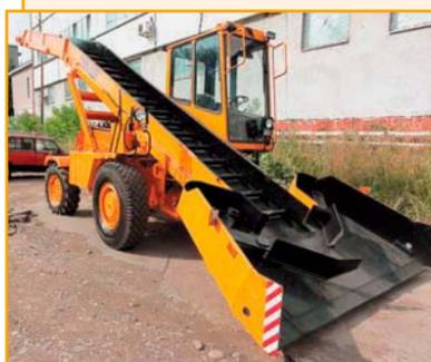
Снегопогрузчик ТКМ-237-02 с лаповым питателем и цепным транспортером предназначен для погрузки в транспортные средства свежевыпавшего, уплотненного снега и скелотого льда через кабину или задний борт. Регулируемая рулевая колонка. Подогрев сиденья водителя. Предпусковой подогреватель. Трансмиссия гидрообъемная. Привод рабочих органов – гидравлический.
