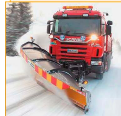
Диагональные передние снегоуборочные отвалы Arctic Machine серии D применяются для скоростной уборки снега.
