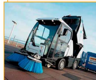
Вакуумная подметально-уборочная машина Johnston серии С200 предназначена для содержания городских улиц, тротуаров и территорий с ограниченным пространством. Серия С200 представлена двумя моделями: CN200 (40 км/ч) и СХ200 (50 км/ч). Машины самые компактные в своем классе, несмотря на наличие большого бункера емкостью 1,8 м<sup>3</sup>. Рабочая скорость – до 16 км/ч.
