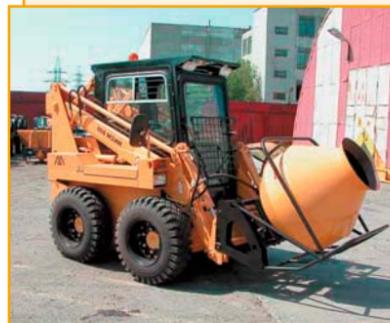
Бетоносмеситель МКСМ-800 применяется для приготовления подвижных бетонных смесей на различных строительных объектах с небольшим объемом работ (строительство коттеджей, гаражей, дачных домов, ремонтные работы).
