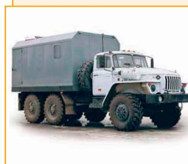
Транспортно-бытовая машина на шасси автомобиля "Урал-4320-41".
