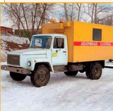
Аварийно-ремонтная машина "МABP" предназначена для доставки бригады ремонтников и проведения профилактических, ремонтных и аварийных работ в канализационных, теплофикационных, водопроводных, электрических, газовых и иных инженерных сетях.
