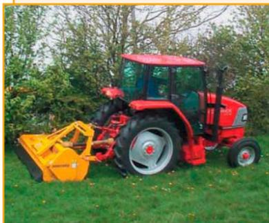
Серия навесных цеповых косилок BANDIT может эксплуатироваться на тракторах мощностью от 30 до 90 л. с. (в зависимости от модели). Доступны три модели с рабочей шириной 1,5; 1,8 и 2,25 м. Высота скашивания – регулируемая, 13–105 мм. Привод от вала отбора мощности трактора – 540–1 000 об/мин. Боковое смещение на 750 мм. Плавающий режим работы, с опорой на каток.
