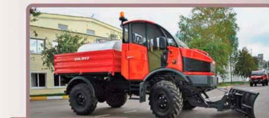
АВТОМОБИЛЬ SILANT ДЛЯ КОММУНАЛЬНЫХ И ЭНЕРГЕТИЧЕСКИХ СЛУЖБ (бортовая платформа с разгрузкой, опрокидыванием на 3 стороны, переднее и заднее навесное устройство + вал отбора мощности)
