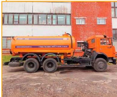
Машины ТКМ-622, ТКМ-622А на шасси автомобиля КАМАЗ-65115 предназначены для вакуумной загрузки, транспортировки к месту утилизации и выгрузки жидких отходов, не содержащих горючих и взрывоопасных веществ. Различные варианты комплектации машин насосами и дополнительным оборудованием по требованию заказчика.
