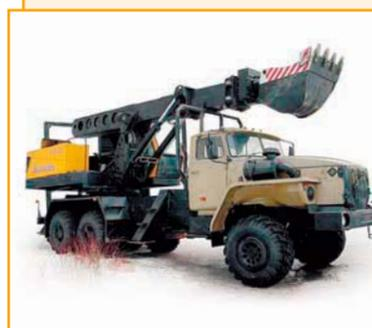
Экскаватор-планировщик на шасси "Урал-4320-40" с полноповоротным ковшом на конце телескопической стрелы.
