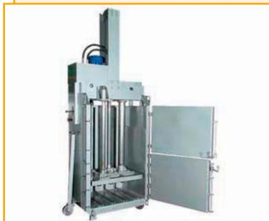
Пресс ТМ-12ТС универсален, прессует практически все виды ТБО, в том числе лом легковесных цветных металлов. Максимальное усилие прессования – 14 т. Габариты пресса – 1 160 × 850 × 2 820 мм. Масса пресса – 750 кг. Габариты рабочей камеры – 830 × 650 × 1 200 мм. Потребляемая мощность – 4 кВт.
