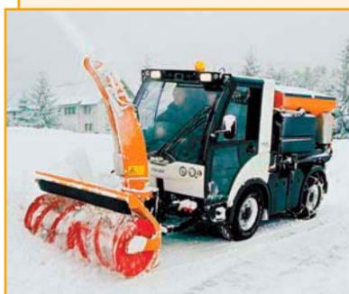
Универсальные машины на базе Multicar (Германия) предназначены для круглогодичного использования. Комплекуются отвалами для уборки снега, подметальными щетками различных типов и размеров, а также снегометами. Отлично зарекомендовали себя в условиях снежной и морозной зимы.
