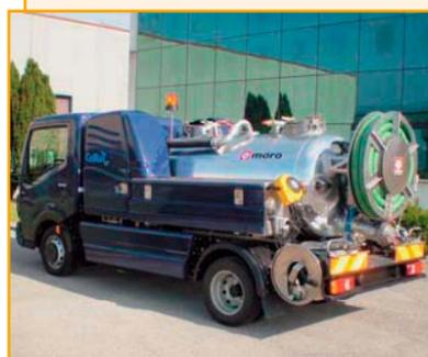
Комбинированные машины Mogo комплектуются каналопромывочным и вакуумным оборудованием, что увеличивает их функциональные возможности. Фактически заменяют илососные и каналопромывочные машины, в связи с чем значительно повышается экономическая эффективность и снижаются эксплуатационные затраты.
