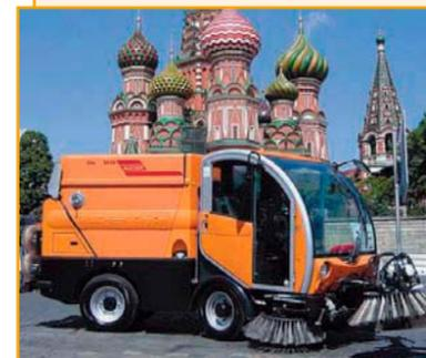
Подметально-вакуумная машина Bucher CityCat-2020 имеет систему рулевого управления с шарнирно-сочлененной рамой.
