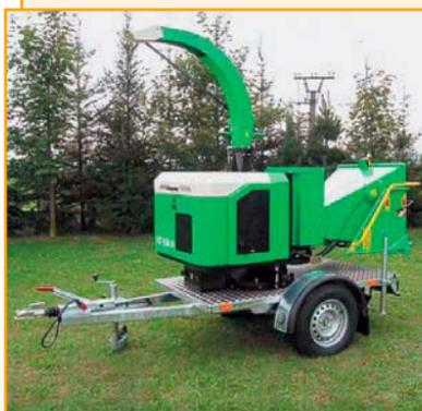
Измельчитель LS150D производства LASKI (Чехия) предназначен для утилизации древесных отходов, мелких веток, коры и т. п. с последующей выдачей щепы.
