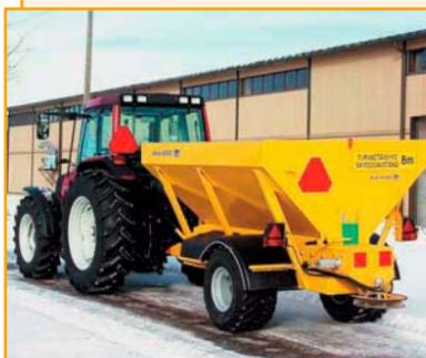
Прицепной тарельчатый распределитель Arctic Machine 4500 SS применяется для работ по предотвращению скользкости в зимний период. Крепится на стандартную тракторную навеску. Может использоваться с тракторами типа МТЗ 1221, МТЗ 2022. Кузов оцинкован горячим методом и имеет многослойную окраску эпоксидной эмалью.
