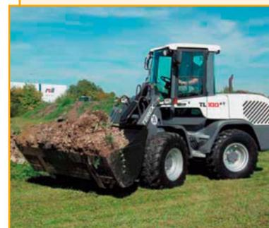
Фронтальный погрузчик TEREX-TL100 (Германия) шарнирно-сочлененного типа с эргономичным дизайном. Отличается высокой маневренностью и повышенной износостойкостью шин, экономичностью двигателя и высокой производительностью. Дизельный двигатель – Deutz.
