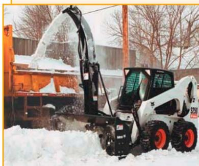
Роторный снегометатель позволяет использовать погрузчик Bobcat зимой. Оборудование идеально подходит для уборки тротуаров, проезжей части и паркингов от снега. Регулируемые по высоте подкладные башмаки устанавливают режущую кромку под гравий или мощную поверхность. В зависимости от модели отбрасывает снег на расстояние до 12 м. Пандус для погрузки в грузовики доступен в качестве опции.
