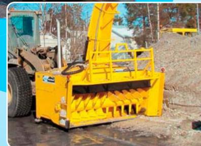
Рабочим органом снегоочистителя AM 2500 является мощный и тяжелый вал со специальными лопатками, имеющий рабочую частоту вращения от 2 000 до 2 200 об/мин. Высокая частота вращения позволяет дробить комки даже твердого снега, превращая его в плотную однородную массу. Хорошо продуманная конструкция рабочего вала не требует никаких дополнительных устройств для выброса снега (например, метателя с лопатками), что делает снегоочиститель AM 2500 более надежным по сравнению с конкурентами.
