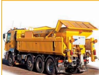
Распределители Arctic Machine 5000/6000/8000 Combi применяются для распределения соли и солевого раствора. Могут устанавливаться как на раму грузового автомобиля, так и в кузов самосвала.
