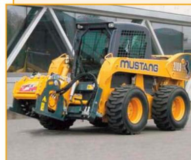
Универсальный мини-погрузчик Mustang-2109 (США) с дорожной барабанной фрезой. Рабочая ширина – от 350 до 1 000 мм. Незаменимый помощник при ямочном ремонте и реконструкции дорог. Минимальные издержки подрядчика – неоспоримое достоинство мини-техники. Дизельный двигатель – Cummins (США).
