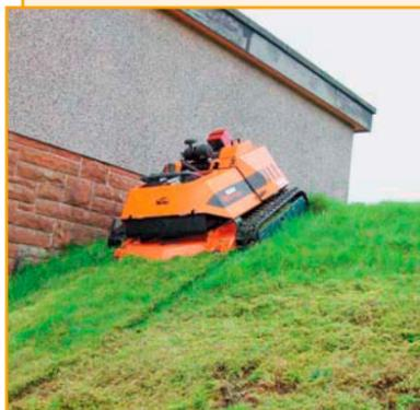
Малогобаритная самоходная машина Robo Flail one с высокой маневренностью и проходимостью для окоса травостоя и ликвидации древесно-кустарниковой растительности в труднодоступных местах: на откосах глубоких выемок, в местах со слабыми грунтами, заболоченных местностях, на полосах отвода автомобильных и железных дорог.
