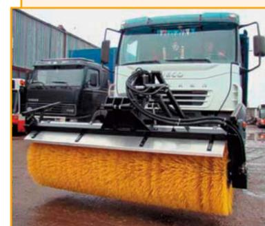
Высокоэффективные фронтальные открытые щетки устанавливаются на тракторы, фронтальные погрузчики и грузовые автомобили. Применяются для качественной уборки дорог как в зимнее, так и в летнее время с установленной системой орошения. Диаметр – 915 мм. Рабочая скорость – до 30 км/ч.
