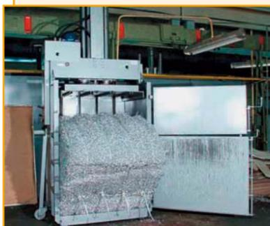
Пресс ТМ-14ТМ является идеальным решением для фирм – заготовителей гофрокартона, а также компаний, имеющих большие объемы вторсырья. Используется для прессования ПЭТ-бутылок, полиэтиленовой пленки, поролона, текстиля и др.
