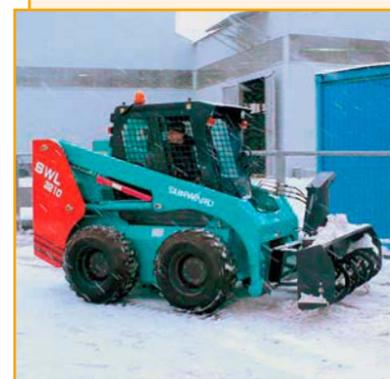
Мини-погрузчик SUNWARD предназначен для работы в ограниченных пространствах. Имеет высокую производительность в условиях узких городских улиц, заводских цехов. Применяется для уборки снега, расчистки улиц, ведения буровых и погрузо-разгрузочных работ.
