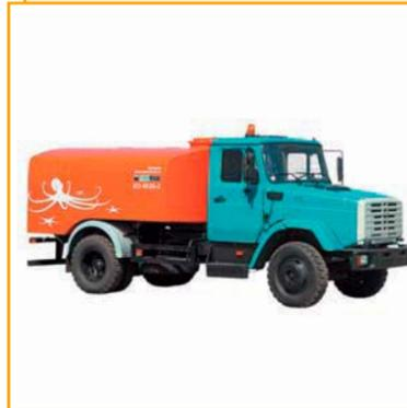
Каналопромывочные машины КО-502Б-2, КО-512, КО-514, КО-514-1 предназначены для аварийной и профилактической очистки канализационных и водосточных труб, отстойников, колодцев, ливневой канализации и ликвидации засоров в канализационных системах.
