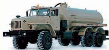
Машины вакуумные на шасси автомобилей "Урал".
