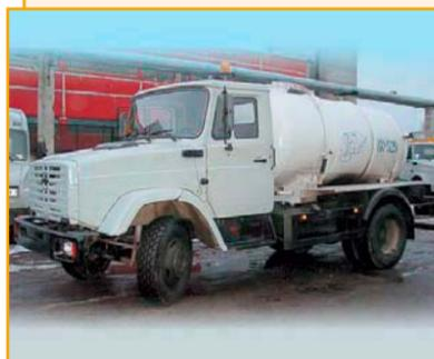
Вакуумные машины для очистки выгребных ям и транспортировки фекальных жидкостей к месту утилизации.
