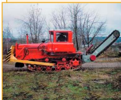
Экскаватор траншейный цепной ЭТЦ-205 на базе трактора ВТ-90 с бульдозерным оборудованием предназначен для рытья в грунтах I–III категорий траншей прямоугольного сечения под трубопроводы различного назначения, кабельные линии связи, линии электропередач, а также для выполнения планировочных работ.
