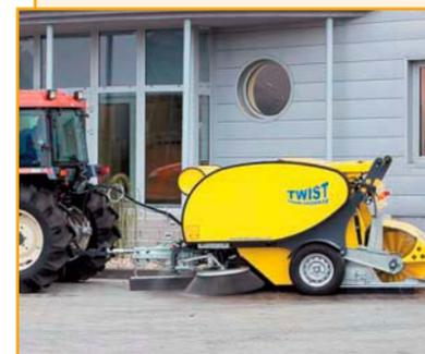
Универсальная эффективная подметальная система прицепного типа для работы с мини-тракторами и другими тягачами. Две боковые щетки диаметром 870 мм. Полностью автоматическая подвеска. Гидравлический привод. Привод ВОМ трактора или шасси типа Wille.
