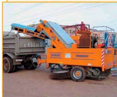
Прицепная механическая подметально-уборочная машина Broddway Senior 2000 (Швеция) буксируется самосвалом. Механический подбор и прямая загрузка смета в кузов самосвала для тяжелой и скоростной уборки. Легко, быстро и чисто убирает слежавшийся зимний песок, асфальт после фрезерования, щебень после дорожных работ, мусор после
