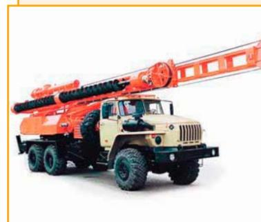
Бурильно-сваебойная машина на шасси «Урал-4320-40» предназначена для бурения скважин в талых и вечномерзлых грунтах I-IV категорий на заданную глубину с заданным диаметром и забивания в них свай при строительстве свайных фундаментов зданий и сооружений.
