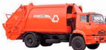
Мусоровозы с задней загрузкой КО-440В, КО-440В1, КО-440В1-01, КО-440ВГ предназначены для механизированного сбора твердых бытовых отходов из металлических и пластмассовых контейнеров всех типов объемом до 1,1 м³, их уплотнения, транспортирования и механизированной выгрузки в местах утилизации.
