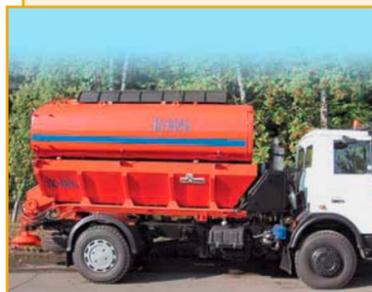
Машины комбинированные предназначены для круглогодичного использования по содержанию городских дорог с твердым покрытием и автомагистралей.
