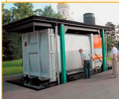
Комплекс оборудования КПСО-20 предназначен для реализации современной технологии подземного сбора и временного хранения твердых бытовых отходов в местах их массового образования. Осуществляет сбор и уплотнение ТБО (за исключением крупногабаритных отходов), предварительно собранных в стандартных наземных или заглубленных урнах. Заполненный пресс-компактор вывозится и опорожняется стандартным автомобилем-самопогрузчиком типа "мультилифт". Объем контейнера пресс-компактора – 20 м³.
