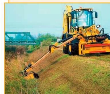
Навесная манипуляторная косилка-кусторез для спецтехники VENIERI (Италия) применяется для подрезки кустов, окоса обочин и откосов непосредственно вдоль дорожного полотна, а также для подрезания крон деревьев и кустарников в скверах и парках.
