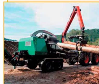
Установка CHIPPO 500 производства компании КОМПТЕСН (Австрия) представляет собой дробилку барабанного типа с приводом от трактора для измельчения срезанных ветвей и древесных стволов. Активная система подачи измельчаемого материала, две скорости вращения барабана и возможность выгрузки материала посредством патрубка с нагнетателем или ленточного конвейера придают установке совершенство и универсальность.
