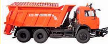
Комбинированные дорожные машины предназначены для всесезонного содержания городских и магистральных автомобильных дорог. В летний период машина используется в качестве самосвала. В зимний период машина используется для скоростной и патрульной снегоочистки, удаления наледи, распределения противогололедных материалов, в том числе увлажненных и жидких реагентов, а также для очистки дорожного полотна щеточным оборудованием. Оборудование машины КО-829СЗ изготовлено по лицензии фирмы КОВИТ Чехия.
