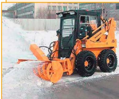
Снегоочиститель МКСМ-800 применяется для уборки свежевыпавшего и слежавшегося снега с пешеходных дорожек, автомобильных дорог и других площадок. Состоит из кожуха, редуктора, вентилятора (ротора), гидромотора, спиралей, кронштейна. Расчетная производительность – 80 т/ч. Масса – не более 320 кг. Ширина уборки – не более 1 745 мм. Высота убираемого снега – не более 250 мм. Дальность отброса основной массы снега – не менее 5 м.
