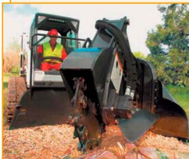
Мощное навесное оборудование, быстро измельчающее пни деревьев. Оптимальная производительность при применении фрезы на погрузчике Bobcat, оснащенного опцией высокого гидравлического расхода. Уникальная конструкция клапана позволяет контролировать скорость поворотного контура для предотвращения заклинивания режущего диска при резке. Резиновые экраны дефлектора и сетка обеспечивают дополнительный комфорт для оператора и защищают его от щепок.
