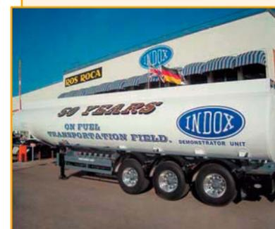
Полуприцепы-цистерны INDOX самонесущей конструкции. Предназначены для перевозки, временного хранения и перекачивания светлых нефтепродуктов плотностью до 860 кг/м<sup>3</sup>. Транспортируются седельным тягачом с колесными формулами 4 × 2; 6 × 4 и высотой седельно-сцепного устройства. Объем цистерны – до 38 м<sup>3</sup>. Поперечное сечение – овальное.
