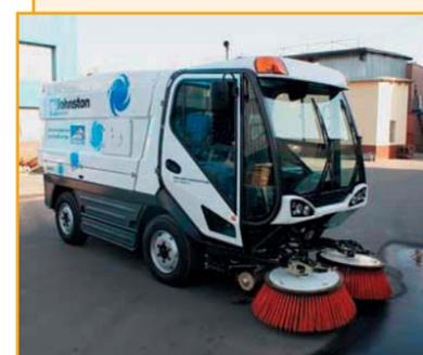
Вакуумная подметально-уборочная машина Johnston серии С400 приспособлена для работы как в условиях городских кварталов, так и в промышленных зонах. Уникальна для использования в ограниченных пространствах. Серия С400 представлена двумя моделями: СХ400 и CN400 (объем бункера 4 м<sup>3</sup>) для уборки территорий в районах интенсивной
