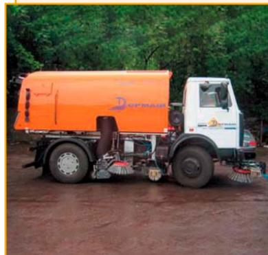
Вакуумная подметально-уборочная машина ВПМД-01 на шасси МА3-5551 предназначена для механизированной уборки проезжей части магистральных дорог, улиц и других территорий с бетонным или асфальтовым покрытием.
