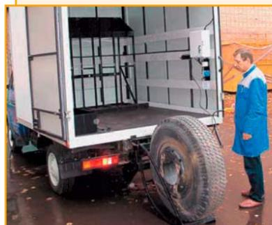
Спецавтомобиль предназначен для механизации погрузки/разгрузки и доставки колес в сборе с целью их последующей замены, в том числе для технической помощи автобусам и троллейбусам. Технологическое оборудование монтируется в автофургоне 2834PS на базе шасси ГАЗ-2310 с двигателем УМЗ-4216 Евро-3, с двухдверным задним проемом, с фиксацией дверей и системой освещения.
