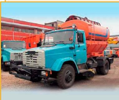
Комбинированные машины круглогодичного использования для содержания городских дорог с твердым покрытием (поливомоечное, плужное, щеточное, распределяющее оборудование).
