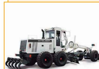
Грейдер MITSUBER MG165R предназначен для работы на дорогах, аэродромах и других объектах, требующих выравнивания поверхности. Используется в строительстве, горнодобывающей промышленности.
