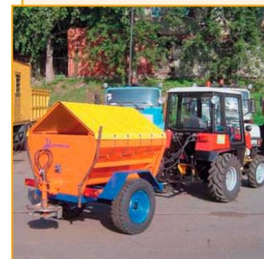
Трактор "Беларус-320" в комплектации с прицепом ПККД-20 с распределяющим оборудованием применяется для распределения на дорожном покрытии твердых материалов (песко-соляная смесь, гранитная или мраморная крошка и др.) или реагентов, используемых в зимнее время для содержания тротуаров и иных территорий.
