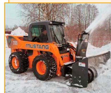
Универсальный мини-погрузчик Mustang-2109 (США) со снегометателем шнеко-роторного типа. Высокая производительность и долговечность в эксплуатации. Мощность погрузчика позволяет грузить снег в самосвал, регулировать дальность выброса от 3 до 20 м. Дизельный двигатель – Cummins (США).
