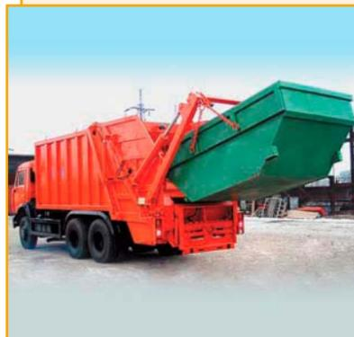
Мусоровозы серии КО-427 с задней загрузкой кузова предназначены для механизированного и ручного сбора твердых бытовых отходов, их уплотнения, транспортирования и механизированной разгрузки в местах утилизации. Спецоборудование может монтироваться на шасси КАМАЗ, МАЗ, HYUNDAI, FORD, MAN, Dong Fehng и др.
