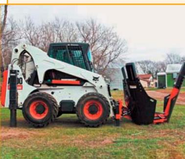
Навесное оборудование для пересадки деревьев отличается высокой надежностью, маневренностью и простотой управления. Позволяет за считанные минуты превратить погрузчик Bobcat в машину для пересадки деревьев.
