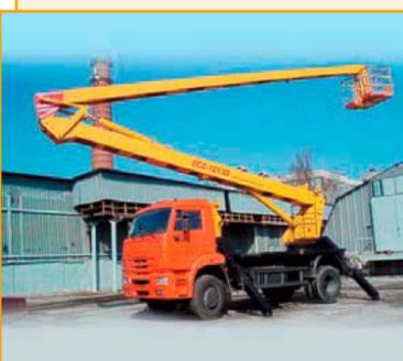
Автоподъемники локтевые и телескопические для подъема людей на высоту при выполнении ими различных строительных, ремонтных и монтажных работ.
