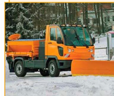
Машины Multicar (Германия) могут быть оборудованы пескосолеразбрасывателями различных объемов и типов, имеющими:
