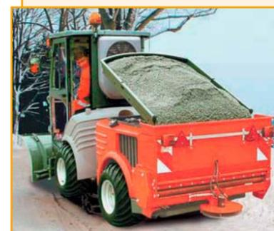
Вакуумные подметальные машины Hako-Citymaster (Германия) предназначены в том числе и для распределения антигололедных материалов.
