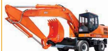
В колесном экскаваторе ЭО-33211АК сохранены все преимущества базовой модели ЭО-33211А. Дополнительно модель оснащена насосной и сварочной установками, позволяющими сократить до минимума объем техники, количество исполнителей и время при прокладке, ремонте и замене трубопроводов. Предназначен для проведения ремонтно-восстановительных работ инженерных сетей и сооружений коммунального хозяйства.
