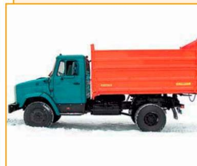
Автомобили-самосвалы предназначены для перевозки и механизированной разгрузки различных насыпных и навалочных грузов. Базовое шасси – ЗИЛ-494560/ЗИЛ-497442 (4 × 2). Тип двигателя – карбюраторный/дизельный. Модель двигателя – ЗИЛ-508300/ММЗ Д-245.9. Мощность – 98,7 (134)/95,7 (130) кВт (л. с.).
