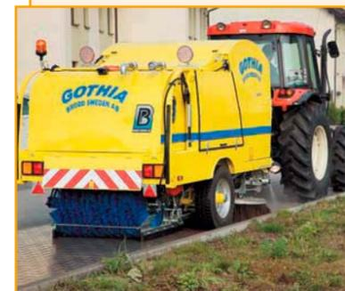
Боковые щетки сметают грязь к центру, основная широкая щетка забрасывает ее на прочный подъемник с резиновыми лентами. Выгрузка смета в бункер. Привод от гидравлики трактора. Скорость подметания – 1–20 км/ч. Транспортная скорость – до 40 км/ч. Тормозная система накатом.
