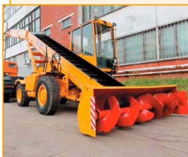
Снегопогрузчик ТКМ-237-01 с лаповым питателем и цепным транспортером предназначен для погрузки в транспортные средства свежевыпавшего и уплотненного снега через кабину или задний борт. Регулируемая рулевая колонка. Подогрев сиденья водителя. Предпусковой подогреватель. Трансмиссия гидрообъемная. Привод рабочих органов – гидравлический реверсивный.
