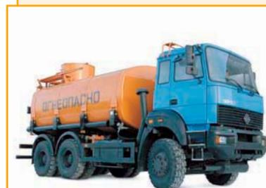
Автотопливозаправщик "Урал-66131-04" (АТЗ-17-63685) на базе шасси "Урал-63685-1110-01". Предназначен для перевозки по дорогам I-IV категорий, кратковременного хранения и раздачи светлых нефтепродуктов плотностью 0,7–0,86 г/см<sup>3</sup>.
