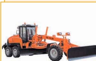
Автогрейдер 14.03 (класс 140) применяется в строительстве, при содержании дорог, работает на грунтах I–III категорий.
