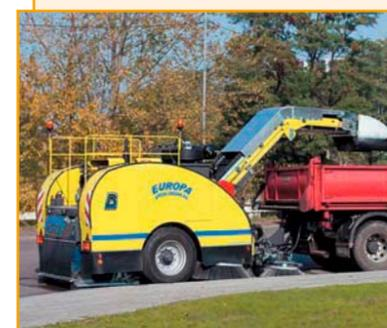
Двухколесная подметальная машина EUROPA прицепляется к грузовику. Загружает грязь непосредственно в кузов-платформу грузовика. Привод от автономного дизельного двигателя. Скорость подметания – 1–20 км/ч. Транспортная скорость – до 40 км/ч.
