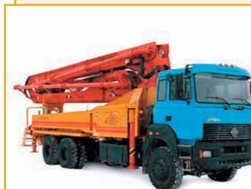
Автобетононасос «КСР 40RX170» на базе шасси «Урал-63685-006111-21». Предназначен для подачи бетонной смеси на строительных объектах на высоту от 28 до 40 м.
