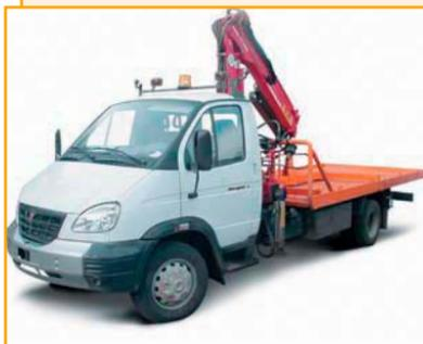
Автомобиль ГАЗ-33104 «Валдай» предназначен для погрузки и разгрузки различных грузов, а также их транспортировки. Оборудован крано-манипуляторной установкой AmcoVebe, вылет стрелы которой позволяет загружать грузы по всей длине бортовой платформы. Возможна установка других КМУ AmcoVebe с грузовой моментом до 11 т\*м и различного навесного оборудования.
