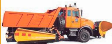
Всепогодная комбинированная дорожная машина "Тройка - 2000" на шасси автомобиля "Урал 55571-58" предназначена для круглогодичного использования дорожными службами. Зимой - для патрульной очистки дорог от снега, посыпки опасных участков дорог антигололедными материалами (песком, песчано-соляной смесью, гравием или щебнем мелких фракций). Летом - в качестве самосвала, а также для разравнивания сыпучих материалов.
