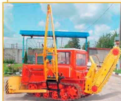
Базовый трактор – ДТ-75 (гусеничный). Грузоподъемность – 4,0 т. Дополнительно комплектуется: отвалом с гидроперекосом или поворотным отвалом. При транспортировке трубоукладчика его стрела складывается. Основные функции:
