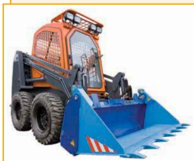
Погрузчик малогабаритный с бортовым поворотом ПМК-6.02 предназначен для механизации погрузочно-разгрузочных работ как в обычных, так и стесненных условиях; транспортно-складских работ; специальных работ (бурение скважин, очистка от снега, грязи дорог и тротуаров и др.). Эксплуатируется в диапазоне температур от -30 до +40 °С.
