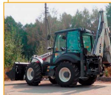
Экскаватор-погрузчик TEREX-970 (Великобритания) с колесной формулой 4 × 4 × 4 (все ведущие и все поворотные равновеликие колеса). «Крабовый ход» и повышенная проходимость по бездорожью и слабым грунтам. Гидроразводка на обратной лопате, быстросменная сцепка для замены ковша на дополнительное навесное оборудование.
