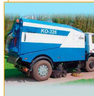
Машины подметально-уборочные вакуумные серии КО-326 предназначены для очистки городских дорог с твердым покрытием от мусора, подметания улиц, вакуумной загрузки смета в бункер-мусоросборник, вывоза и самосвальной выгрузки смета в местах утилизации.
