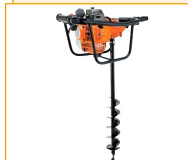
Мощный и надежный землебур Husqvarna 143AE15 для бурения отверстий в земле под столбы и другие строительные элементы. Надежный редуктор для интенсивной тяжелой работы с уплотненной почвой или дерном. Шнеки различного диаметра для разных задач по бурению земли. Диаметр шнеков – от 90 до 300 мм, длина – от 800 до 850 мм. Рабочий объем цилиндра – 41,5 см<sup>3</sup>. Мощность – 1,47 кВт/2,0 л. с. Объем топливного бака – 0,9 л. Масса – 8,9 кг. Страна производства – Япония.
