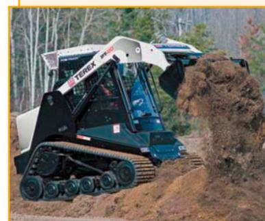
Гусеничный погрузчик Terex-PT 80 (США) с повышенной проходимостью и отличным сцеплением с дорожным покрытием благодаря гусеничной ходовой. Дополнительная гидравлика в передней части мини-погрузчика позволяет использовать различное навесное оборудование для выполнения различных видов работ в ЖКХ.
