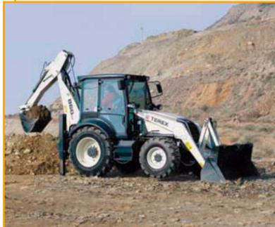
Экскаватор-погрузчик Terex применяется при строительстве дорог, трубопроводов, разработке глиняных месторождений, ландшафтном дизайне.
