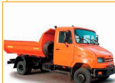
Автомобиль-самосвал ЗИЛ-СААЗ-3501 предназначен для перевозки и механизированной разгрузки строительных и навалочных грузов по всем видам дорог.
