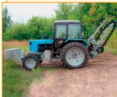
Экскаватор траншейный цепной ЭТЦ-1609 на базе трактора МТЗ-82.1 предназначен для рытья траншей прямоугольного сечения под кабельные линии связи, линии электропередач и трубопроводы различного назначения. Выпускается в трех модификациях:
