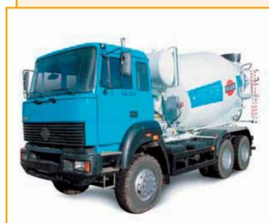
Автобетоносмесители «Урал-69364Р», «Урал-69364Н» на базе шасси «Урал-63685-1110-01». Предназначены для транспортирования бетонной смеси и разгрузки ее непосредственно в месте укладки или перегрузки в другие бетонотранспортные устройства: бетононасосы, конвейеры, тару и т. п.
