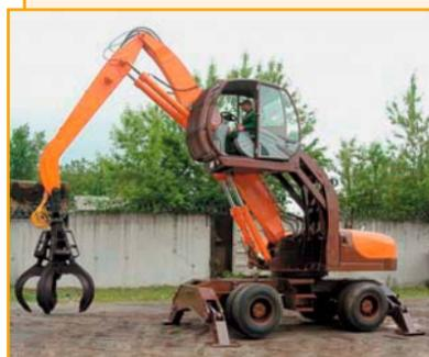
Экскаватор E160W-20 оснащен грейфером с ротатором, подъемной кабиной и пневмоколесным ходом с двумя балками откидных опор. Предназначен для погрузки и разгрузки металлического лома, древесных материалов, отходов железобетона. Имеет интегрированную систему ограничения грузоподъемности, обеспечивающую безопасность проведения работ.
