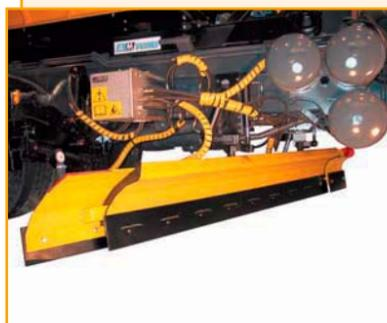
Средние отвалы Arctic Machine расширяют возможности грузового автомобиля при проведении работ по содержанию дорог. Применяются для быстрой и эффективной уборки снега, удаления наката и планирования поверхности. Регулировка угла наклона крыла позволяет создавать необходимый профиль дороги. Правильно подобранные к среднему отвалу ножи позволяют эксплуатировать его круглый год.
