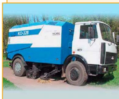
Подметально-уборочные машины для очистки городских дорог с асфальтовым или цементобетонным покрытием от загрязнений, а также для перевозки собранного смета к местам свалок. Базовое шасси – КАМАЗ, МАЗ.
