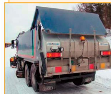
Распределители Arctic Machine S09H – эффективное оборудование для северных условий, когда важно равномерное распределение песка или песко-солевой смеси для предотвращения скользкости. Хорошо подходят для дорог с низкой интенсивностью движения или содержащихся в зимнее время под снежным накатом.
