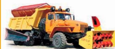
Всепогодная комбинированная дорожная машина ВМКД на шасси автомобиля "Урал-55571-40". Предназначена для круглогодичного использования дорожными службами. Зимой - для патрульной очистки дорог от снега, для посыпки опасных участков дорог антигололедными материалами
