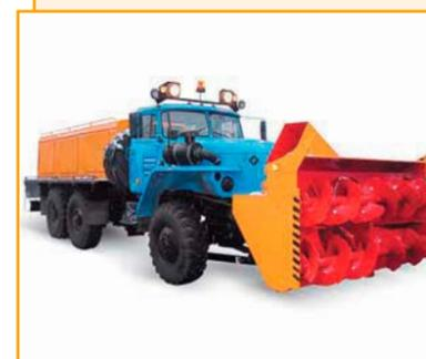
Шнекороторный снегоочиститель КО-650У предназначен для очистки от снега автомагистралей и взлетно-посадочных полос, а также для отбрасывания снежных валов, образованных другими снегоочистителями.
