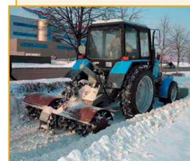
Предназначена для уборки дорог от ледяного покрытия.
