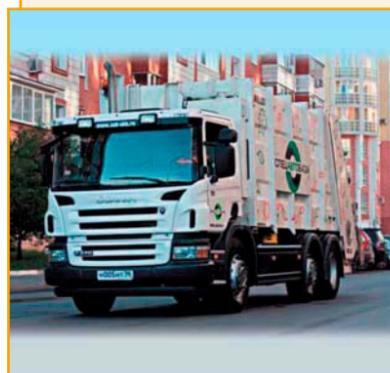
Мусоровозы ZOELLER MEDIUM XL и MEDIUM XXL на шасси SCANIA предназначены для сбора и вывоза большого объема отходов, в т. ч. крупногабаритных.
