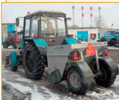
Прицепные распределители Arctic Machine 1600 RS, 2500 RS применяются для распределения песка, песко-солевой смеси и отсева мелкой фракции щебня (3–5 мм). Компактны, используются на улицах городов, тротуарах, парковках. Легко крепятся на стандартную трехточечную навеску тракторов типа МТЗ. Кузова распределителей оцинкованы горячим методом и имеют отличную коррозионную защиту.
