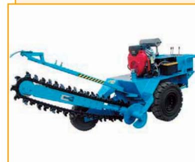
Малогабаритный траншеекопатель ТКМГ-1200 выполнен на спецшасси. Импортные комплектующие, в т. ч. гидравлический привод и двигатель (Япония, бензиновый). Сопоставим по характеристикам с зарубежными аналогами. Привод рабочего органа – гидравлический. Ширина прорезаемой траншеи зимней цепью – 90 мм. Ширина прорезаемой траншеи летней цепью – 150 мм. Глубина прорезаемой траншеи – до 1 200 мм. Не требует постановки на учет в органы Гостехнадзора и ГИБДД.
