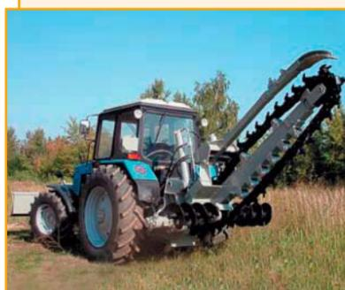
Экскаватор траншейный цепной ЭТЦ-201 с механическим приводом и ЭТЦ-201 Г с гидравлическим приводом рабочего органа, с бульдозерным оборудованием на базе трактора МТЗ-1221 предназначен для рытья в грунтах I–III категорий траншей прямоугольного сечения под кабельные линии связи, линии электропередач и трубопроводы различного назначения. Глубина траншеи – до 2 м, ширина в талых грунтах – до 400 мм, в мерзлых – до 250 мм.
