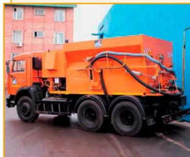
Машина для ремонта дорог пневмонабрызгом и струйно-инъекционным методом.
