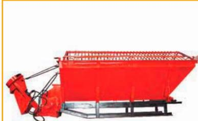
Машина для разбрасывания антигололедного материала МВУ-5Д предназначена для нанесения на поверхность дорожного полотна сыпучих антигололедных материалов (АГМ). Тип машины – полуприцепной. Агрегируется с тракторами класса 1,4 и 2, оборудованными гидрокрюком и приводом к тормозам прицепа. Плотность распределения АГМ – 0,15–0,5 кг/м<sup>2</sup>.
