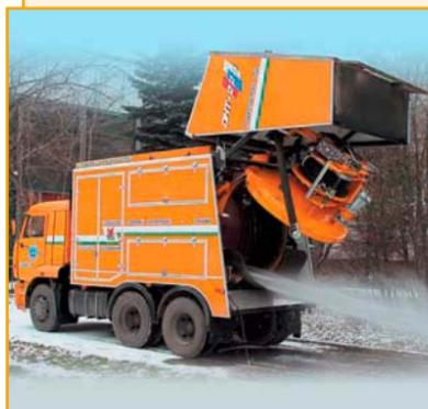
Комбинированные каналочистительные машины предназначены для аварийной и профилактической прочистки канализационных и водосточных труб, отстойников, колодцев, водоприемников и вывоза загрязнений. Возможна эксплуатация в зимний период.
