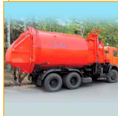
Большегрузные мусоровозы серии КО-449 с боковой загрузкой с кузовом цилиндрической формы предназначены для уборки ТБО из контейнеров объемом 0,75–1,1 м³.
