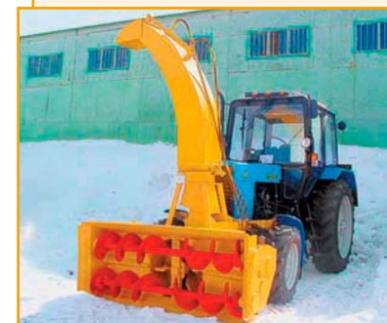
Снегоочиститель шнекороторный ШРС предназначен для очистки дорожных покрытий от снега, а также для удаления снежных валов, образованных другими снегоочистителями, путем отбрасывания в сторону или погрузки в транспортное средство. Базовый трактор – Беларусь 82П, Беларусь 80.1. Производительность – 200 т/ч. Дальность отброса – до 20 м.
