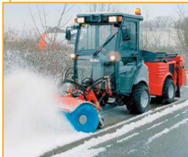
Вакуумные подметальные машины Hako-Citymaster (Германия) применяются для эффективной уборки снега с дорожного покрытия при помощи щетки или отвала. Благодаря мощному гидравлическому приводу могут использоваться на сильно заснеженных участках. Высокая маневренность машины незаменима для работы на узких улицах и во дворах.
