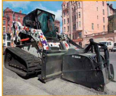
Дорожная фреза Bobcat предназначена для резки асфальта и бетона. Отличается высокой эффективностью. Гидравлический двигатель с прямым приводом и большим крутящим моментом. Специальный гидравлический механизм бокового смещения для работы вблизи стен и бордюров. Точность регулировки достигается с помощью кнопочного управления. Не требует дополнительного специального обслуживания.
