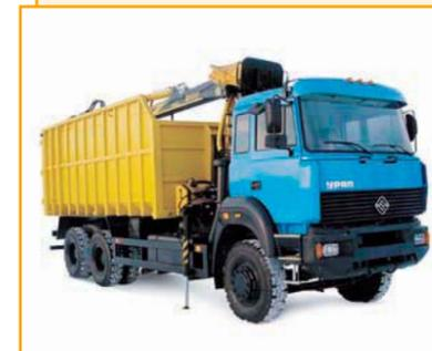
Автомобиль-металловоз «Урал-63774» на базе шасси «Урал-63685-6111-01».
