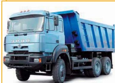
Автомобиль-самосвал "Урал-583109" с задней разгрузкой на базе шасси "Урал-63685-1110-01". Предназначен для перевозки различных насыпных и навалочных строительных и промышленных грузов по дорогам I-IV категорий при температуре окружающего воздуха от -45 до +40 °С.
