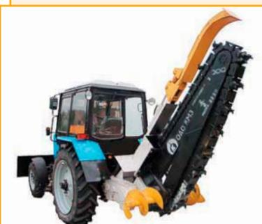
Грунторез 2086.51.00.000 устанавливается на трактор МТЗ-1221 (МТЗ-82). Оснащен универсальной режущей цепью шириной 280 мм, с надежным редуктором. Предназначен для прорезки траншеи на глубину до 1,7 м под укладку силовых кабелей, трубопроводов, линий связи и прочих коммуникаций в мерзлых и твердых грунтах до IV категории и абразивностью до 10 мг.
