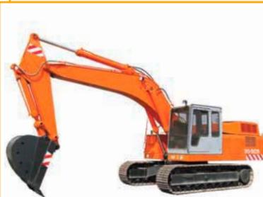
Гидравлический гусеничный экскаватор ЭО-5126 предназначен для разработки немерзлых грунтов I-IV категорий, а также предварительно разрыхленных скальных и мерзлых грунтов с величиной кусков не более 500 мм. Эксплуатируется в диапазоне температур от -40 до +40 °С. Эксплуатационная масса – не более 32 000 кг.
