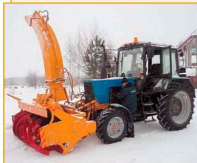
Мощное мобильное средство для очистки от рыхлого или уплотненного снега городских улиц, тротуаров, шоссе, дворов. Предназначен для погрузки снега и при необходимости уплотнения его в валы либо отброса вправо влево до 20 м.
