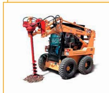
Буровое оборудование для МКСМ-800 предназначено для бурения ям и скважин диаметром 200, 300 и 400 мм (в зависимости от диаметра применяемого бора). Применяется в т. ч. при проведении работ по посадке кустов и небольших деревьев, установке столбов, стоек заборов, при бурении отверстий под опоры других конструкций.
