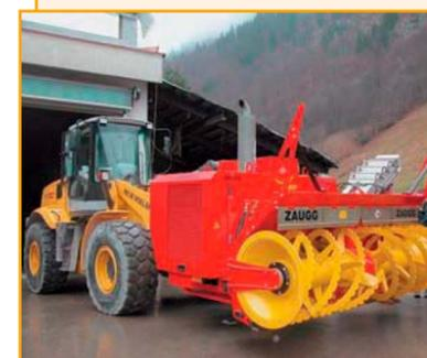
Снегоочистители Monobloc фирмы ZAUGG для колесных погрузчиков. Установки Monobloc выпускаются пяти различных размеров, имеют ширину от 2,0 до 3,3 м и выходную мощность от 70 до 600 л. с. Полностью автономны. Возможность быстрого подсоединения к погрузчику другого рабочего оборудования ZAUGG, например снежного отвала, скребка для льда, совкового отвала и т. д.
