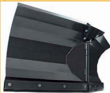
Отвал с изменяемой геометрией Husqvarna устанавливается на райдер Husqvarna PF 21 AWD. Гидравлическое управление. Может принимать Y-образную или диагональную форму. Рабочая ширина – 120 см. В комплект поставки входит защитная резиновая накладка для безопасной работы на мощных дорогах. Страна производства – Финляндия.
