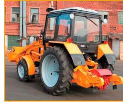
Машины фрезерные АМКОДОР 8047А, АМКОДОР 8047А-01, АМКОДОР 8047А-02 представляют собой комплект навесного оборудования, установленного на трактор МТЗ-82.1. Предназначены для подготовки покрытий дорог, аэродромов, тротуаров и т. п. к ремонту методом холодного фрезерования. Осуществляются следующие виды ремонта:
