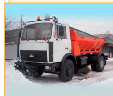
Снегоуборочные машины для снегоочистки городских дорог с усовершенствованным покрытием, а также для посыпки инертными материалами или антигололедными реагентами поверхности дорожного полотна. Может использоваться для перевозки снега и других сыпучих материалов.
