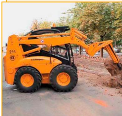
Погрузчик с бортовым поворотом АМКОДОР 211 предназначен для механизации погрузочно-разгрузочных и выполнения землеройно-транспортных работ на грунтах I и II категорий, выполнения складских работ со штабелируемыми грузами, очистки дорог от мусора и снега, ухода за территориями, а также для выполнения различных специальных и вспомогательных работ.
