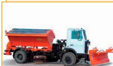
Машина дорожная комбинированная МДК-5337 предназначена для круглогодичного ухода за дорогами с твердым покрытием всех категорий. Базовое шасси – МАЗ-5337А2. Колесная формула – 4 × 2. Тип двигателя – дизельный.
