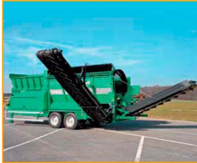
Сортировальная установка барабанного типа PRIMUS (KOMPTECH, Австрия) отличается высокой производительностью, что делает ее непревзойденной в своем классе. Благодаря прочной конструкции и новаторским разработкам, незаменима для небольших и средних хозяйств, занимающихся заготовкой компоста. Эффективна в работе благодаря большому приемному бункеру; крутые боковые стенки исключают перекрытие. Оптимальна в обслуживании. Простой доступ ко всем основным элементам машины и легкость замены барабана.
