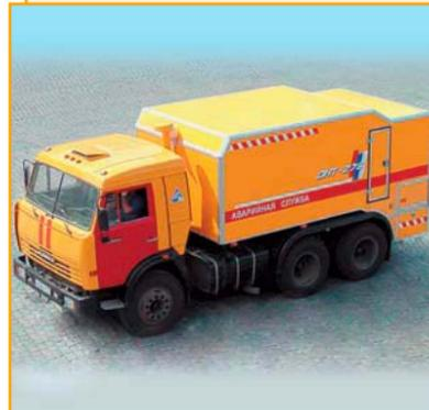
Каналопромывочные машины предназначены для аварийной и профилактической прочистки канализационных, водосточных, производственных трубопроводов и коллекторов диаметром до 1,2 м.
