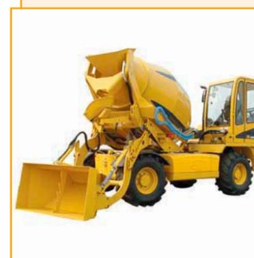
Самоходные самозагружающиеся бетоносмесители FIORI (мобильные бетонные заводы) на шасси 4 x 4 обеспечивают комплексность решения задач по производству и использованию бетона на строительных объектах.
