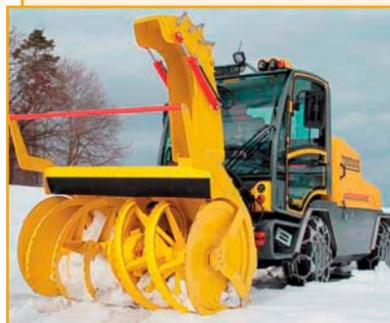
Специальный компактный маневренный самоходный фрезерно-роторный снегоочиститель BOSCHUNG B4 для работы в стесненных условиях, метания/погрузки снега в грузовики на городских улицах, тротуарах, в парках. Гидравлически управляемый патрубок с заслонкой, подъемная кабина, компактный дизайн и простота в управлении.
