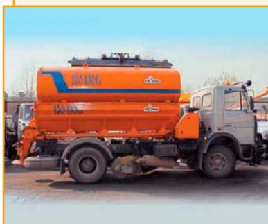
Поливомоечные машины для мойки и полива дорожных покрытий, прилотовой полосы, полива зеленых насаждений, а также в качестве дополнительного средства при тушении пожаров.
