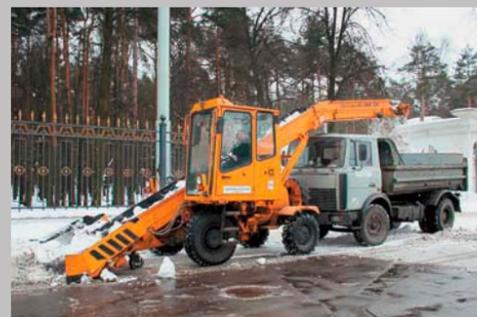
Особенность этих моделей – возможность осуществлять погрузку снега при движении снегопогрузчика и загружаемого самосвала в одной полосе и одном направлении. Машины способны работать при интенсивном движении транспорта. Гидростатическая трансмиссия и два ведущих моста обеспечивают производительность не менее 300 м³/ч.
