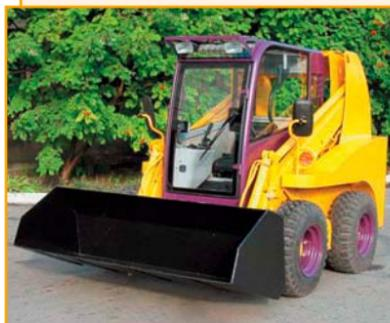
Ковш основной для МКСМ-800 предназначен для погрузки, перемещения и других работ с широким спектром грузов: удобрения, сыпучие материалы (опилки, стружка), снег, различные виды грунта. Может использоваться в качестве отвала для перемещения и разравнивания грунта.
