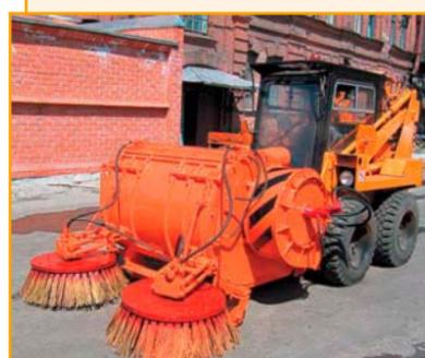
Вакуумное мусороборочное оборудование предназначено для механизированной очистки от мусора и пыли дворов, дорог, пешеходных дорожек и других площадей с твердым покрытием. Может использоваться для уборки цехов, складских помещений, ангаров. Не поднимает пыль и имеет возможность транспортировать собранный мусор. Расчетная производительность – 6 000 м<sup>3</sup>/мин. Эффективность уборки – не менее 95%. Скорость подметания 0,5–5,0 км/ч.
