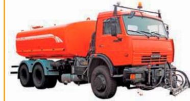
Комбинированные дорожные машины КО-829А, КО-829Д, КО-829Б, КО-829Б1 предназначены для всесезонного обслуживания городских и магистральных автомобильных дорог. В летний период используются с поливомоечным оборудованием для мойки и поливки дорожного полотна, в т. ч. для мойки дорожного полотна струями воды под высоким давлением. В зимний период – для очистки дорожного полотна от свежевыпавшего снега плужно-щеточным оборудованием и распределения противогололедных материалов.
