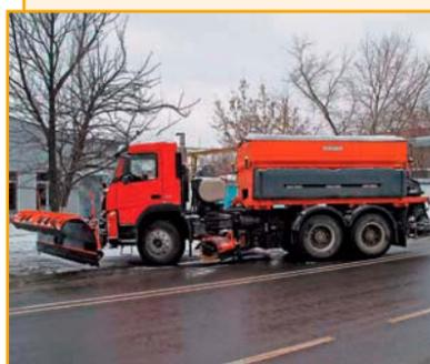
Дорожная машина ЭД-700 FM предназначена для всесезонного обслуживания скоростных автомагистралей с твердым покрытием. Модель шасси – автосамосвал VOLVO FM. Возможна установка зимнего и летнего оборудования. Объем бункера – распределителя жидких реагентов GILETTA CL12060 – 12 000 л.
