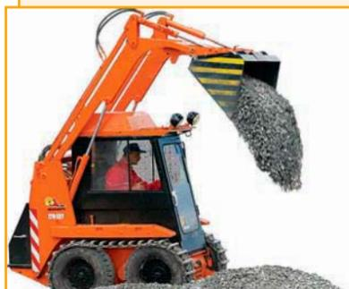
Универсальный малогабаритный погрузчик ПУМ-500У предназначен для механизации погрузочно-разгрузочных работ с грунтом I-IV категорий, сыпучими и мелкокусковыми материалами как в обычных, так и стесненных условиях; транспортно-складских работ со штучными грузами; для специальных работ (бурение скважин, очистка от снега, грязи дорог и тротуаров и др.).
