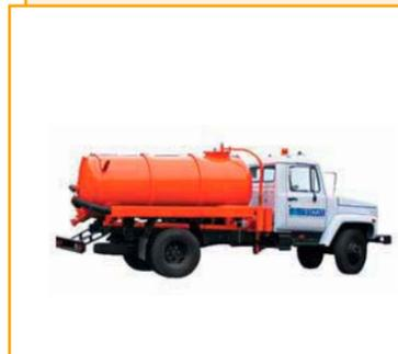
Машина 46161-01 (АВ-3,8) предназначена для вакуумной очистки выгребных ям, транспортировки сточных масс к местам утилизации. Может использоваться для механизированного заполнения, транспортировки и выгрузки любых технических жидкостей плотностью 1,0 г/см<sup>3</sup>.
