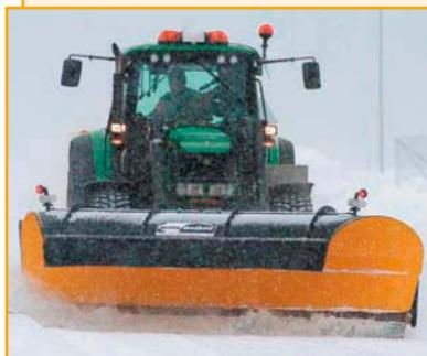
Отвалы Arctic Machine серии H специально сконструированы для установки на базовые тракторы мощностью от 120 л. с. типа МТЗ 1221, МТЗ 2022, John Deere 6920 и др. Работа отвалом серии H может осуществляться на скорости 30–50 км/ч. Функция поворота в обе стороны делает работу по содержанию дорог более эффективной. Благодаря полиуретановым пружинящим вставкам для крепления ножа не повреждается дорожная разметка и обеспечивается более чистый след уборки даже при незначительной колеиности.
