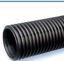
Трубы гофрированные двухслойные полиэтиленовые предназначены для наружной самотечной безнапорной канализации, систем дренажей, организации телефонной кабельной канализации. Производятся отрезками по 6 и 12 м, для их соединения используются муфты.
