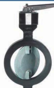
Затворы дисковые для регулирования газопотоков низкого давления ТУ 3741-025-29012225-2006. Серия ВА 99015. DN 40–1 200. PN 0,5. Применяются в качестве регулирующих устройств на трубопроводах общепромышленного назначения и объектах, подконтрольных Ростехнадзору. Служат для регулирования параметров газообразных рабочих сред посредством
