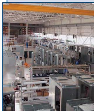
Станции управления с ЧРП (СЧРП) – низковольтные комплектные устройства.
