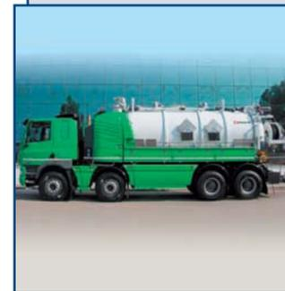
Компоновка отсеков – двухсекционная цистерна.
