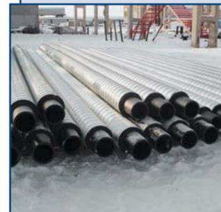
Трубы и фасонные изделия полиэтиленовые с тепловой изоляцией из пенополиуретана с защитной оболочкой ТУ СТО 471 14136-002-2006.
