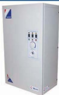
Электроотопительные котлы класса "Комфорт", серия WARMOS мощностью от 5 до 30 кВт. Отапливаемая площадь – от 50 до 600 м<sup>2</sup>. КПД прибора – 93%. Двух-, трехступенчатое изменение мощности. Плавное регулирование температуры теплоносителя термостатом в диапазоне 30–85 °С. Двойная защита от перегрева. ТЭНы из нержавеющей стали.
