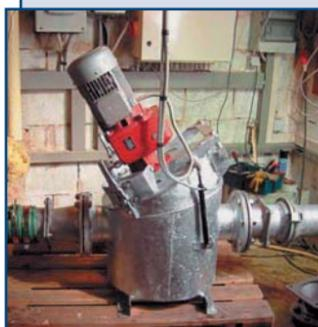
Измельчители грубой массы производства компании NETZSCH (Германия).
