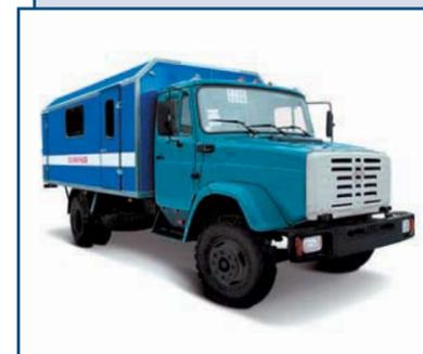
Передвижная аварийная водопроводно-канализационная мастерская предназначена для выполнения ремонтных работ на трубопроводах различного назначения: водопроводах, теплотрассах, безнапорных трубопроводах (канализация).
