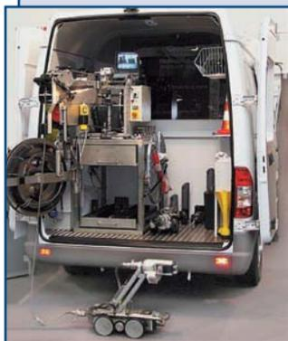
Оборудование фирмы RICO (Германия) позволяет исследовать каналы диаметром от 25 до 2 000 мм, длиной до 1 000 м проталкиваемыми камерами, роботами и телеинспекционными системами, встроенными в автомобиль.
