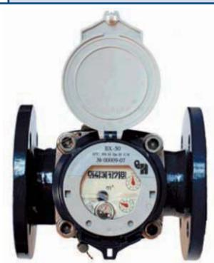
Счетчики холодной воды турбинные ВХ с диаметрами условного прохода 50, 80 и 100 мм предназначены для измерения и учета объема воды по СанПиН 2.1.4.1074, протекающей в системах холодного (от 5 до 50 °С) водоснабжения при давлении до 1,6 МПа (16 бар).
