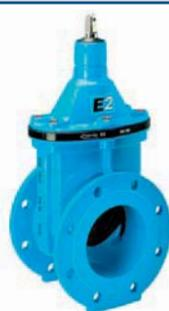
Упругозапирающаяся клиновидная задвижка E2 с гладким проходным каналом. Область применения – сети питьевого водоснабжения с допустимой рабочей температурой до +40 °С. DN 50–600.
