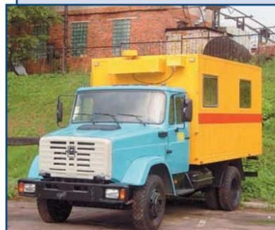
Аварийно-ремонтная машина "МАВР" предназначена для доставки бригады ремонтников и проведения профилактических, ремонтных и аварийных работ в канализационных, теплофикационных, водопроводных, электрических, газовых и иных инженерных сетях.
