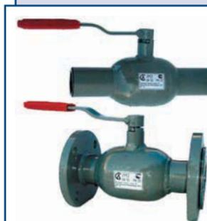
Шаровой кран фланцевый сварной предназначен для установки в качестве запорного устройства на трубопроводах для воды и пара (температура рабочей среды до +200 °С, PN 1,6–2,5 МПа); на объектах газового хозяйства (температура природного, топливного газа до +100 °С, PN 1,6 МПа); для масла и нефтепродуктов (температура рабочей среды до +90 °С) и др. слабоагрессивных сред. Подача рабочей среды в любом направлении.
