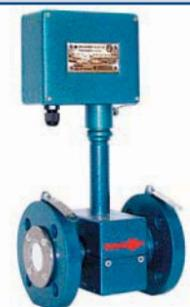
Преобразователь расхода электромагнитный "ЭМИР-ПРАМЕР-550" применяется для измерения расхода и объема холодной и горячей воды как в прямом, так и в обратном направлении движения потока. Футеровка – фторопласт, стеклоэмаль. Диаметр условного прохода – 15, 20, 25, 32, 40, 50, 65, 80, 100, 150 мм. Динамический диапазон – 1:1 000.
