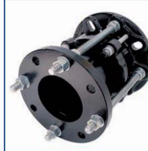
Демонтажные вставки предназначены для облегчения монтажа/демонтажа запорной арматуры, клапанов, насосных установок, фасонных частей. Простота и надежность конструкции позволяют сократить время монтажа/демонтажа примерно в 2-3 раза по сравнению с демонтажными вставками традиционной конструкции.
