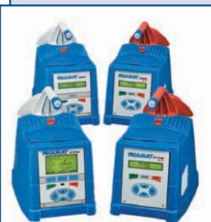
Аппараты серии FRIAMAT® применяются для газопроводов, водопроводов и канализации. Мощность – до 3,5 кВт. Сваривают муфты и фасонные изделия с закладными электронагревателями в диапазоне от 20 до 900 мм. Диапазон входных напряжений – от 180 до 270 В. Диапазон напряжений на выходе – от 8 до 50 В. В зависимости от типа аппарат может выполнять функцию протоколирования и обратного отслежи-
