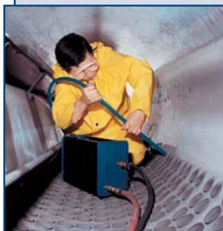
Компактный и мощный пневматический очиститель труб AWT-100 идеально подходит для всех типов труб, где использование электричества нежелательно либо недоступно.
