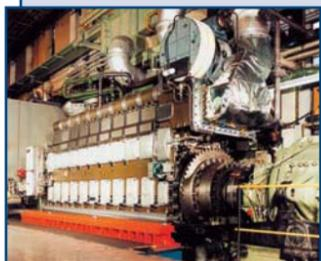
Газопоршневые двигатели ряда 36/45 в составе агрегатов применяются в качестве источника электроэнергии для промышленных предприятий, населенных пунктов в районах, удаленных от централизованных энергосистем, резервного источника питания на предприятиях с непрерывными технологическими процессами.
