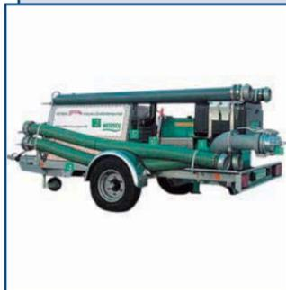
Мобильная установка Tornado Mobil производства компании NETZSCH (Германия) предназначена для перекачки сточных вод, обезвоженного осадка, активного ила, дозации полимера, других высоковязких сред с механическими включениями. Длительная автономность работы (до 23 часов). Мобильное исполнение на шасси. Производительность – до 1 000 м<sup>3</sup>/ч. Давление – до 4 атм. Самовсас – до 0,8 атм.
