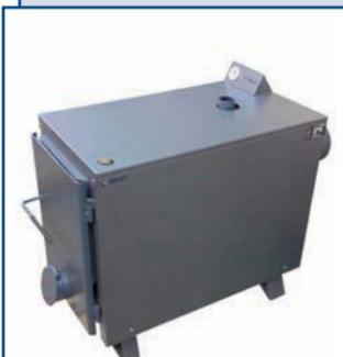
Твердотопливные котлы WARMOS-TT выпускаются двух видов. WARMOS-TT 18K и 25K дополнительно комплектуются регулятором тяги для автоматического регулирования доступа воздуха в камеру сгорания, ТЭНом с термостатом и термоограничителем для поддержания температуры воды. Диапазон регулирования тепловой мощности от минимальной (не более 30% номинальной) до номинальной.
