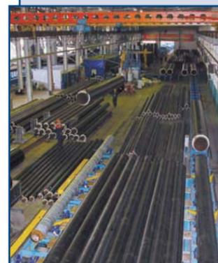
Производство изолированных пенополиуретаном труб с защитной оболочкой из полиэтилена и оцинкованной стали в соответствии с ГОСТ 30732-2006.
