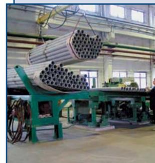
Трубы напорные хризотилцементные ВТ-9 диаметром 100–400 мм (ГОСТ 539-80) применяются для устройства напорных водопроводных систем для горячей и холодной воды, мелиоративных систем.
