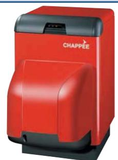
Напольные дутьевые котлы SEMPRA Progress представлены 18 моделями мощностью от 22 до 70 кВт. Секционный теплообменник из высокопластичного чугуна с высокой поверхностью теплообмена и идеальной аэродинамикой, имеет 4 прохода для движения дымовых газов. Возможна комплектация специально разработанной газовой либо дизельной горелкой со звукоизолирующим капотом серии Tigra. Благодаря изо-
