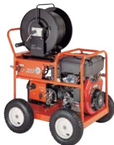
Водоструйные гидродинамические аппараты General Pipe Cleaners (США) для очистки труб.
