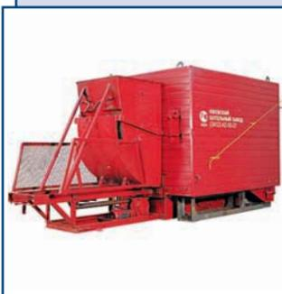
Котел стальной водогрейный водотрубный с механизированной подачей топлива и шлакозолоудалением. Мощность – от 0,93 до 2,5 МВт. Топливо – каменный или бурый уголь. КПД – 82% (уголь каменный), 72% (уголь бурый). Работа без накипи за счет вращательного движения воды. Механизированная подача топлива и шлакозолоудаление. Комплектуется механической топкой с шурующей планкой типа ТШП и блоком управления.
