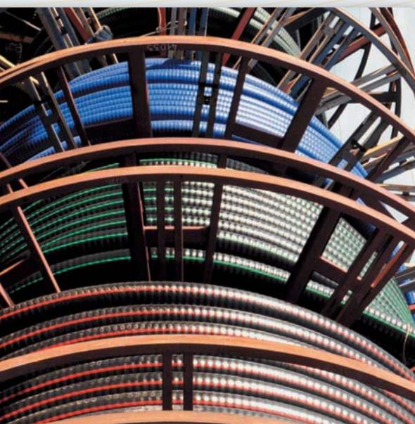
Трубы «ИЗОПРОФЛЕКС®» и «КАСАФЛЕКС» рассчитаны на бесканальную прокладку. Поставляются длинномерными отрезками (бухтами) и в подавляющем большинстве случаев не требуют стыков, благодаря чему существенно сокращаются сроки и стоимость монтажных работ.
