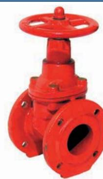
Задвижки с обрезиненным клином, невыдвижным шпинделем фланцевые применяются как запорное устройство на трубопроводах для воды при температуре от 5 до 150 °С и давлении до 1,6 МПа.
