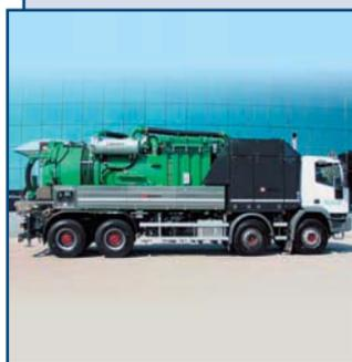
Вакуумные погрузчики серии ASM предназначены для специальных погрузочных работ твердых, порошкообразных и жидких материалов.
