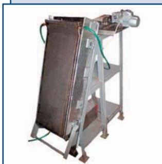
Производство оборудования для механотермической обработки небольших объемов осадков, образующихся при биологической очистке органических стоков.
