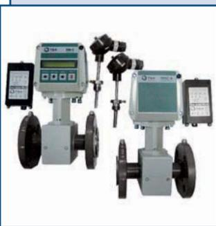
Теплосчетчик КМ-5 предназначен для измерения, учета и регистрации количества тепла, а также объема, массы, объемного и массового расхода и других параметров теплоносителя в одной или нескольких контролируемых системах одновременно. Работает с первичными преобразователями. Диаметр условного прохода – 15–300 мм.
