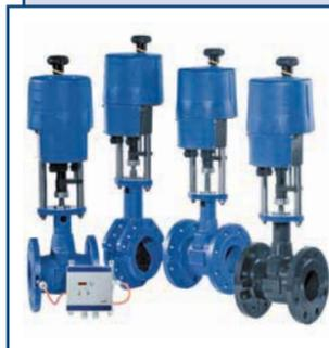
Регулирующий клапан BOA®-CVE C/CS/IMS/EKB применяется в системах водяного отопления с температурой рабочей среды до 120 °С, вентиляции и кондиционирования. Клапан с управляемыми микропроцессорами и "интеллектуальными" электрическими сервоприводами от 1 200 до 14 000 Н, электронное конфигурирование кривой расхода жидкости, установочного сигнала возможно посредством датчика РС.
