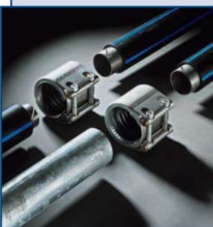
Муфты с жесткой осевой фиксацией для полимерных труб (ПЭ, ПП) и комбинированные для соединения полимерных труб с металлическими. Готовы к монтажу, свободно демонтируются и могут многократно использоваться при повторном монтаже. Поставляются в диапазоне диаметров от 40,0 до 355,0 мм (большие диаметры по запросу). Позволяют скомпенсировать угловое смещение
