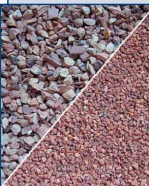
Высокоэффективные материалы для фильтрующего слоя очистки питьевых, технологических и сточных вод.
