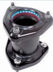
Специальные муфты UltraGrip предназначены для соединения труб разных диаметров и из разных материалов: чугуна, стали, ПВХ, ПЭ в различных сочетаниях и без дополнительных приспособлений. Возможно использование в сложных погодных условиях: высокая влажность, низкая температура.
