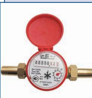
Диаметр условного прохода – 15 мм. Измеряемая вода – холодная и горячая по СанПиН 2.1.4.1074-01.
