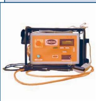
Аппараты для сварки полимерных труб деталями с закладными нагревательными элементами известной марки O.M.I.S.A. (Италия).
