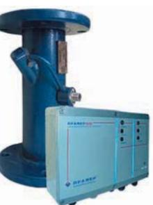
Счетчик жидкости ультразвуковой "ПРАМЕР-510" применяется для измерения расхода и объема холодной и горячей воды как в прямом, так и в обратном направлении движения потока. Диаметр условного прохода – от 50 до 2 000 мм. Погрешность – 1%.
