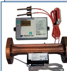
Теплосчетчик ультразвуковой MULTICAL UF предназначен для измерения и коммерческого учета количества тепловой энергии в системах теплоснабжения у производителей и потребителей тепловой энергии.
