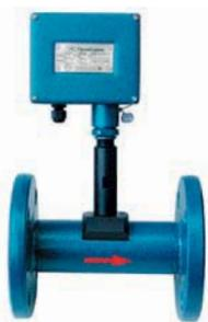
Преобразователь расхода вихревой электромагнитный "ВЭПС®" применяется для измерения расхода и объема холодной и горячей воды. Диаметр условного прохода – 20, 25, 32, 40, 50, 80, 100, 150, 200, 250, 300 мм. Погрешность – 1,5%. Диапазон измерения – 0,3÷1 600 м³/ч. Подробные технические характеристики в Руководстве по эксплуатации 4213-017-12560879 РЭ.
