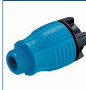
Новое поколение фитингов Hawle Fit было разработано для соединения полиэтиленовых труб наружного диаметра от 25 до 63 мм и для рабочего давления до Ру 1,6 МПа.
