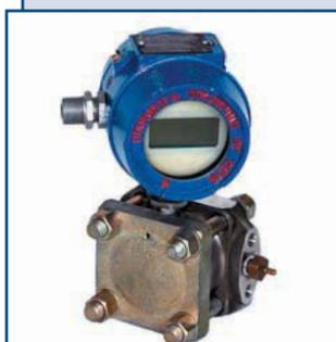
Преобразователь Сапфир-22МР предназначен для непрерывного преобразования значения измеряемого параметра – давления абсолютного, избыточного, разрежения, давления-разрежения, гидростатического и разности давлений нейтральных и агрессивных сред в унифицированный токовый выходной сигнал. Предел допускаемой основной погрешности до 0,1.
