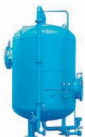
Осветлительные фильтры ФОВ насыпного типа представляют собой вертикальные однокамерные цилиндрические аппараты с эллиптическими днищами. Укомплектованы нижними и верхними распределительными устройствами, фронтом наружных трубопроводов, запорно-регулирующей арматурой, КИП.
