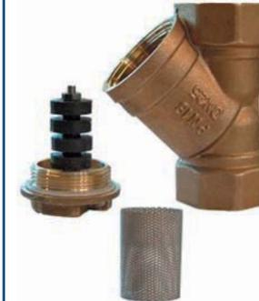
Магнитные фильтры "Туман" бытовой серии представляют собой модернизированный вариант муфтовых латунных фильтров для воды. Модернизация заключается в установке в корпусе стандартного фильтра специальной магнитной системы на основе мощных постоянных магнитов для улавливания частиц ржавчины и окислы из воды.
