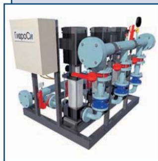
Насосные установки ГидроСи предназначены для повышения и поддержания давления в системах холодного, горячего водоснабжения, а также для пожаротушения и др. Выпускаются в полной заводской готовности различного исполнения и комплектации: с рабочими и резервными насосами, смонтированными на единой раме-основании, обвязанными запорной арматурой, со щитом управления и контрольно-измерительными приборами.
