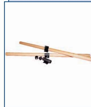
Перфорированные аэраторы «КРЕАЛ» относятся к трубчатым, применяются на объектах станций аэрации для создания бескислородных зон и циркуляционных потоков. Используются для перемешивания водной среды, когда ее насыщение кислородом необходимо свести к минимуму.
