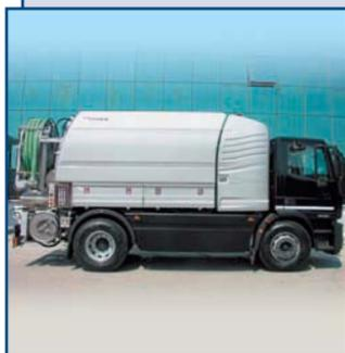
Компоновка отсеков – односекционная цистерна плюс внешние баки.
