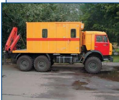
Автомобили аварийно-технической службы с кран-манипуляторами предназначены для выполнения работ и ликвидации аварий на объектах водоканалов и теплосетей.
