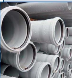
Максимальная температура эксплуатации до +95 °С. Трубы и соединительные элементы имеют раструбную конструкцию и укомплектованы двухлепестковыми уплотнительными кольцами компании M.O.L. (Германия, Польша), которые полностью компенсируют температурные расширения и обеспечивают надежную фиксацию уплотнительного кольца в раструбе.
