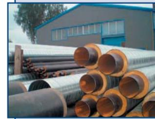
Трубы ППУ представляют собой трехслойную, монолитную конструкцию, состоящую из стальной трубы, теплоизолирующего слоя пенополиуретана и защитной оболочки из полиэтилена для подземной прокладки или оцинкованной спирально-замковой стали для воздушной прокладки.
