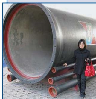
Поставка труб из ВЧШГ (высокопрочного чугуна) в комплекте с фитингами. Вся продукция соответствует требованиям ISO 2531 и сертифицирована для питьевого водоснабжения в России. Диаметр (DN) – от 80 до 3 000 мм. Рабочее давление – 16 Атм.
