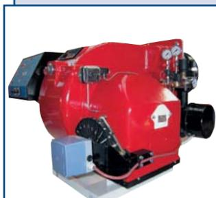
Горелки серии РВУ работают на тяжелых видах жидкого топлива с вязкостью до 16 °Е при 80 °С, с содержанием воды до 30% и механических примесей. Применяется пневматическое распыление топлива с помощью сжатого воздуха (от компрессора) или пара с целью достижения большей эффективности его сжигания.
