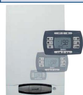
Настенные газовые котлы NUVOLA-3 Comfort имеют встроенный накопительный бойлер из нержавеющей стали емкостью 60 л. Нагрев 450 л воды за первые 30 мин при  $\Delta t = 30^\circ\text{C}$ . Два диапазона регулирования температуры в системе отопления (30–85 °C и 30–45 °C), возможность работы только в режиме "теплый пол". Модель NUVOLA-3 B40 имеет стационарную панель управления и встроенный накопительный эмалированный бойлер емкостью 40 л.
