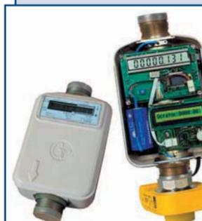
Ультразвуковой счетчик газа УБСГ 001 типоразмеров G4; G6; G10 предназначен для измерения объема газа в газопроводах низкого давления и других газообразных неагрессивных топлив в ЖКХ и быту.
