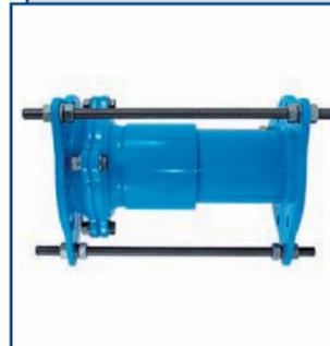
Инновационный фланцевый, телескопический фитинг Hawle VARIO со встроенным шаровым шарниром. Обеспечивает всестороннее отклонение до 10 градусов. DN 50–200.
