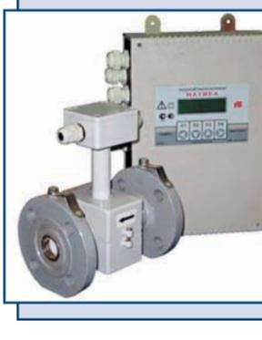
Электромагнитный принцип действия. Диаметр условного прохода – 15, 25, 32, 40, 50, 80, 100, 150, 200, 300 мм. Динамический диапазон измерений 250÷1 000. Высокая стабильность параметров и надежность. Регистрация нештатных ситуаций в работе систем теплоснабжения с формированием кода неисправности. Возможность передачи данных на ПК по интерфейсу RS-232, 485, Modbus и Ethernet.
