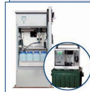
Пробоотборники WaterSam® используются для отбора проб из открытых водных объектов, каналов и коллекторов, а также напорных труб.
