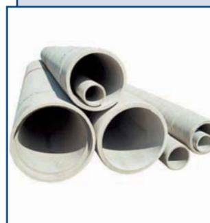
Напорные трубы ВТ-9 диаметром 100–400 мм (ГОСТ 539-80) применяются для устройства сетей отопления. В комплекте к трубам идут муфты хризотилцементные и резиновые кольца, работающие по принципу самоуплотнения. Муфты и кольца реализуются из расчета одна муфта плюс два кольца на одну трубу.
