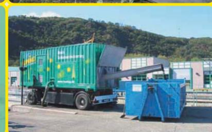
Мобильные осушительные и шламоуплотняющие комплексные установки мощностью от 15 до 120 м<sup>3</sup>/ч.
