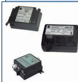
Источник высокого напряжения ИВН предназначен для искрового розжига газовых запальных горелок котельных агрегатов и служит для воспламенения топлива между электродом и корпусом установки. Рекомендуется для применения на запально-защитных устройствах L < 1 000 мм. Модификация на питание – 24 В. Схема преобразования частоты с 50/60 Гц до 20 кГц.
