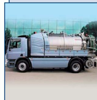
Компоновка отсеков – двухсекционная цистерна.
