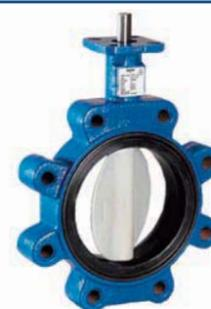
Затворы поворотные дисковые серии 50/52 применяются для регулирования и полного перекрытия потока рабочей среды. DN 50–600 мм. Класс герметичности по ГОСТ 9544-93 – "А". Области применения – системы тепло- и водоснабжения, газораспределительные системы, топливная, химическая, пищевая и другие отрасли промышленности. Рабочие среды – вода, пар, природный газ, нефтепродукты, пищевые и агрессивные среды.
