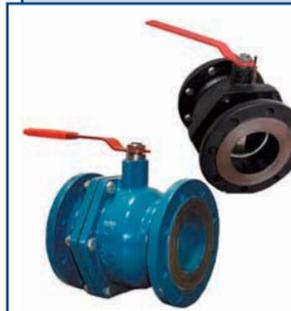
Шаровой кран фланцевый 11ч 37 Пф-4 применяется в качестве запорного устройства на трубопроводах для воды и пара (температура рабочей среды до +200 °С, PN 1,6–2,5 МПа); на объектах газового хозяйства (температура природного, топливного газа до +100 °С, PN 1,6 МПа); для масла и нефтепродуктов (температура рабочей среды до +90 °С) и др. слабоагрессивных сред. Подача рабочей среды в любом направлении.
