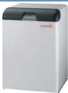
Напольные газовые котлы EDENA 1 и 2 Progress представлены 17 моделями мощностью от 20 до 70 кВт. Секционный теплообменник из высокопластичного чугуна с профильными ребрами имеет большую поверхность теплообмена и идеальные аэродинамические свойства. Комплектуется стандартной атмосферной горелкой и газовым мультиблоком.
