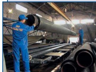
Производство и поставка фасонных изделий с защитной оболочкой из оцинкованной стали для надземной прокладки и с защитной оболочкой из полиэтилена для подземной бесканальной прокладки.
