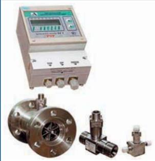
Расходомер-счетчик турбинный предназначен для измерения объема и объемного расхода жидких сред, в т. ч. водоспиртовых растворов, с вязкостью до 100 мм<sup>2</sup>/с (СТ). Применяется при технологических и коммерческих операциях, в различных технологических процессах, в т. ч. в нефтехимической и пищевой промышленности, теплоэнергетических установках, стендовом оборудовании.
