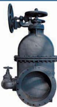
Задвижки параллельные с невыдвижным шпинделем фланцевые применяются как запорное устройство для холодной воды, протекающей в трубопроводах, канализациях и водопроводах при температуре от 5 до 40 °С и давлении до 1,0 МПа (10 кгс/см<sup>2</sup>).
