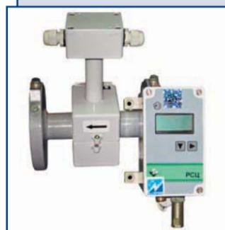
Электромагнитный принцип действия. Диаметр условного прохода – 15, 25, 32, 40, 50, 80, 100, 150, 200, 300 мм. Широкий диапазон измерения расхода – 0,1–100%. Наличие токового выхода – 0÷5; 0÷20; 4÷20 мА. Наличие импульсного выхода. Малое потребление мощности: не более 2 Вт с включенной подсветкой индикатора и не более 1,4 Вт с отключенной.
