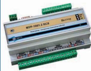
Регистратор предназначен для приема, обработки, анализа и хранения информации, характеризующей хронологию изменения параметров различного рода процессов. Максимальное количество хранимых баз данных – 8. Максимальное количество подключаемых внешних устройств – 255.
