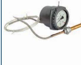
Термометр манометрический электроконтактный ТКП-100Эк предназначен для непрерывного измерения температуры воды, масла и других жидкостей и управления внешними электрическими цепями нагревательных элементов или установок.
