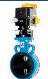
Затворы дисковые с эластомерными уплотнениями ТУ 3741-001-29012225-2004. Серии ВА 99001–ВА 99006. Класс герметичности по ГОСТ 9544 – А. DN 40–1 200. PN 6–16. Используются в качестве запорных и регулирующих устройств на трубопроводах общепромышленного назначения и объектах, подконтрольных Ростехнадзору.
