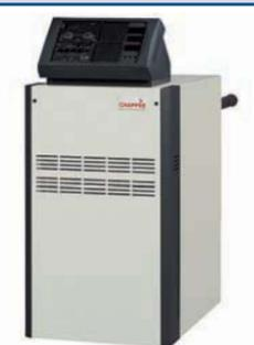
Напольные газовые котлы EDENA 3 и 4 Progress с чугунным теплообменником и атмосферной горелкой представлены 12 моделями мощностью от 82 до 348 кВт. Секционный теплообменник из высокопластичного чугуна с профильными ребрами имеет большую поверхность теплообмена и идеальные аэродинамические свойства. Котел комплектуется стандартной атмосферной горелкой и газовой рампой с прессостатом минималь-
