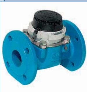
Турбинные счетчики холодной и горячей воды ВМХ, ВМГ работают в диапазоне температур от 5 до 50 °С (холодное водоснабжение) и от 5 до 150 °С (горячее водоснабжение) и давлением в трубопроводе 1,6 МПа.
