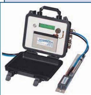
Расходомер Mainstream IV применяется для мониторинга сетей водоотведения. Портативный расходомер предназначен для определения расхода воды в безнапорных системах – частично заполненных трубопроводах и открытых каналах. Отличается увеличенным временем автономной работы от батареи, емкостью памяти и компактностью размеров.
