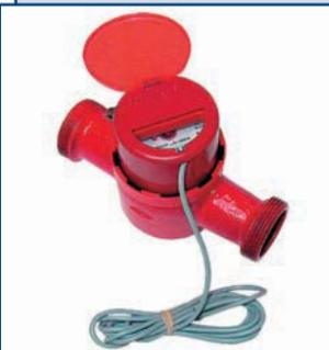
Универсальные счетчики холодной и горячей воды СКБ работают в диапазоне температур от 5 до 90 °С и давлении в трубопроводе до 1,6 МПа.
