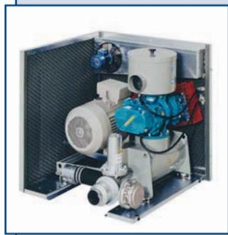
Области применения – подача воздуха в аэротенки и песколовки, промывка фильтров, подготовка питьевой воды; транспорт взрывоопасных газов; пневмотранспорт сыпучих материалов.
