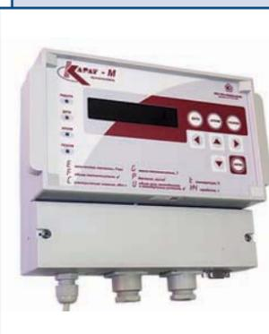
Вычислитель КАРАТ-М включен в состав измерительного комплекса КАРАТ-М. Применяется с измерительными преобразователями расхода, температуры и давления, имеющими стандартизованный токовый, частотный или числоимпульсный выход, а также с термопреобразователями сопротивления.
