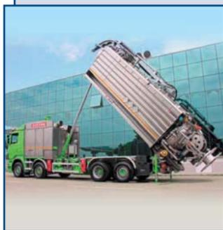
Вакуумные погрузчики серии ECOSTORM предназначены для уборки последствий экологических аварий, цементной россыпи, щебня, сухой и мокрой почвы, седимента, жидких и полужидких смесей, очистки дренажных каналов, кюветов дорог, зумпфов в глубине с 8 до 20 м, очистки труднодоступных мест на обогатительных, цементных, мусоросжигающих и других заводах.
