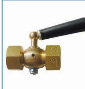
Краны применяются для монтажа манометров в технологическую линию. Рабочее давление – не более 1,6 МПа. Рабочая температура – не более 200 °С. Материал – латунь, нержавеющая сталь.
