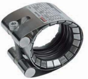
Обжимные муфты из нержавеющей стали STRAUB – ECO-GRIP® предназначены для соединения труб в диапазоне давлений до 6 бар. Благодаря новой концепции и запатентованной конструкции муфты соединение труб с гладкими концами стало более экономичным.
