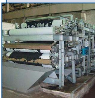
Производство ленточных фильтр-прессов типа ЛФ-П и сгустителей типа ЛФ-С производительностью от 1 до 100 м³/ч.
