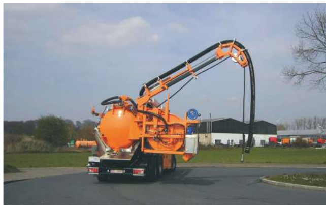
Телескопическая стрела с вакуумным рукавом
