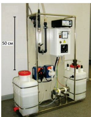
Установка ЭПМ супермалой производительности с бес- корпусным электролизером
