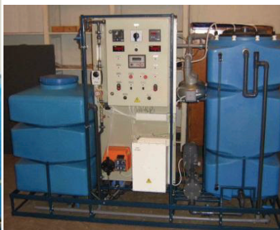
Электролизная установка ЭПМ- 30 производительностью 30 кг а.х./сут
