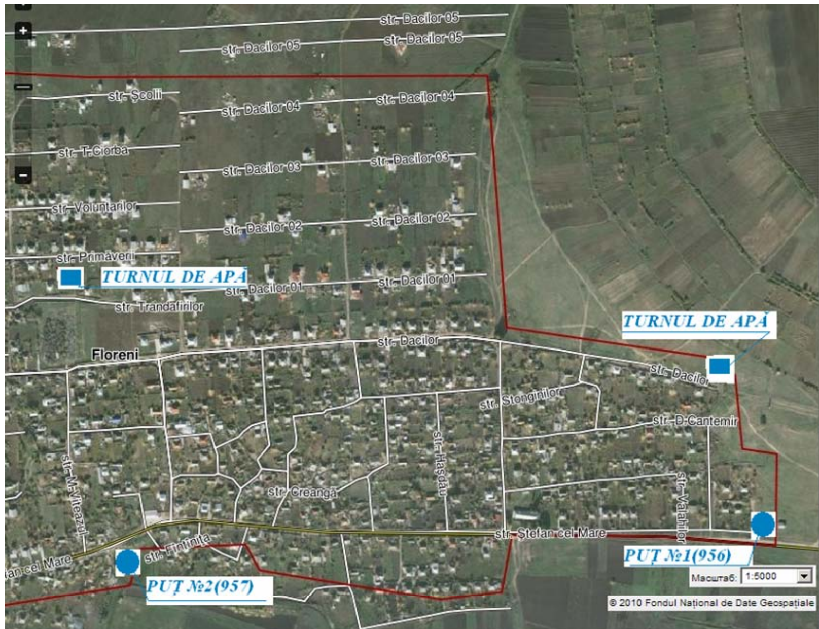
Des. №3. Planul amplasării stațiilor de pompare a puțurilor forate și rezervorilor de apă din com.Floreni.
