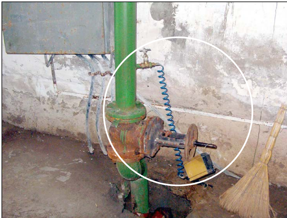
Фото 2.1. Замеры давления воды в напорном трубопроводе повысительной насосной станции.
