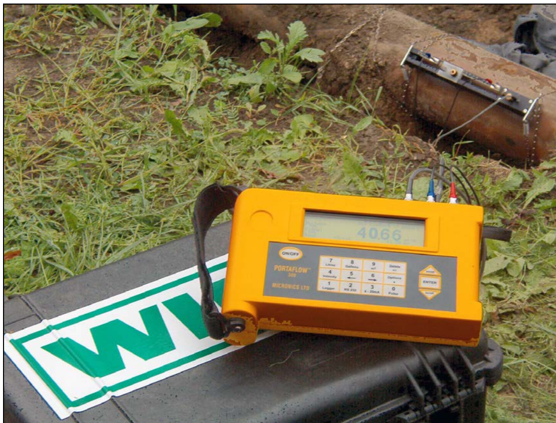
Фото 2.2. Замеры расхода воды в напорном трубопроводе НС-II (в шурфе).
