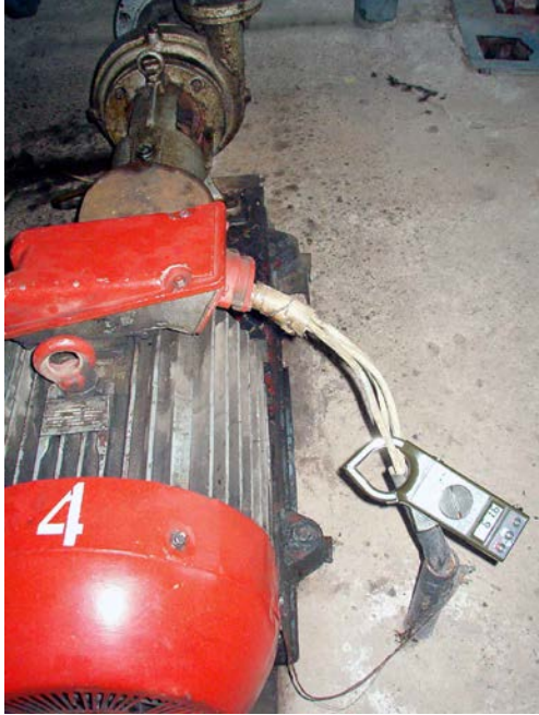
Foto 2.3. Măsurarea tensiunii și curentului la electromotor.
