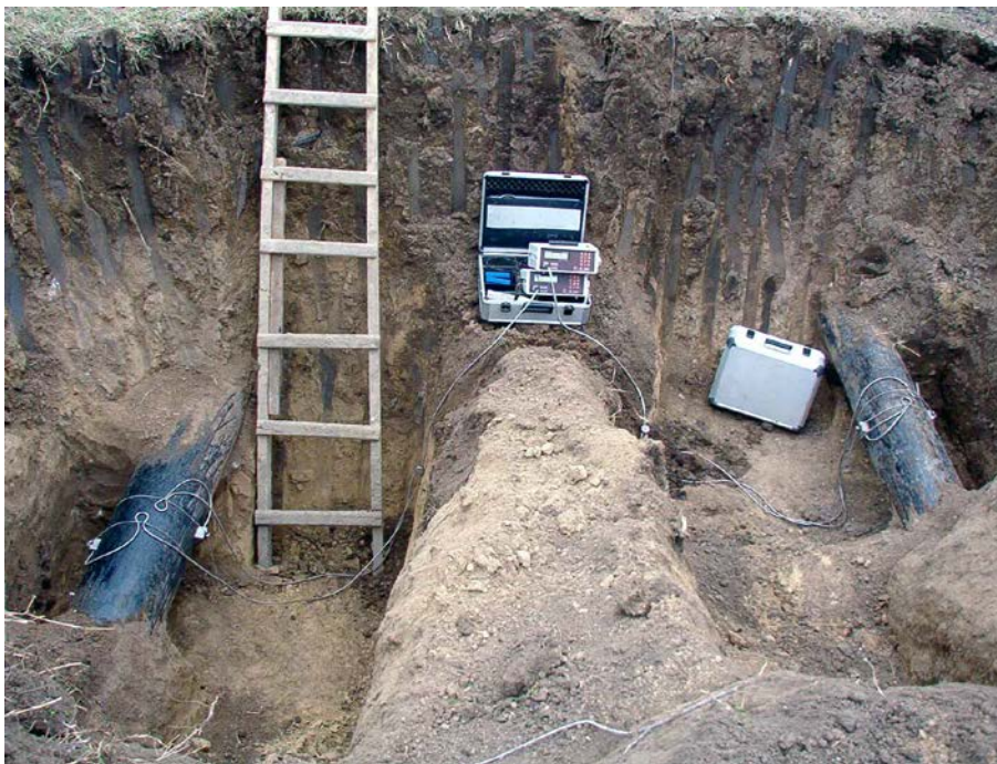
Foto 2.1. Măsurarea debitului de apă (în sondaj) pe 2 rețele de refulare.
