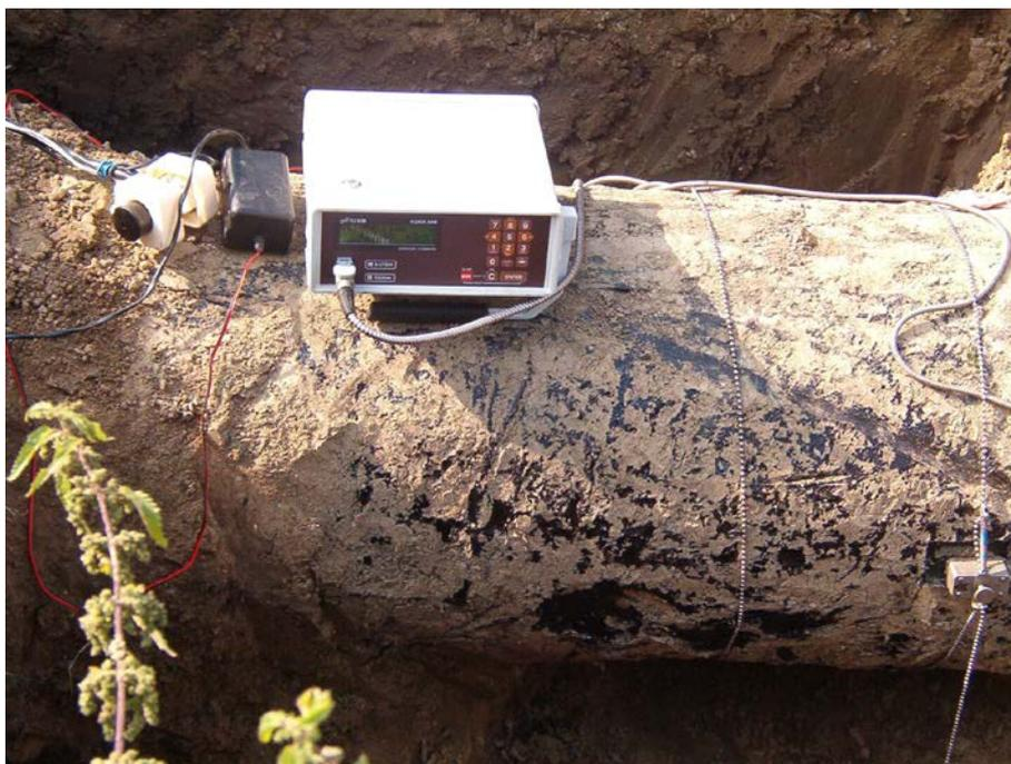
Фото 2.1. Замеры расхода воды (в шурфе) на напорном трубопроводе.
