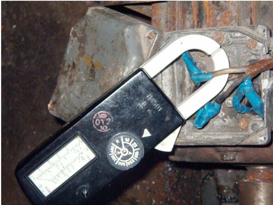
Фото 2.3. Замеры напряжения и силы тока у двигателя насосного агрегата.
