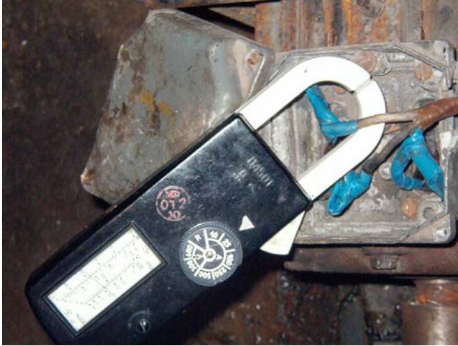
Foto 2.3. Măsurarea tensiunii și intensității curentului la motor electric a pompei.
