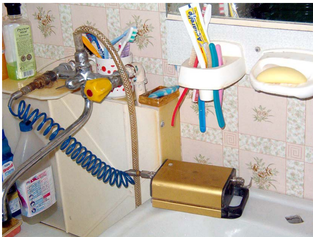
Фото 1.3.2. Замеры давления воды в водопроводе в квартире у потребителя.
