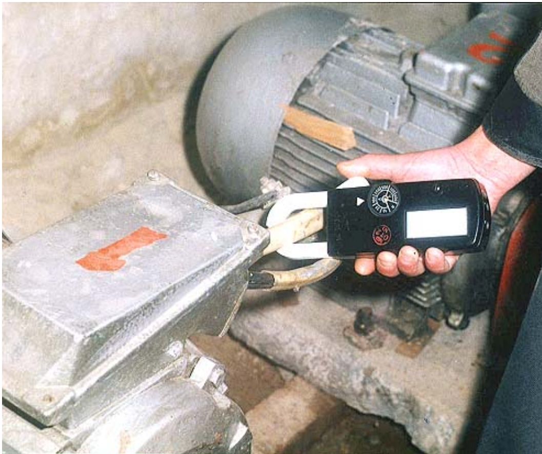
Фото 1.3.3. Замеры напряжения и силы тока у двигателя насосного агрегата.
