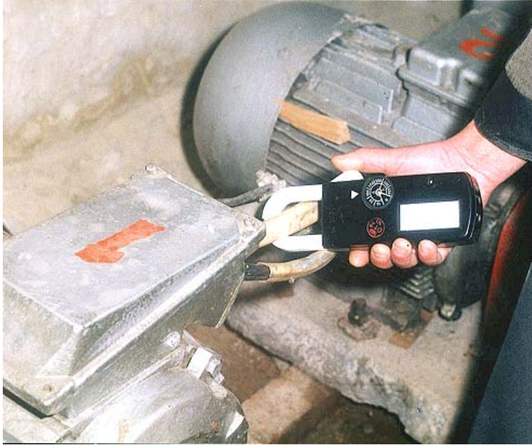
Foto 1.3.3. Măsurarea tensiunii și intensității curentului la motor electric a pompei.
