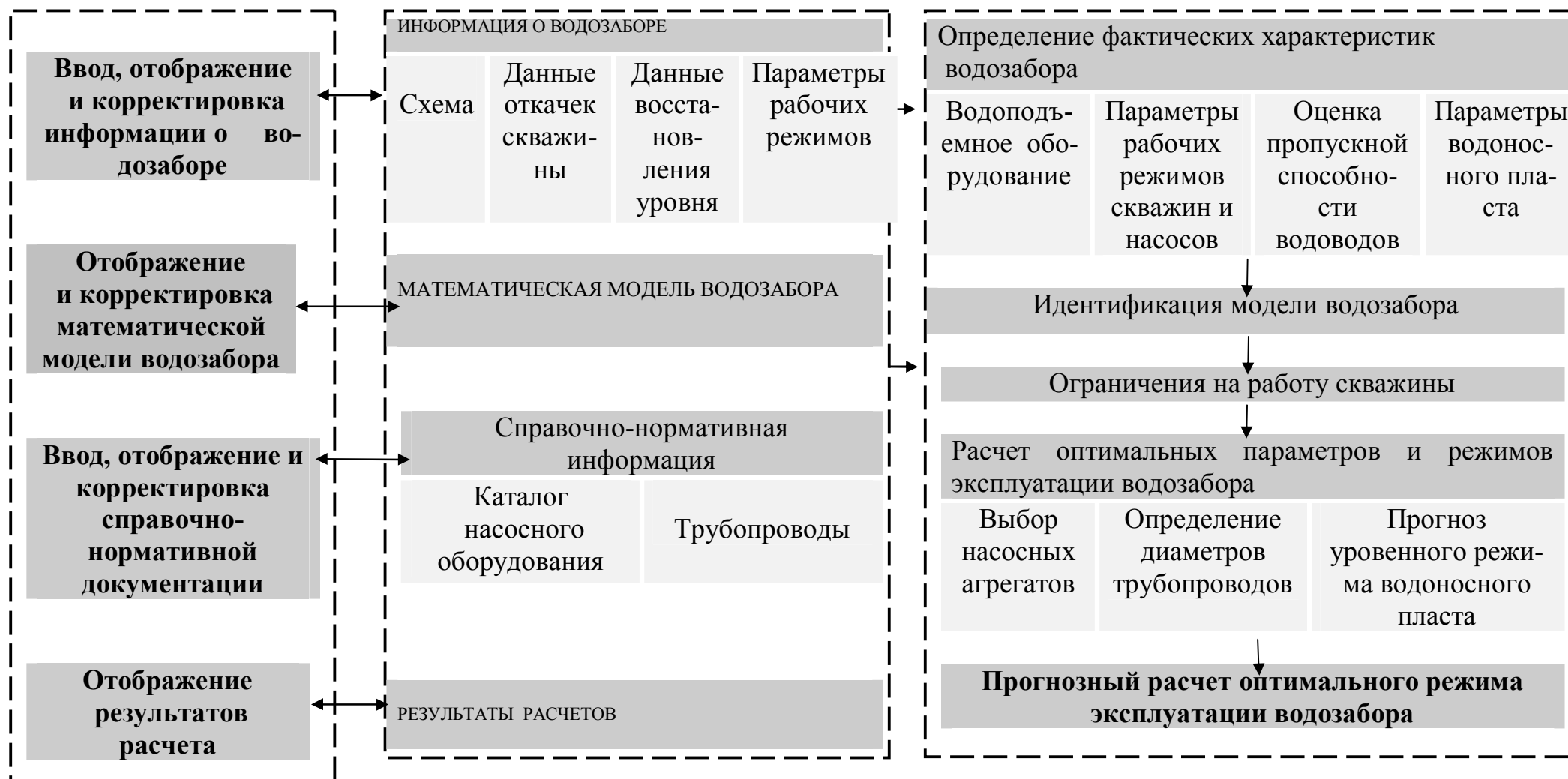
Рис.2.7 Принципиальная схема автоматизированной системы обработки и анализа материалов обследования водозабора
