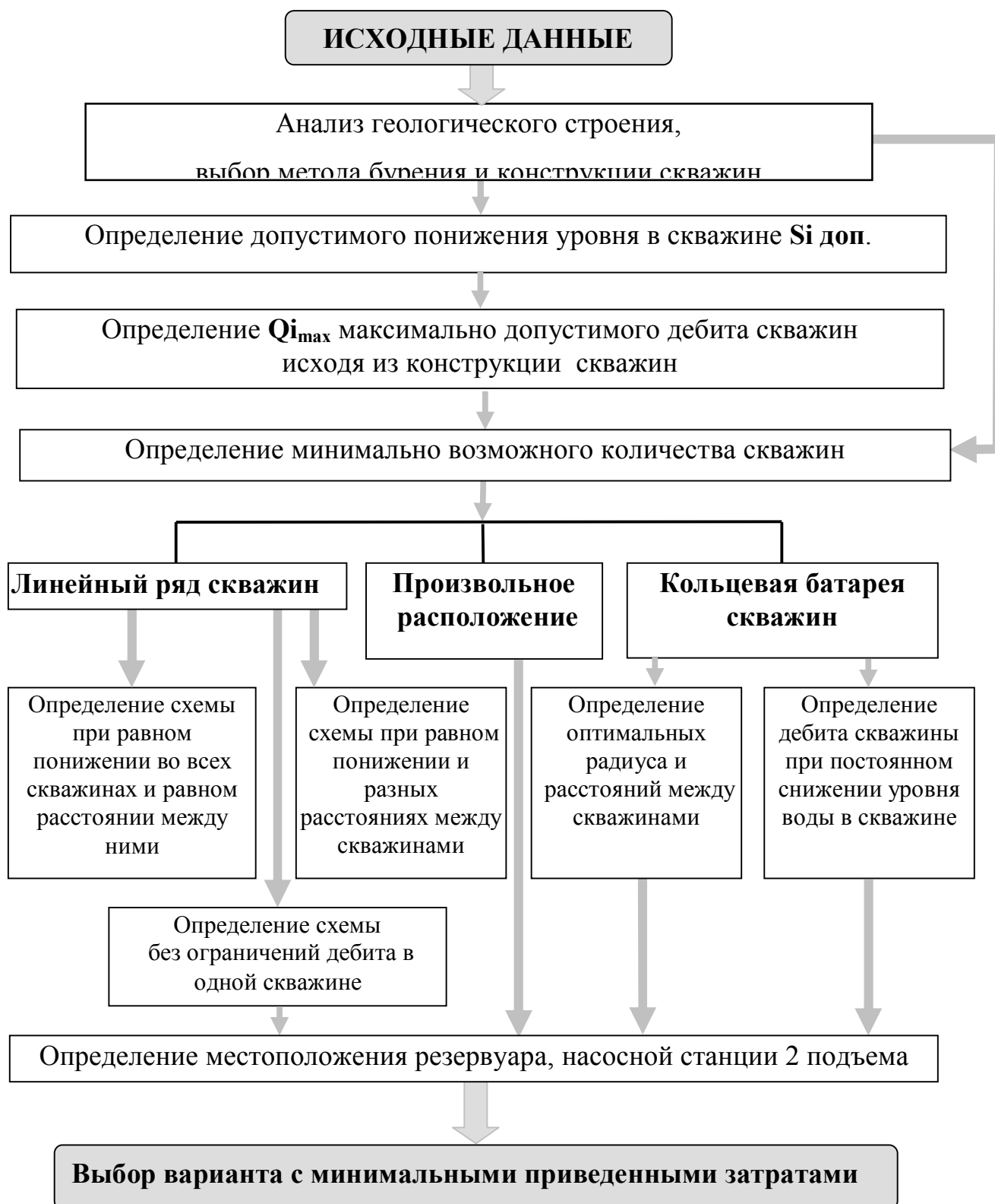
Рис. 8.1 Блок-схема задач выбора рациональной схемы скважинного водозабора
