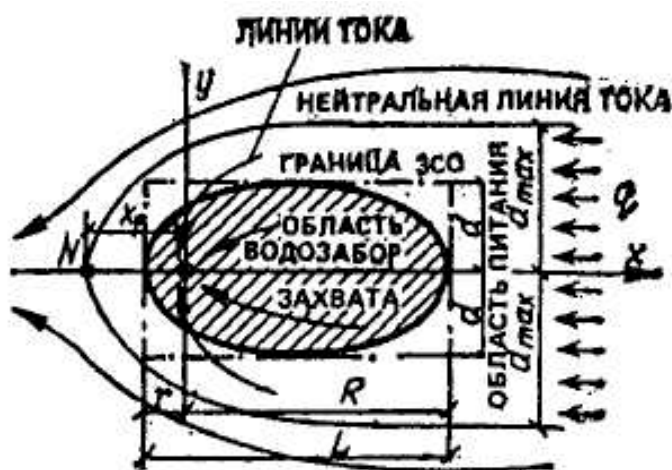
Рис. 36. Схема фильтрации подземных вод в сторону водозабора
