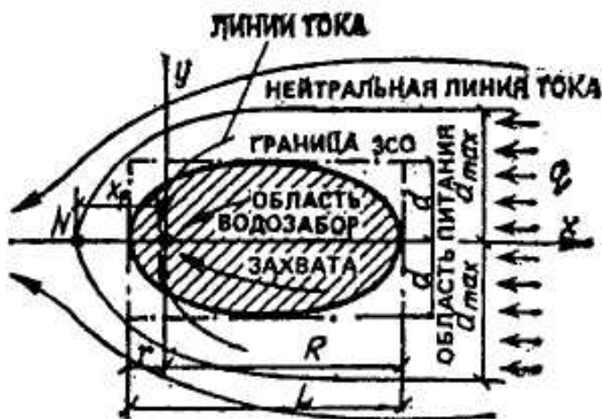
Рис. 36. Схема фильтрации подземных вод в сторону водозабора
