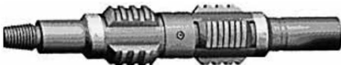
*Назначение:* Скрепер предназначен для очистки внутренней поверхности обсадных или насосно-компрессорных колонн от перфорационных заусенцев, ржавчины, цементной корки, парафина и других отложений.
