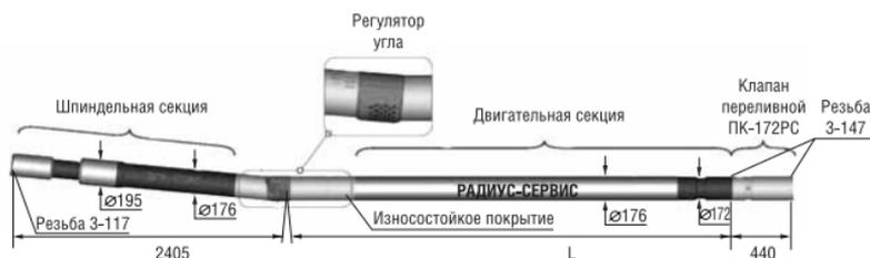
Двигатель предназначен для бурения наклонно-направленных и горизонтальных скважин долотами диаметром 215,9...269,9 мм с использованием промывочной жидкости плотностью до 1500 кг/м<sup>3</sup> при забойной температуре до 100 °С.
