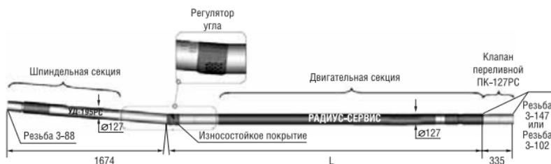
Двигатель предназначен для бурения наклонно-направленных и горизонтальных скважин долотами диаметром 142,9...171,5 мм, реззки и бурения боковым стволов, капитального ремонта скважин с использованием промывочной жидкости плотностью до 1500 кг/м<sup>3</sup> при забойной температуре до 100 °С.
