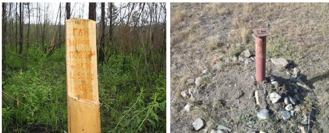
Рис. 7.22. Фото грунтового репера ГДН (установленный институтом ГипроДорНИИ)
