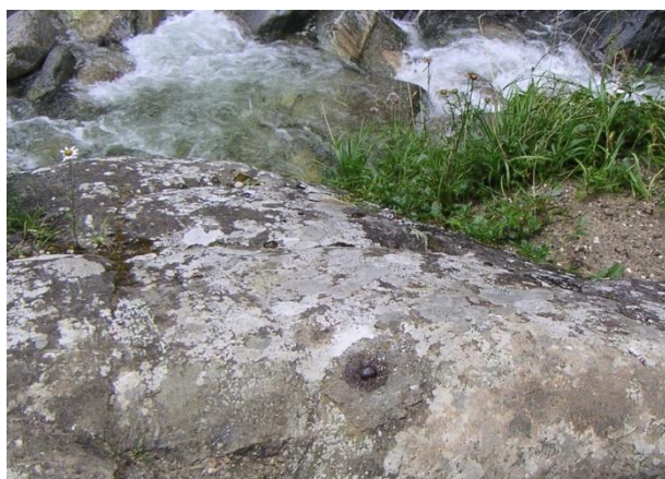
Рис. 7.25. Фото государственного грунтового репера, установленного в горной местности
