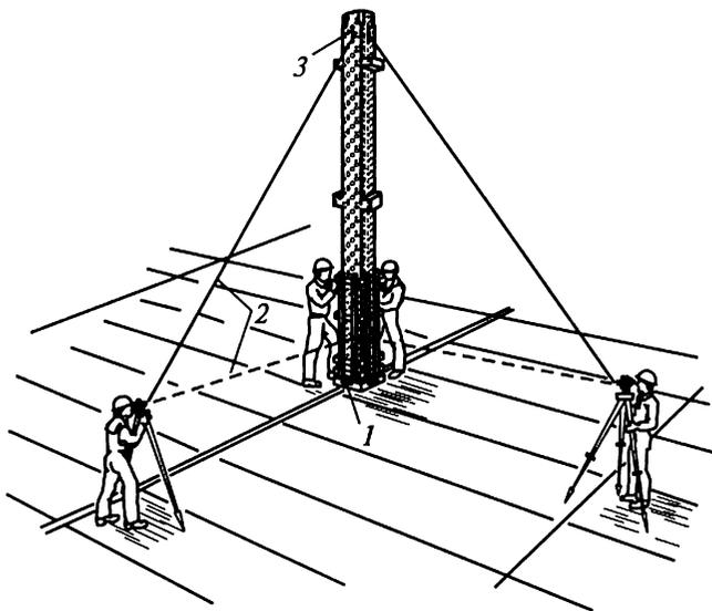
Рис. 20.21. Выверка колонн по вертикали:
