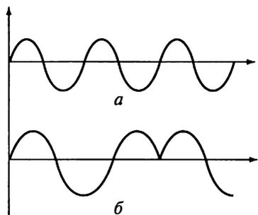
Рис. 14.5. Импульсно-фазовая модуляция:
