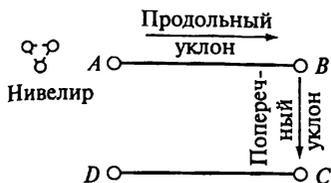
Рис. 15.5. Схема построения в натуре линий проектных уклонов
