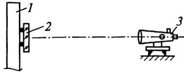
Рис. 22.9. Схема установки конструкции по вертикали автоколлимационным способом:
