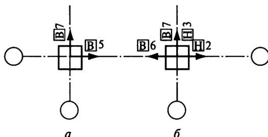
ис. 30.2. Примеры указания действительных отклонений осей элементов от разбивочных осей на плане для свай (а) и колонн (б)
