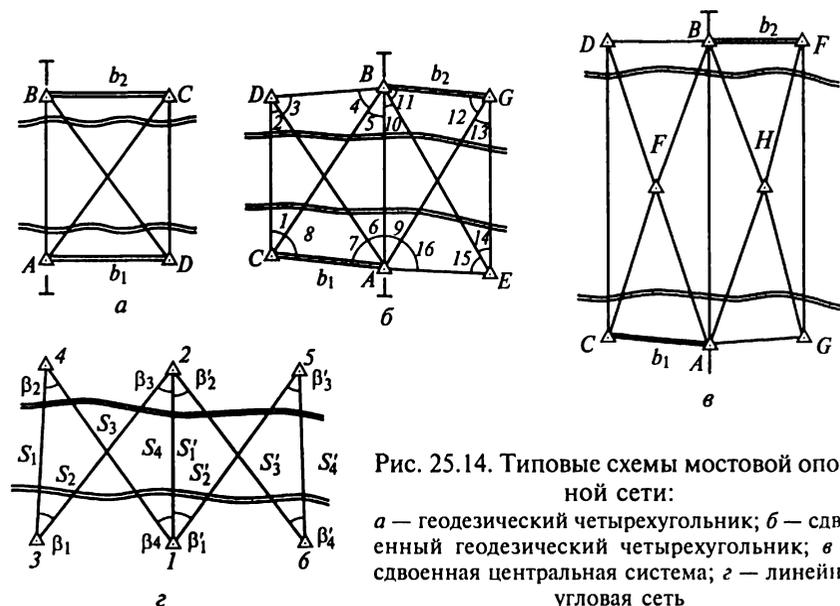
Рис. 25.14. Типовые схемы мостовой опорной сети:
