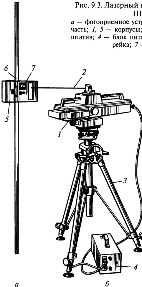
лазерного прибора составляет  $180^\circ$ . Погрешность измерения от лазерного пучка или плоскости до контролируемой поверхности  $\pm 3$  мм при дальности действия 150 м.
