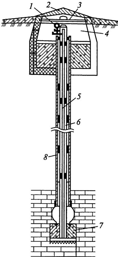
Рис. 24.1. Биметаллический репер:
