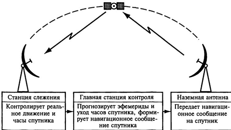
Рис. 14.8. Измерение, прогнозирование и обновление эфемерид спутника
