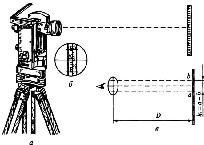
Рис. 6.8. Оптический дальномер:
