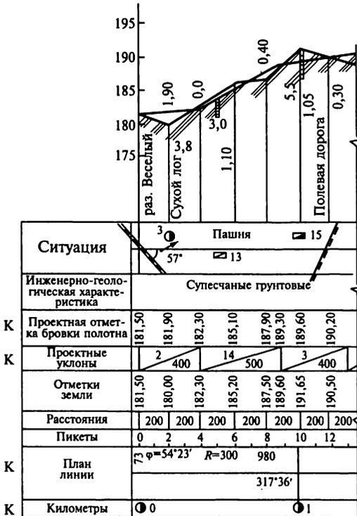
Рис. 25.7. Продольный профиль участка трассы железной дороги
