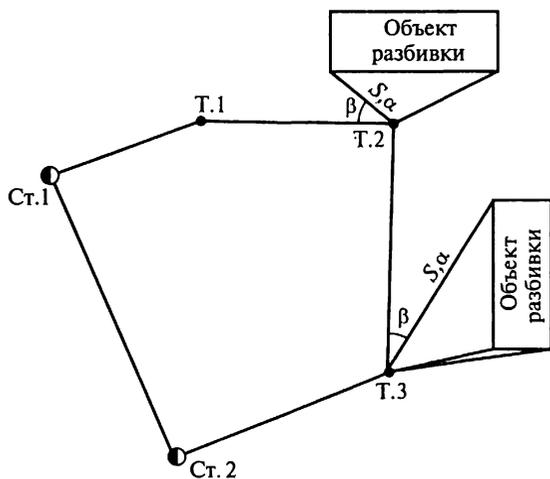
Рис. 21.3. Схема разбивки с удаленным расположением свободной станции
