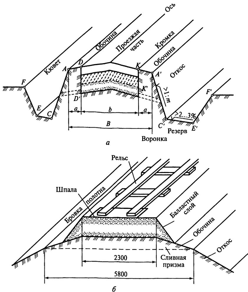
Рис. 25.11. Строение дорожного полотна:
