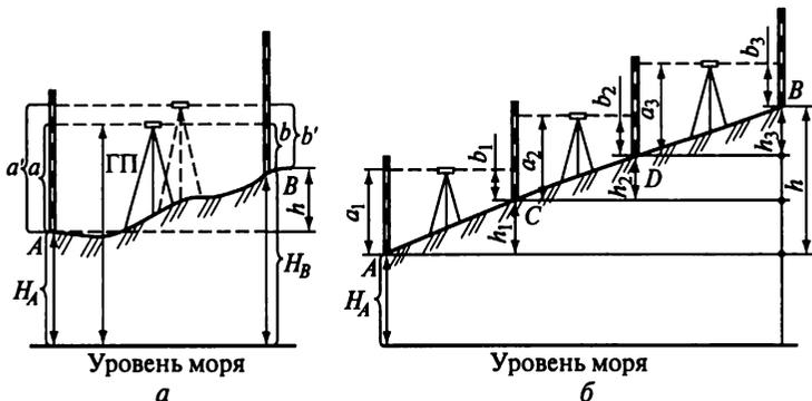
Рис. 7.9. Схемы нивелирования:
