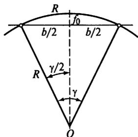
Рис. 27.6. Схема определения длин хорд на кривой
