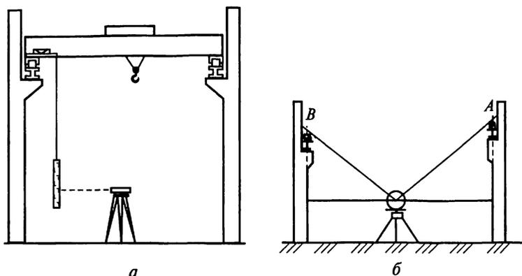
Рис. 21.6. Схемы определения высотного положения рельсов подкранового пути:
