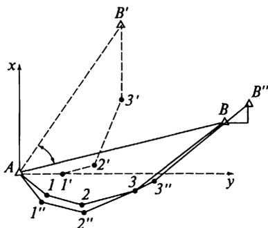
Рис. 13.9. Схема полигонометрического хода без примычных углов
