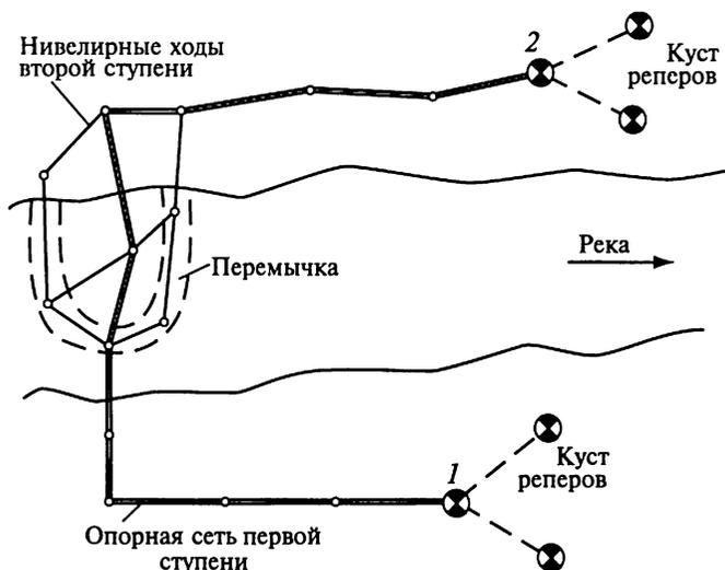
Рис. 26.3. Высотная опорная сеть для строительства гидроузла
