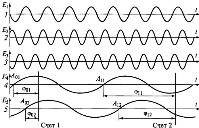
Рис. 14.13. Принцип фазовых измерений в двух каналах:
