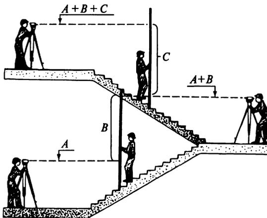
Рис. 7.10. Использование нивелира для переноса отметок на строительстве
