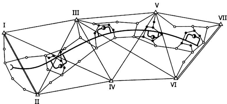
Рис. 27.9. Схема планового геодезического обоснования тоннеля:
