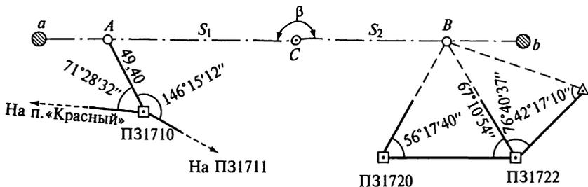
Рис. 17.4. Схема выноса в натуре оси линейного сооружения
