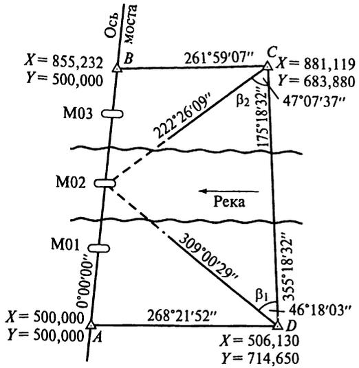
вают поправки за температуру и компарирование мерного прибора. При использовании светодальномера вначале разбивку выполняют приближенно. Затем светодальномером измеряют расстояния до полученных точек, сравнивают их с проектными значениями и смещают предварительно найденные точки по оси моста в проектное положение. Створ оси моста задают теодолитом или лучом лазера.
