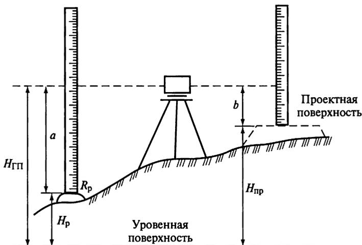
Рис. 15.4. Схема выноса в натуру проектной отметки
