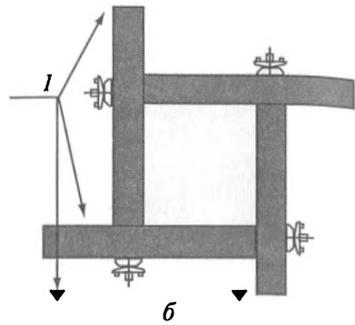
Рис. 20.25. Опалубка для колонн:
