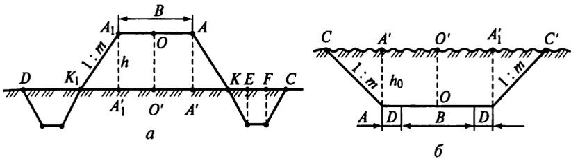
Рис. 25.12. Схемы разбивки дорожного полотна:
