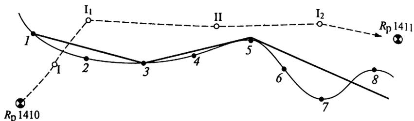
Рис. 26.1. Схема выноса в натуру проектной горизонтали контура водохранилища
