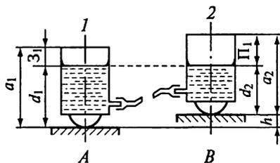
Рис. 22.7. Схема определения превышения при помощи гидростатической системы:
