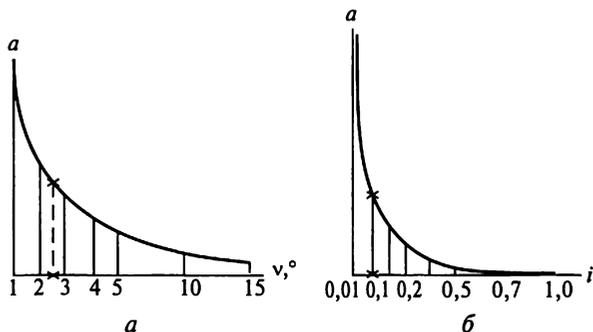
Рис. 4.7. Графики заложений к плану масштаба 1:1000 при высоте сечения рельефа  $h = 1,0$  м:
