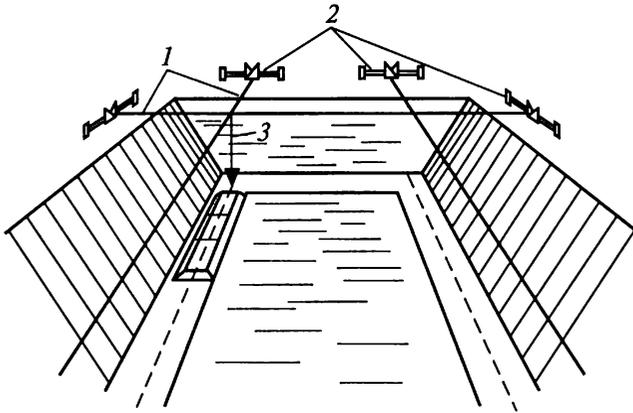
Рис. 20.8. Схема разбивки ленточных сборных фундаментов:
