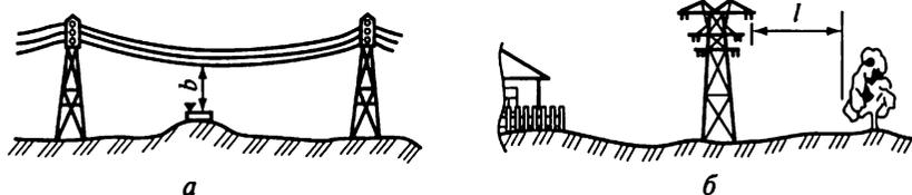
Рис. 29.1. Габаритные размеры приближения проводов:
