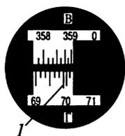
Рис. 8.6. Поле зрения отсчетного микроскопа теодолита 3Т30:
