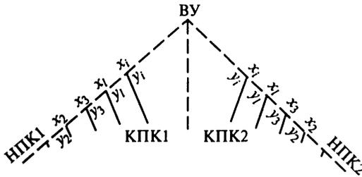
Рис. 25.8. Схема разбивки кривой способом прямоугольных координат
