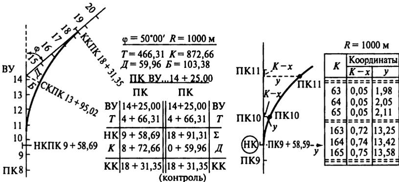
Рис. 25.4. Расчет пикетажа:
