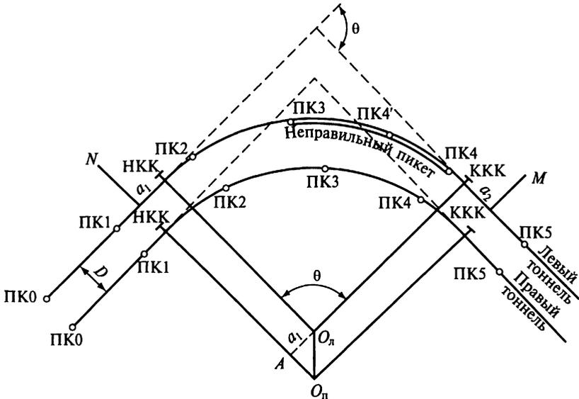
Рис. 27.4. Схемы расположения пунктов на кривых двухпутного тоннеля: ННК — начало круговой кривой; ККК — конец круговой кривой
