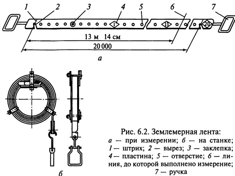
Рис. 6.2. Землемерная лента:
