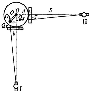
Рис. 24.7. Схема наблюдений за креном башенного сооружения способом вертикального проектирования
