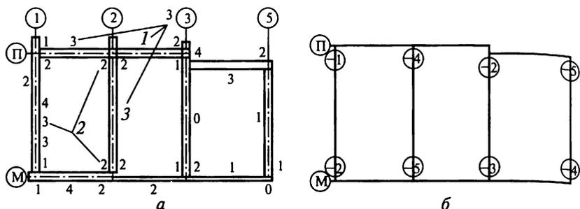
Рис. 20.17. Пример исполнительной съемки крупнопанельного здания: *а* — в плане; *б* — по высоте; *1* — отклонение опорных площадок до маяков; *2, 3* — смещение панелей соответственно в нижнем сечении и от вертикали
