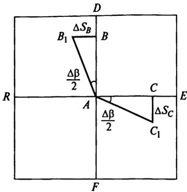
Рис. 13.6. Схема разбивки строительной сетки осевым способом
