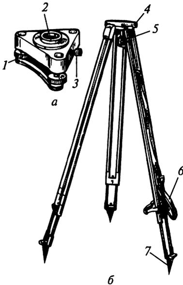
Рис. 7.4. Установка и крепление геодезических приборов:
