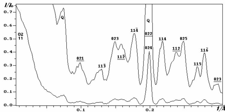
Рис. 16. Дифракционный спектр сканирования зоны 11L – 02L текстуры образца пелитовой фракции аргиллита с места аварии в скважине 12130 Сармановской площади. Рефлексы слюд: политипа 2M<sub>1</sub> (мусковита) и 1M – символы подчеркнуты; Q – кварц
