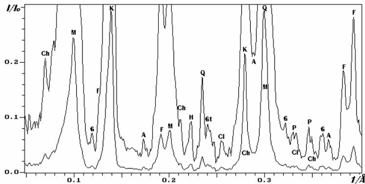
Рис. 15. Представленный в двух вертикальных масштабах дифракционный спектр пелитовой фракции аргиллита с места аварии в скважине 11797 Сармановской площади. Высокочувствительная съемка. Отражения: Ch – хлорит; М – слюда; К – каолинит; G – амфибол; P – пироксен; А – анальцит; Cl – клиноптилонит; Н – галлузит; Gt – гетит; F –  $\beta\text{FeOOH}$
