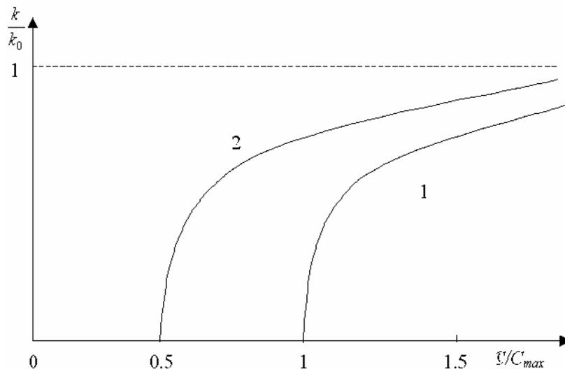
Рис. 20. Снижение относительной проницаемости коллектора, вызываемого электрокинетическим эффектом, от относительной концентрации. Кривая 1 – для плотности поверхностного заряда  $0.02 \text{ к/м}^2$ . Кривая 2 – для плотности поверхностного заряда  $0.05 \text{ к/м}^2$
