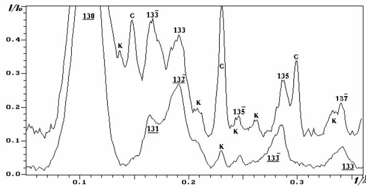
Рис. 17. Сравнение дифракционных спектров сканирования зоны 13L – 20L текстуры образцов пелитовой фракции: аргиллита с места аварии в скважине 12130 (нижний спектр) и пластичной глины из керна скважин 22245 Сармановской площади (верхний спектр). Рефлексы слюд: поли- типа  $2M_1$  (мусковита) и  $1M-1M_D$  – символы подчеркнуты. Q – кварц; K – каолинит; C – кальцит
