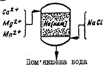
Рис. 6.1. Схема роботи Na-катіонітового фільтра
