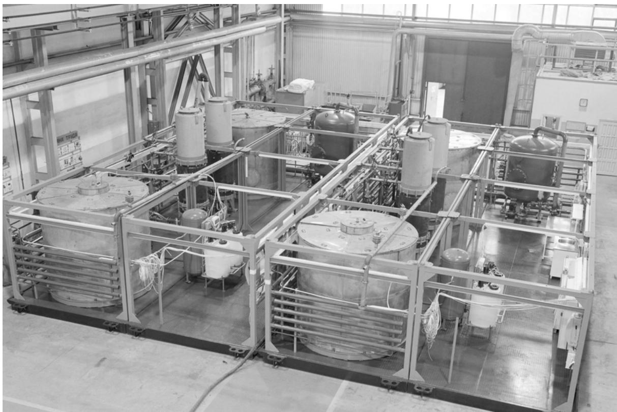
Рис. 1. 2-е станции "ВОДОПАД-200" в процессе изготовления в блочном исполнении на Экспериментальном заводе ООО "ТюменНИИгипрогаз" для Харасавейского ГКМ ООО "Надымгазпром".
