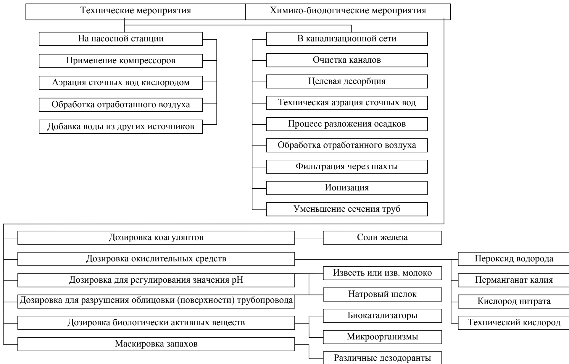
Рис. 4.10. Мероприятия, способствующие снижению концентрации газов в сетях водоотведения.
