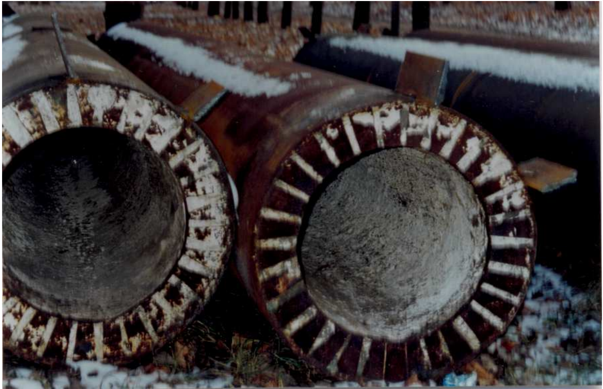
Рис. 6.17. Стальные трубы диаметром 600 мм, облицованные шлаковым литьем толщиной 90 мм (изготовлены на Никопольском заводе ферросплавов).
