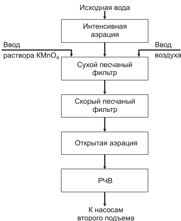
Рисунок 9.1 — Схема сооружений обезжелезивания, обезмарганцевания и деаммонизации воды
