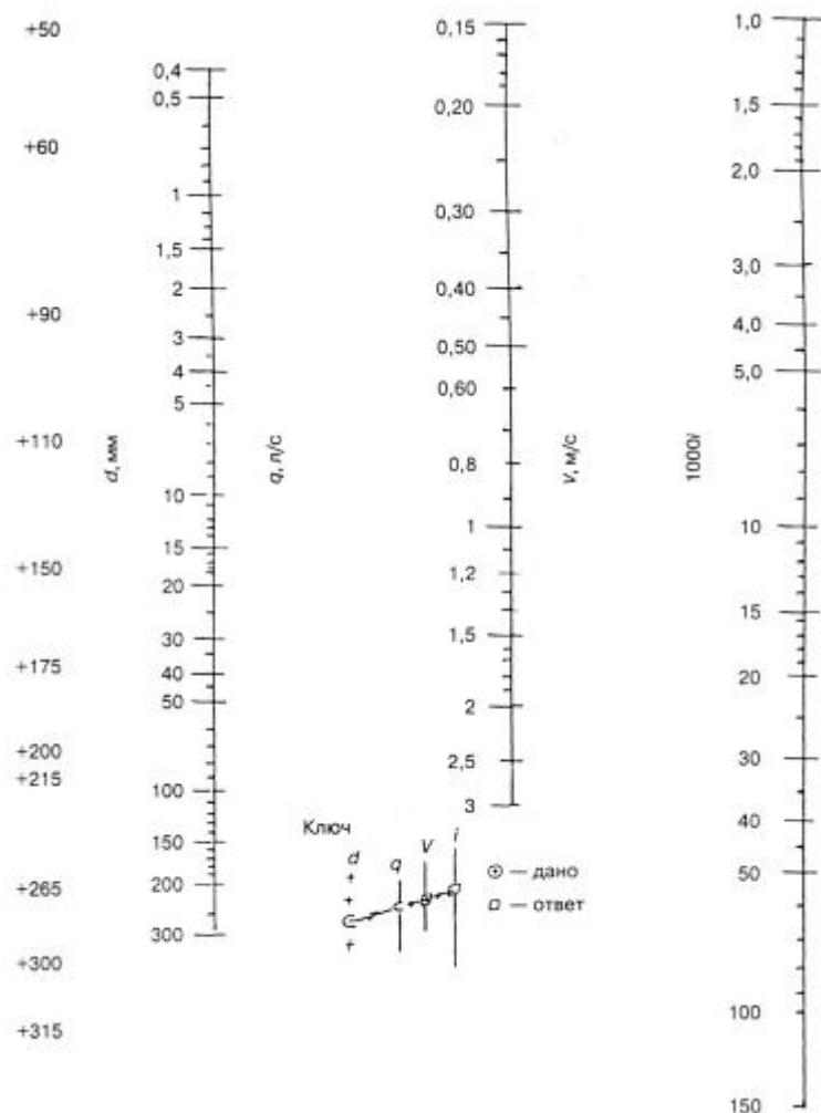
$d$  - расчетный диаметр,  $q$  - расчетный расход воды;  $V$  - средняя по сечению скорость движения воды;  $i$  - гидравлический уклон (потери напора на единицу длины трубопровода)
