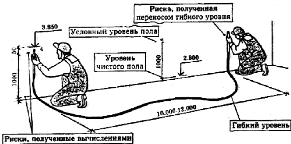
Рис.3. Закрепление высотных отметок гибким уровнем
