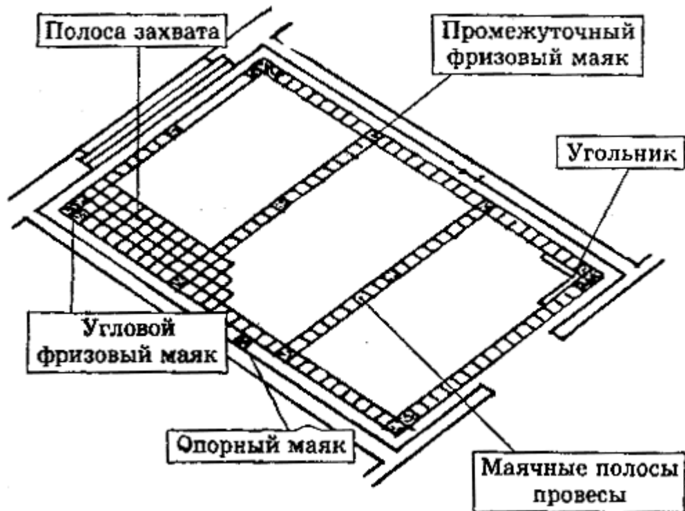
Рис.7. Размещение маяков и направление захватов
