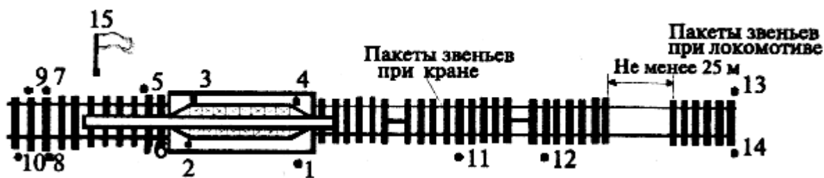
Рис.10. Схема расстановки рабочих при укладке звеньев путеукладчиком УК-25: 1 - место машиниста-водителя; 2 - место машиниста-оператора; 3 и 4 - место монтеров пути - стропальщиков; 5-14 - места монтеров пути нижней группы; 15 - место руководителя работ
