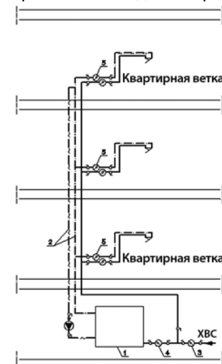
Рис. 9.1. Схема центральной системы ГВС многоквартирного жилого здания:
