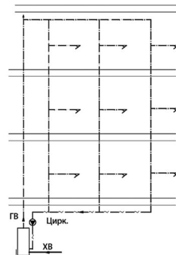
Рис. 7.2. Схема системы ГВС с циркуляцией – верхняя разводка
