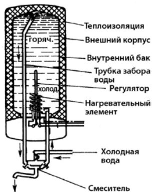
Рис. 10.5. Схема накопительного водоподогревателя [8]
