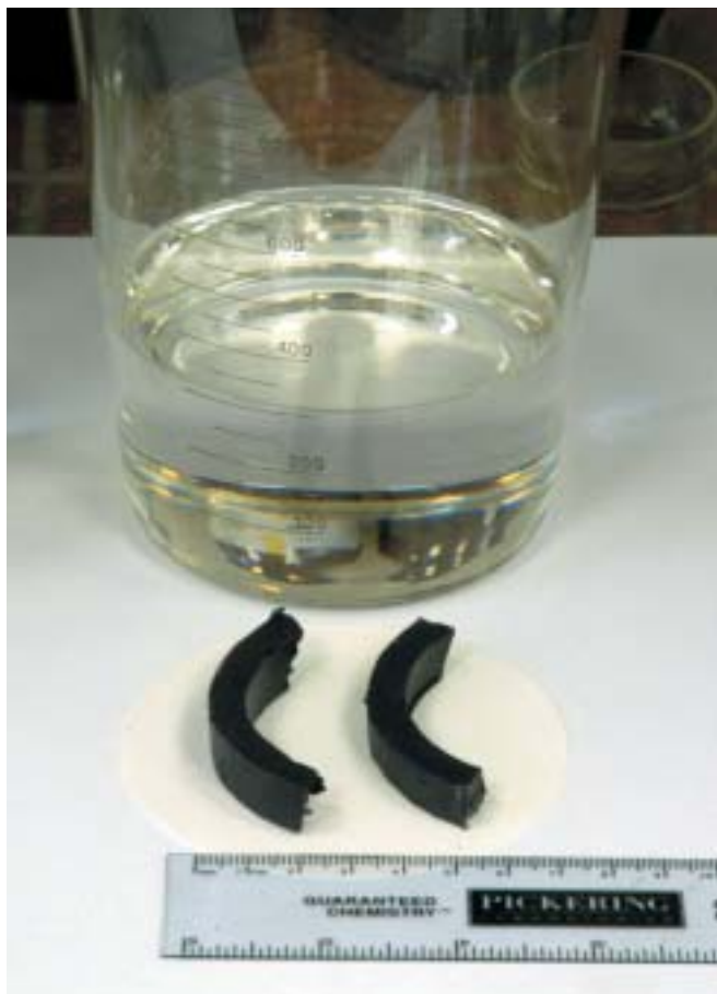
Изменение размеров резиновых уплотнителей (а, б) после 24 часов набухания в толуоле
