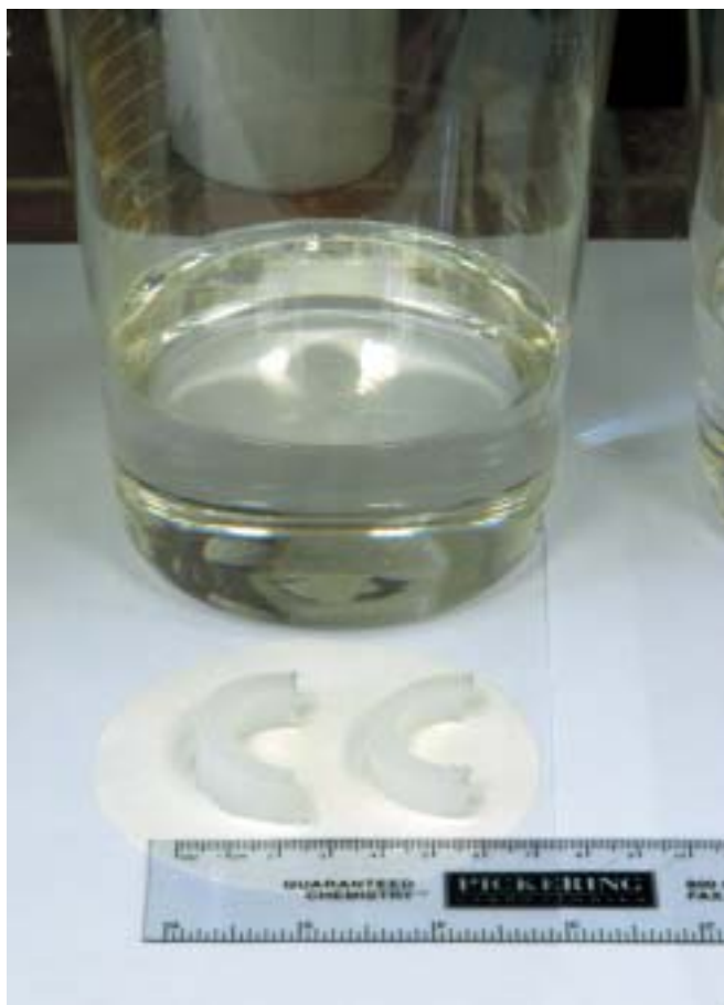
Изменение размеров резиновых уплотнителей (а, б) после 24 часов набухания в толуоле
