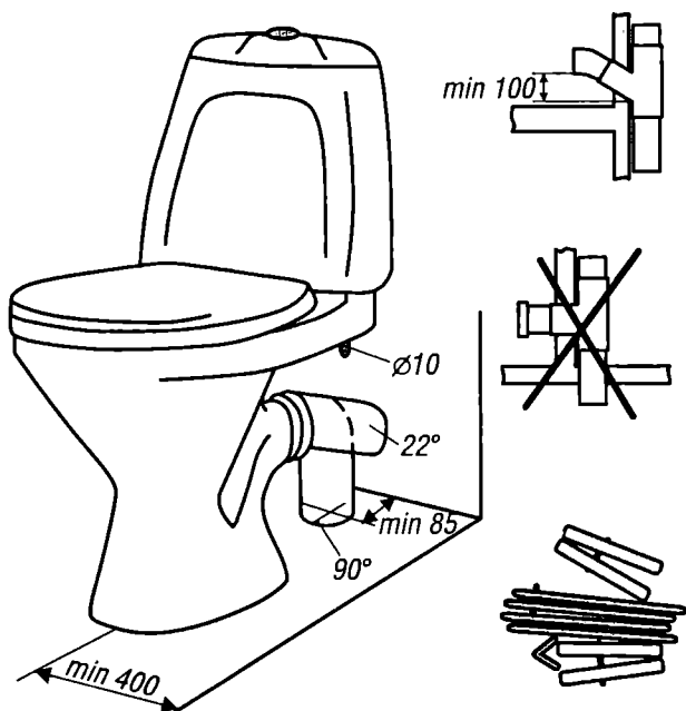
Рис. 12. Базовые размеры для установки унитаза
