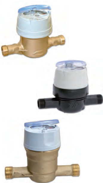
Compteur CEE/ISO classe C de type volumétrique à entraînement magnétique. Pré-équipé pour la communication
