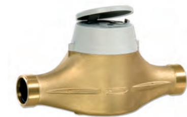
Compteur CEE/ISO classe C de type volumétrique à entraînement magnétique. Pré-équipé pour la communication.
