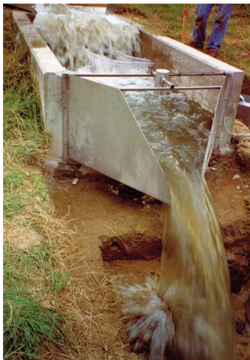
Fig. 56. 2-ft-H-flume near Mettmann/Germany (courtesy Umwelt-Geräte-Technik GmbH Müncheberg).
