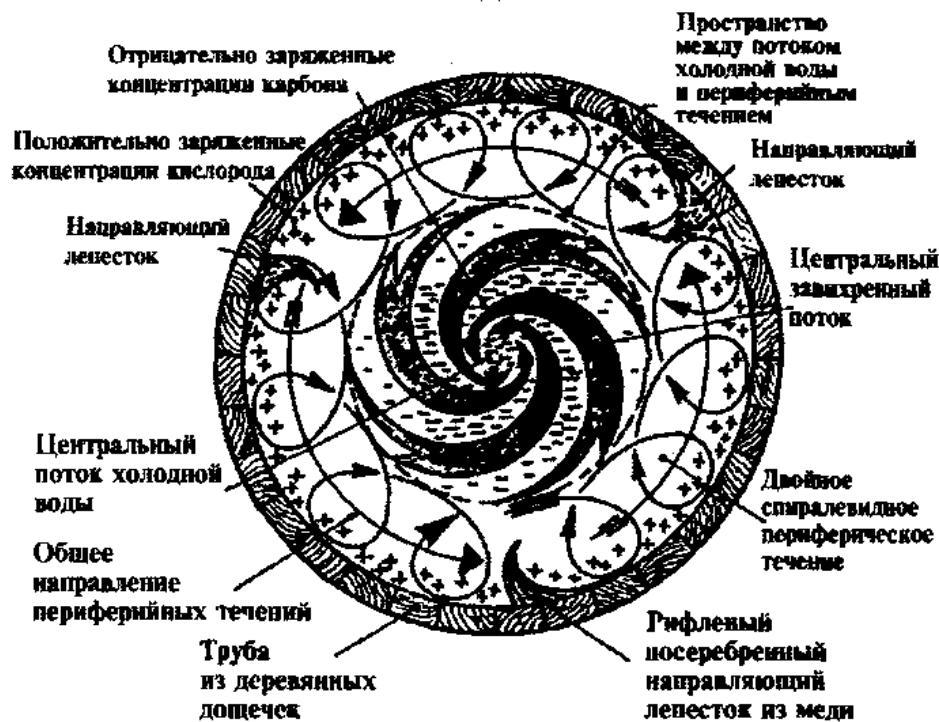
Рис. 16. Поперечный разрез трубы с двухпоточным спиралевидным течением 1
