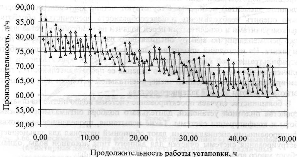
Рис. 3.64. Изменение производительности ультрафильтрационных мембран в процессе работы установки при продолжительности фильтроцикла и промывки соответственно 60 мин и 30 с
