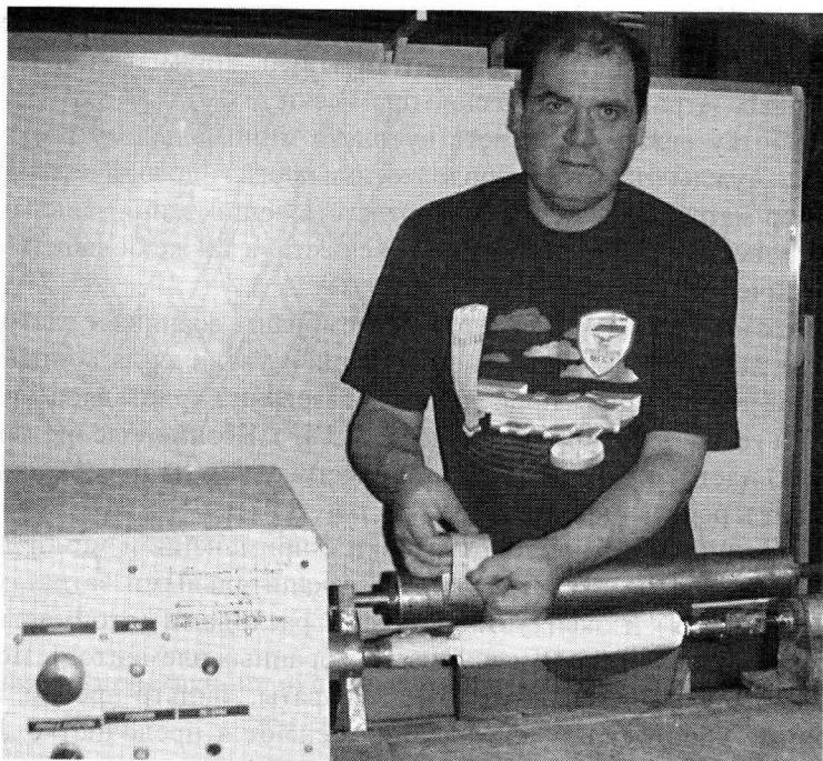
Рис. 3.58. Изготовление аппарата рулонной конструкции
