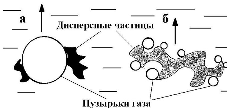
Рис. 8.20. Основные типы флотокомплексов: а — газовой-дисперсный, б — дисперсно-газовый
