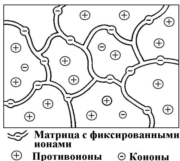
Рис. 8.17. Модель матрицы полиэлектролита (катионита) с фиксированными анионами и подвижными противоионами
