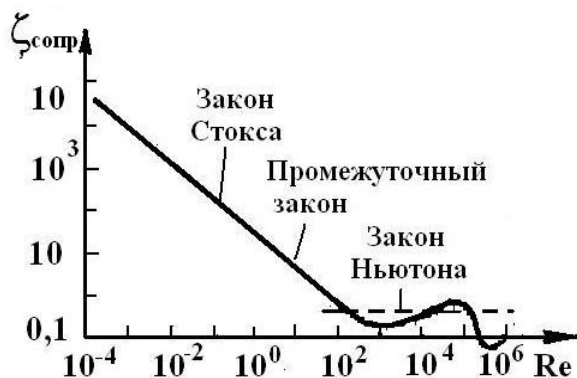
Рис. 3.1 Зависимость коэффициента сопротивления от числа Рейнольдса для трех режимов потока
