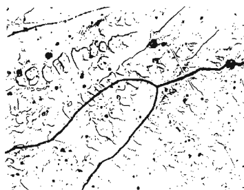
Рис. 13.6. Микроструктура зоны сплавления (линия 1 – 1) перлитной стали П с аустенитным швом А на участке ХТ типа «отрыв», проходящей преимущественно по аустенитной стали (а) и микроструктура центра аустенитного шва с четко выраженной границей зерна на фоне дендритной структуры (б). Увеличение 600 \times
