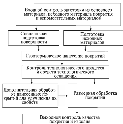
Рис. 15.8. Технологическая схема получения газотермических покрытий
