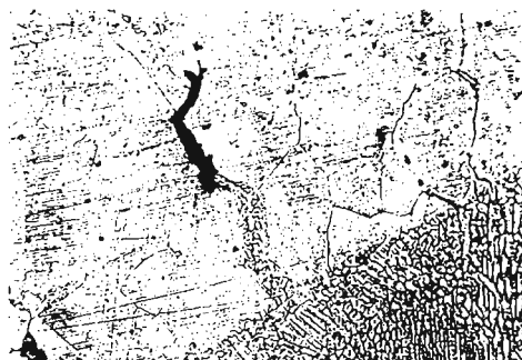
Рис. 10.29. ГТ по ликвационным прослойкам в ЗТВ при аргодуговой сварке сплава XH67BMTЮ толщиной 30 мм. Увеличение 200\times
