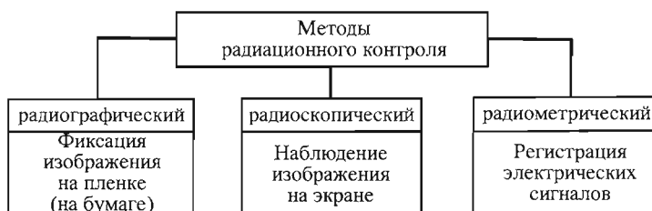
Рис. 16.20. Классификация методов радиационного контроля
