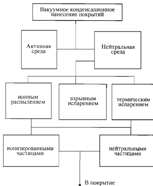
Рис. 15.7. Классификация методов и способов ВКН покрытий
