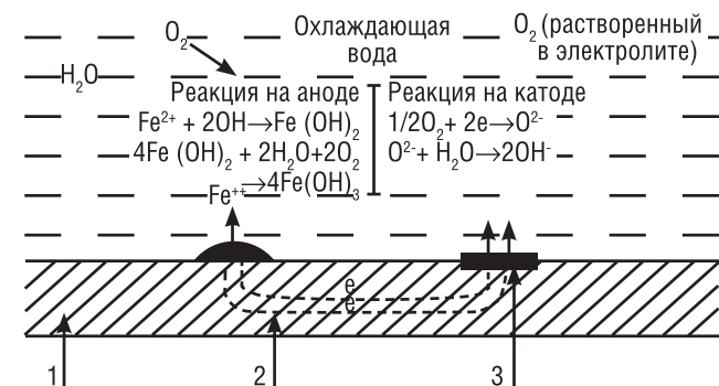
Рис. 1.24. Механизм электрохимической коррозии в системе «металл–воздух–вода»:
