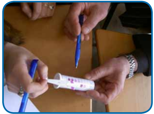
Индикация содержания нитратов в воде с помощью экспресс-теста на нитраты, Румыния © WECF, Мюнхен (Германия)/Margriet Samwel
