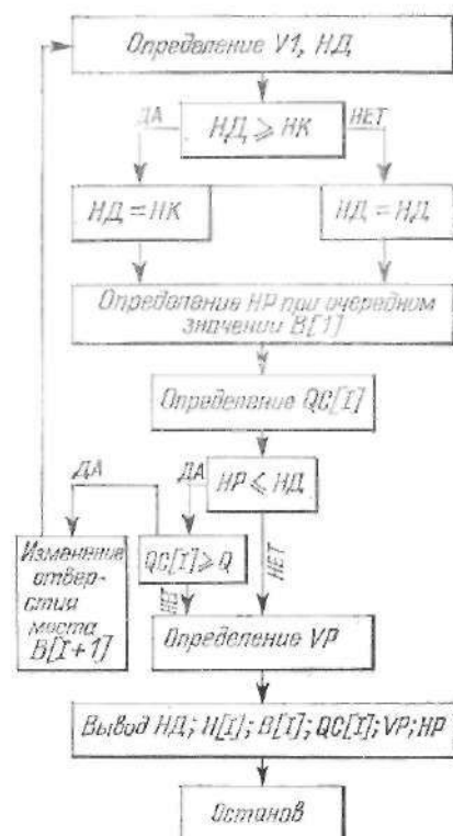
Рис. VI.15. Блок-схема расчета на ЭВМ отверстия малого моста с учетом аккумуляции
